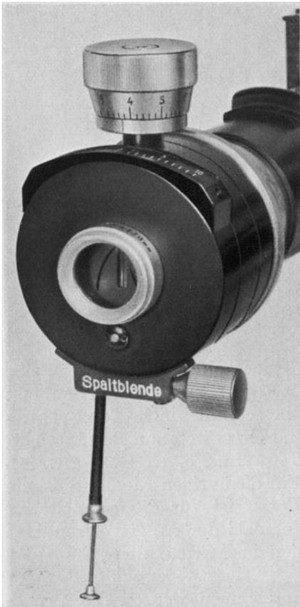
Abb. 24. Spaltkopf mit eingekapselter Stufen- und Keilblende (FUESS):
