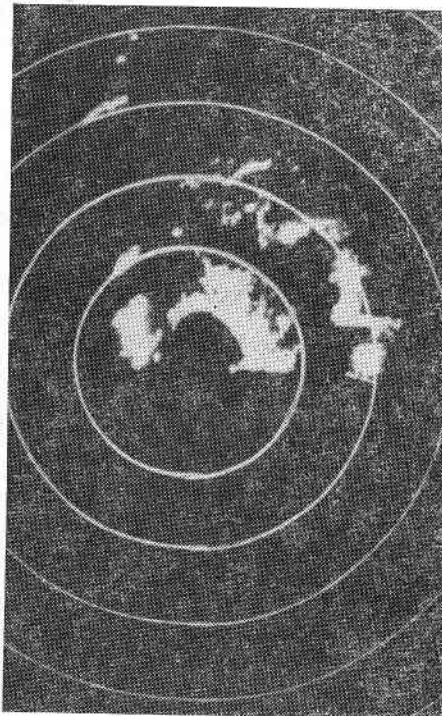
Рис. 1.8. Помехи за счет отражений от моря на экране ИКО РЛС при сверхрефракции
