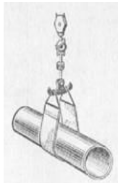
Рис. 11.20. Мягкое полотенец типа ПМ для подъема, перемещения и опускания изолированных труб Ду=500 - 1400 мм в каналы
