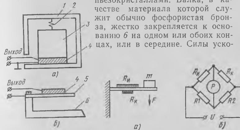
РИС. 8.7. Конструктивные схемы пьезоэлектрических акселерометров
