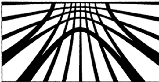
Рис. 10. Тест-объект Аббе для проверки «условия синусов»
