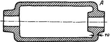
Abb. 124. Falsch. (Gefahr der Kernverlagerung!)
