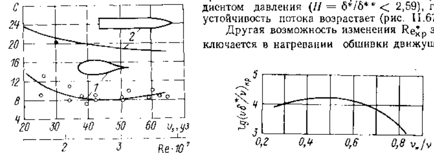
Рис. 11.67. Зависимость коэффициента сопротивления C = 2R/(\rho v^2 l^3 v^2) от скорости и числа Re (по данным Маккорника).
