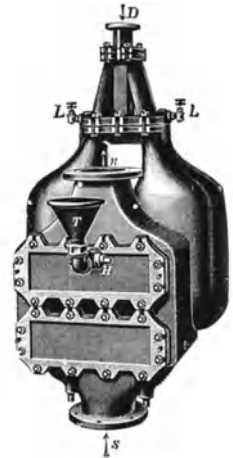
Abb. 230. Außenansicht des Pulsometers der Firma Körting.
