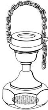
Abb. 13. LeitungsfILTER nach H. B. BEGER zum Befestigen an Wasserhähnen. Als Filterfläche dient Fließpapier. Etwa \frac{1}{2} natürlicher Größe. (Neuzeichnung.)
