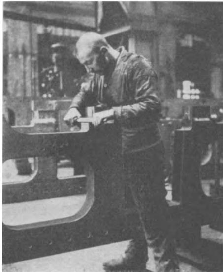
Abb. 33. Arbeitshaltung beim Befeilen des Barrenrahmen (Angriffspunkt in Ellenbogenhöhe).
