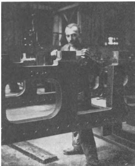
Abb. 30. Arbeitshaltung beim Befeilen des Barrenrahmen (Angriffspunkt in Schulterhöhe).
