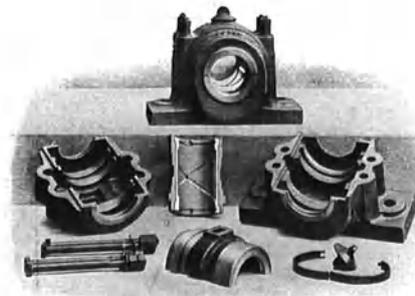
Abb. 44.19. Festes Stehlager (Bauart von Roll, Clus). Verbindungsschrauben durchgehend, da durch die höherliegende Trennfläche gehend.
