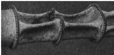
Abb. 18.4. Eingebeultes Flammrohr (aus Rötischer).
