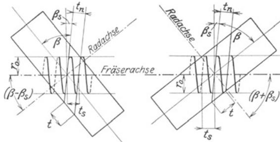
Abb. 20. Anstellung des Schneckenfräasers.
