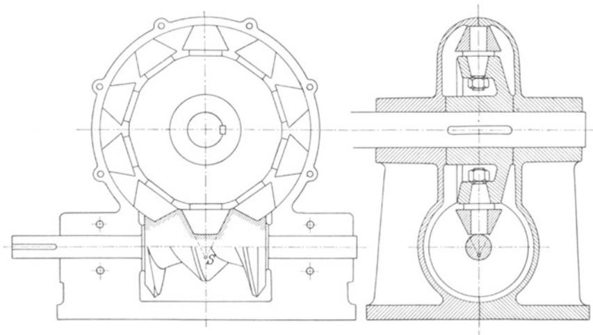
Abb. 173. Schneckengetriebe mit kegelförmigen Rollenzähnen.
