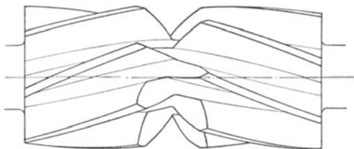
Abb. 35. Ritzel mit 7 Zähnen (neuere Ausführung hat Mittelnut und abgerundete Zahnnecken).
