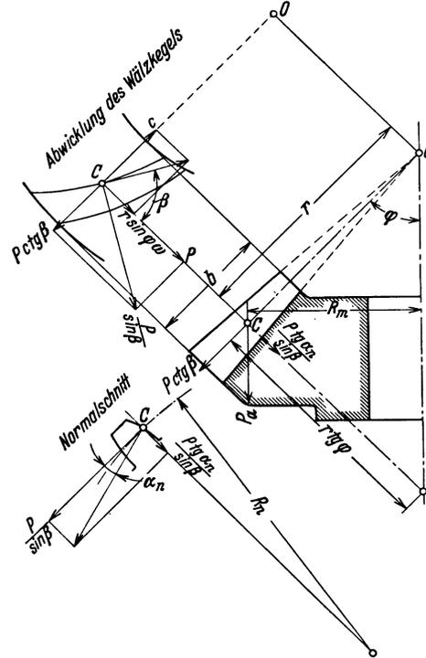
Abb. 50. Kräfteplan bei Schräg Zahnkegelrädern.
