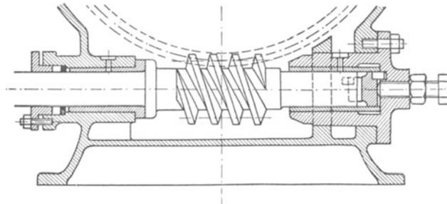
Abb. 148. Geeignet für kleinere Leistungen. Aufnahme des Achsdruckes (rechts) durch Spurlager. Bund (links) für unbelasteten Rücklauf. Hoher Ölstand, daher Stopfbüchse.
