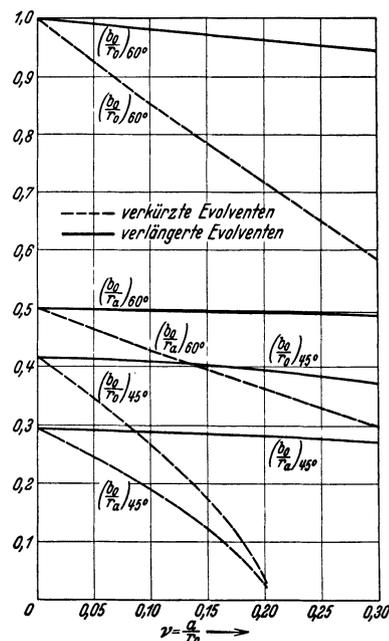
Abb. 69. Völligkeitsgrad  $\frac{b_0}{r_a}$  und Breitenverhältnis  $\frac{b_0}{r_0}$  für die größten Schrägungswinkel  $45^\circ$  und  $60^\circ$ .
