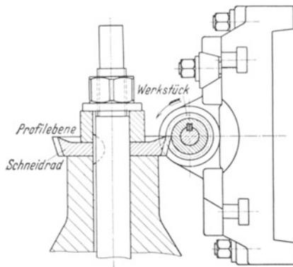
Abb. 134. Ausschneiden der Schnecke mit Schneidrad (für Massenanfertigung).
