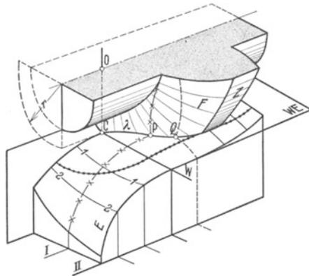
Abb. 103. Eingriffsfläche, schematisch. —  $OC$  = Kreuzungslinie,  $CW$  = Wälzachse,  $WE$  = Wälzebene,  $F$  = beliebige Flankenfläche,  $E$  = Eingriffsfläche rechte Hälfte. . . . . Grenze des Eingriffsfeldes (Schnitt von  $E$  mit  $Z$ ).
