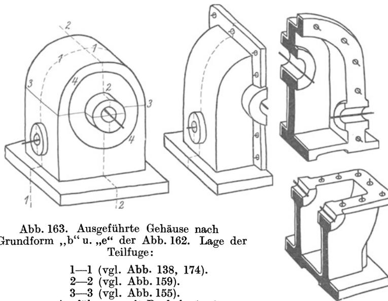
Abb. 163. Ausgeführte Gehäuse nach Grundform „b“ u. „e“ der Abb. 162. Lage der Teilfuge:
