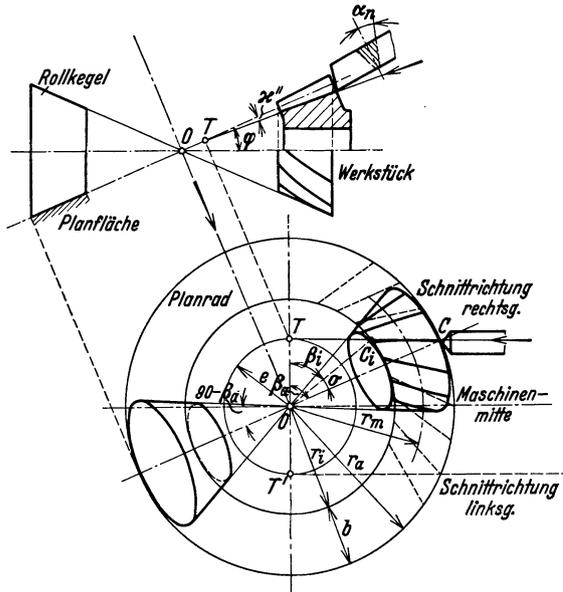
Abb. 57. Hobeln von Tangenzähnen. Bilgramhobelmaschine, J. E. Reinecker A.-G., Chemnitz. (Ersetze  $\kappa''$  durch  $F$  und  $\sigma$  durch  $\sigma_p$ .)
