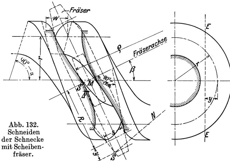
Abb. 132. Schneiden der Schnecke mit Scheibenfräser.
