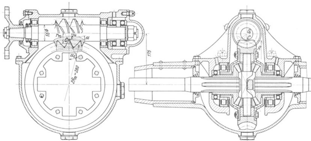
Abb. 172. Bostock-Renk Globoid-Schneckengetriebe. Antrieb einer Hinterachse. Ausführung der Zahnradfabrik Augsburg vorm. J. Renk.  $N = 19 PS$ ,  $n = 1000$ ,  $z_1/z_2 = 2/25$ ,  $\beta = 28^\circ$ ,  $\alpha_n = 14^\circ 30'$ . (Schneckenenden außen zylindrisch abgedreht, s. Seite 116.)
