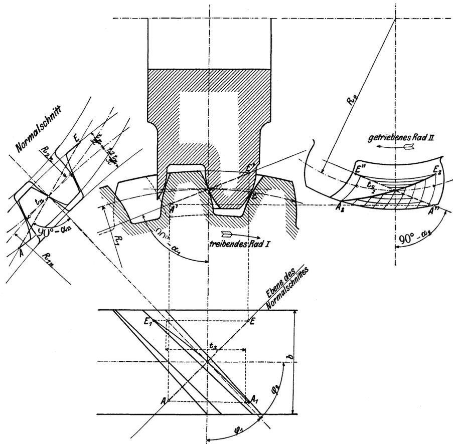
Abb. 82. Eingriffsbild der Schraubenträder. Ersetze  $t_s$  durch  $s$  (Sprung).
