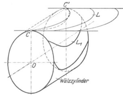
Abb. 1. Flankenlinien  $L$  und  $L_1$  von Zahnstange und Rad.
