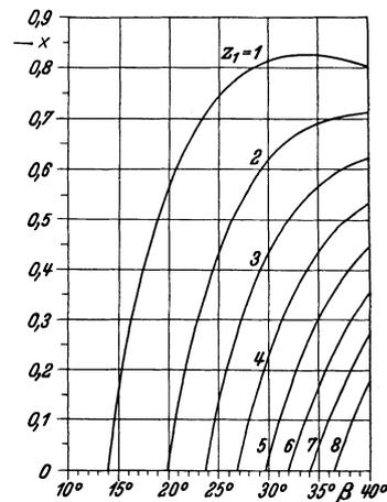
Abb. 129.  $x$ -Werte bei Evolventenschnecken,  $\alpha = 15^\circ$ .
