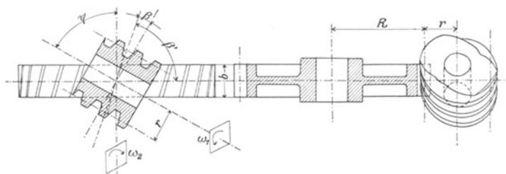
Abb. 88. Schneckentrieb für einen Kreuzungswinkel  $\psi$ .
