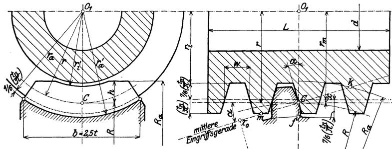
Abb. 144. Fünfgängige Schnecke.  $z_2 = 28$ . (Ersetze  $x$  durch  $x$  m.)
