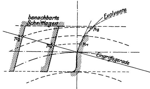
Abb. 136. Fräsen der Radzähne (flächiger Schnitt).
