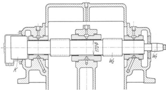
Abb. 45 b. Antriebswelle  $W_1$  ( $n = 7000$ ) geht durch die hohle Ritzelwelle  $W_2$  hindurch zur Zahnkupplung  $K$ . Von dort wird das Drehmoment auf die beiden Ritzel übertragen.
