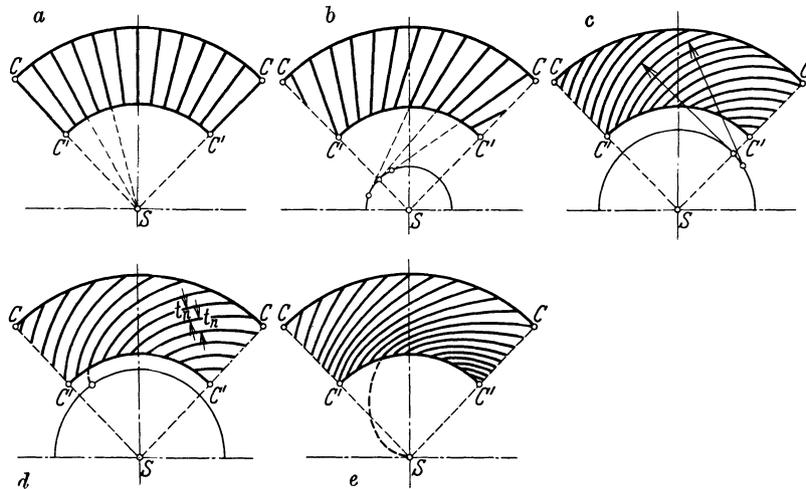
Abb. 49. Flankenlinien im Planrad für Kegelräder mit a) Geradzähnen, b) Tangenzenzähnen, c) Kreisbogenzähnen, d) Evolventenzähnen, e) Spiralzähnen.
