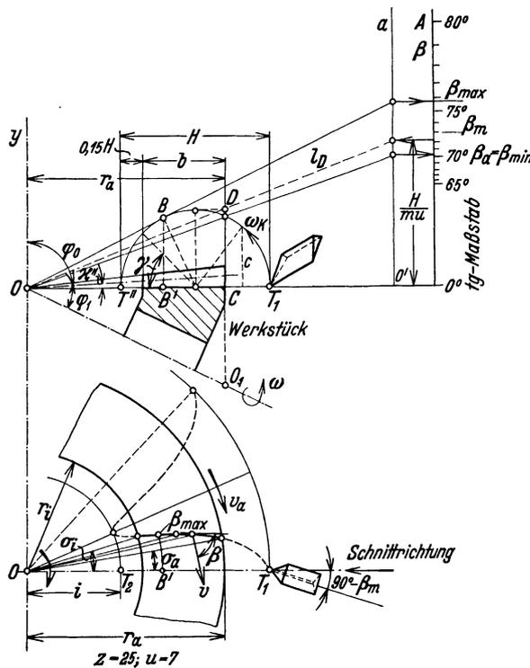
Abb. 55. Hobeln nach Episinoiden. (Ersetze nach DIN 869  $\kappa''$  durch Zahnfußwinkel  $F$ ).
