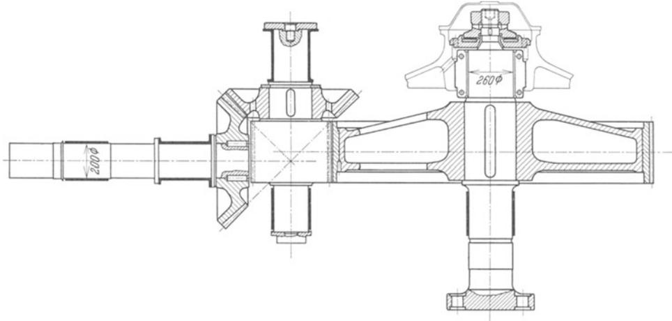
Abb. 47. Kegelrad-Stirnradgetriebe zwischen Dieselmotor und Kreiselpumpe.  $N = 630$  PS,  $n = 167/40$ .
