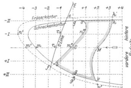
Abb. 104—113. Zweigängige Schnecke.  $\beta_m = 18^\circ 40'$ ,  $z_2 = 14$ .
