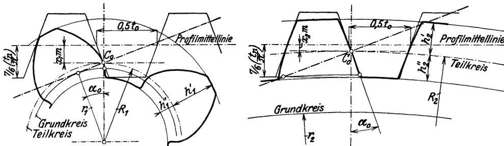
Abb. 15. Zahnprofile im Stirnschnitt.
