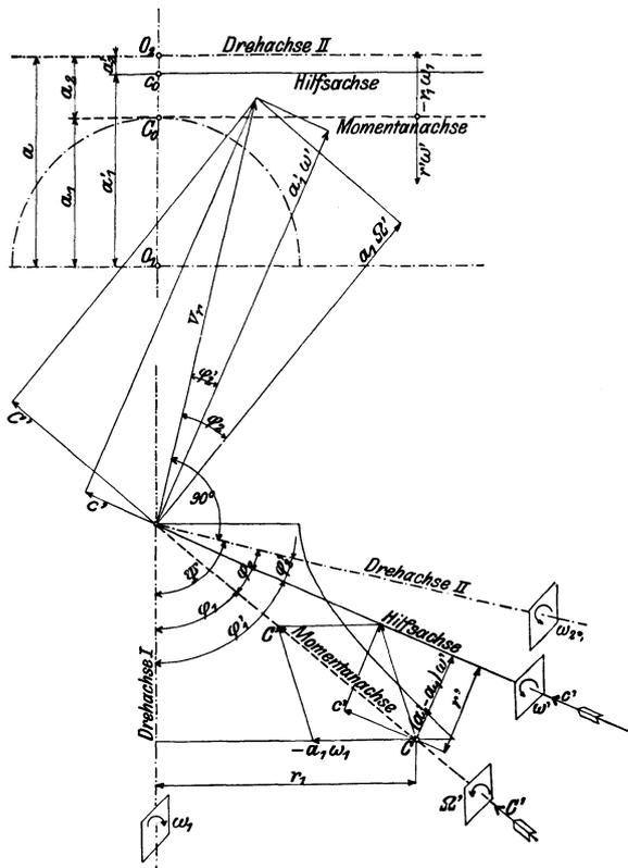
Abb. 74. Zykloidenverzahnung bei Hyperboloidrädern.
