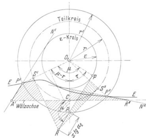
Abb. 121. Ermittlung der Eingriffspunkte der Evolventenschnecke (statt  $A'$  setze  $R'$ ).
