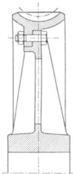
Abb. 147. Radkörper Gußeisen, Bronzekranz mit Flansch. Berechnung der Schrauben wie bei Scheibenkupplungen.
