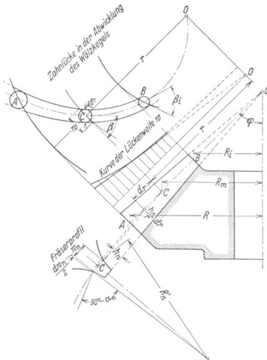
Abb. 53. Zahnückenverlauf beim Ausschneiden mit Fingerfräser.
