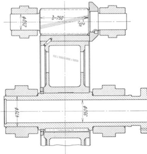
Abb. 46. Ring auf der rechten Ritzelseite dient zur Aufnahme des Axialschubes. Den Schub des Rades gegen die Radwelle nimmt ein zweiseitiger Ring auf, über den ein Schrumpfring geschoben wird.
