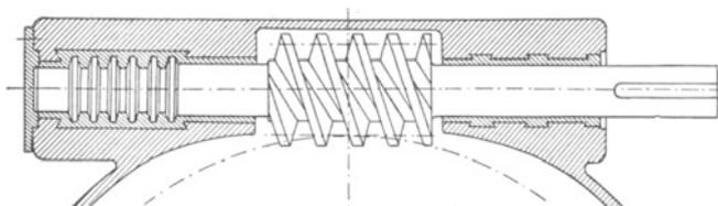
Abb. 149. Oben liegende Schnecke. Aufnahme des Achsdruckes durch Kammlager.
