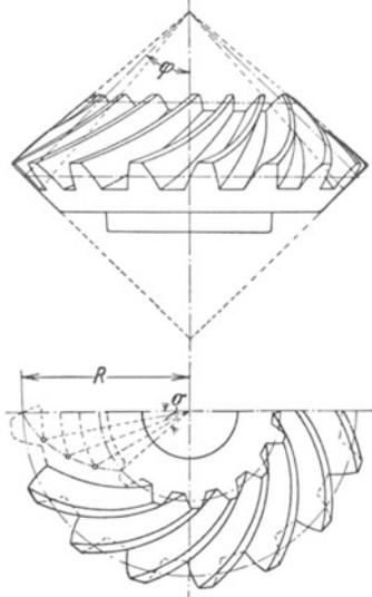
Abb. 51. Spiralkegelrad.
