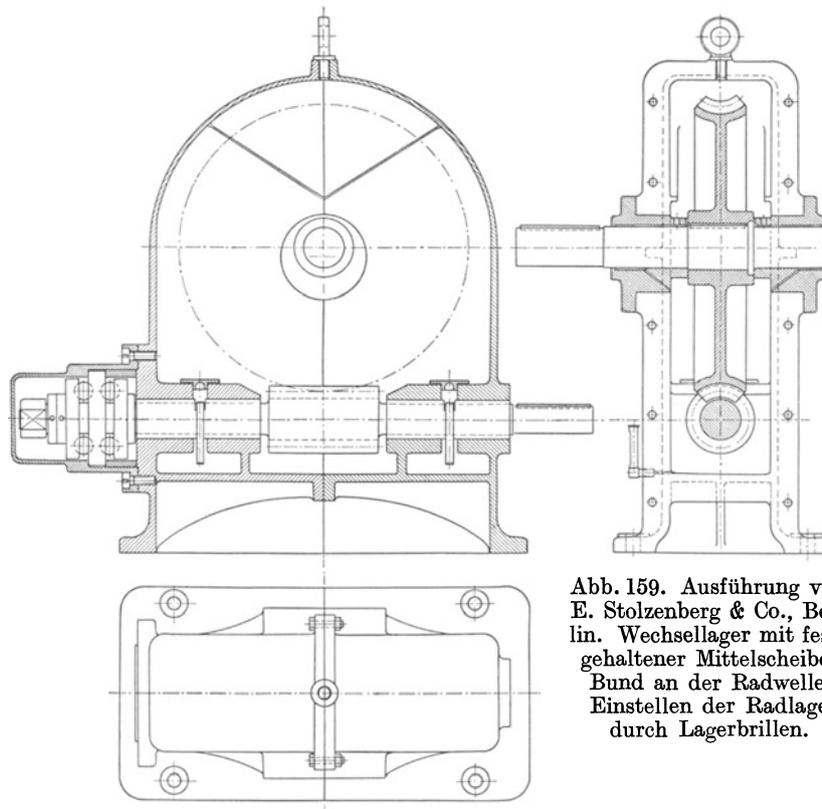
Abb. 159. Ausführung von E. Stolzenberg & Co., Berlin. Wechsellager mit festgehaltener Mittelscheibe. Bund an der Radwelle. Einstellen der Radlage durch Lagerbrillen.
