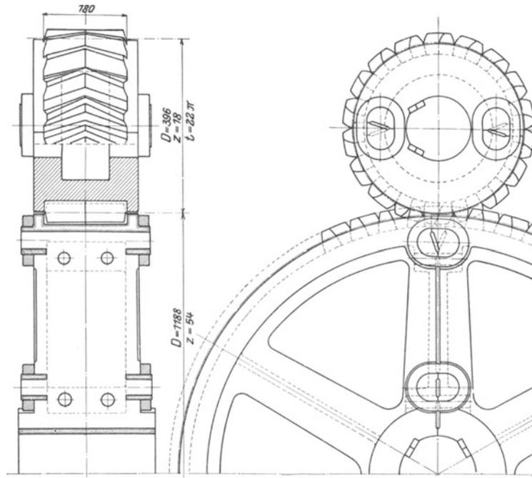
Abb. 23. Räder geteilt (nach dem Guß gesprengt). Schrumpfringe.
