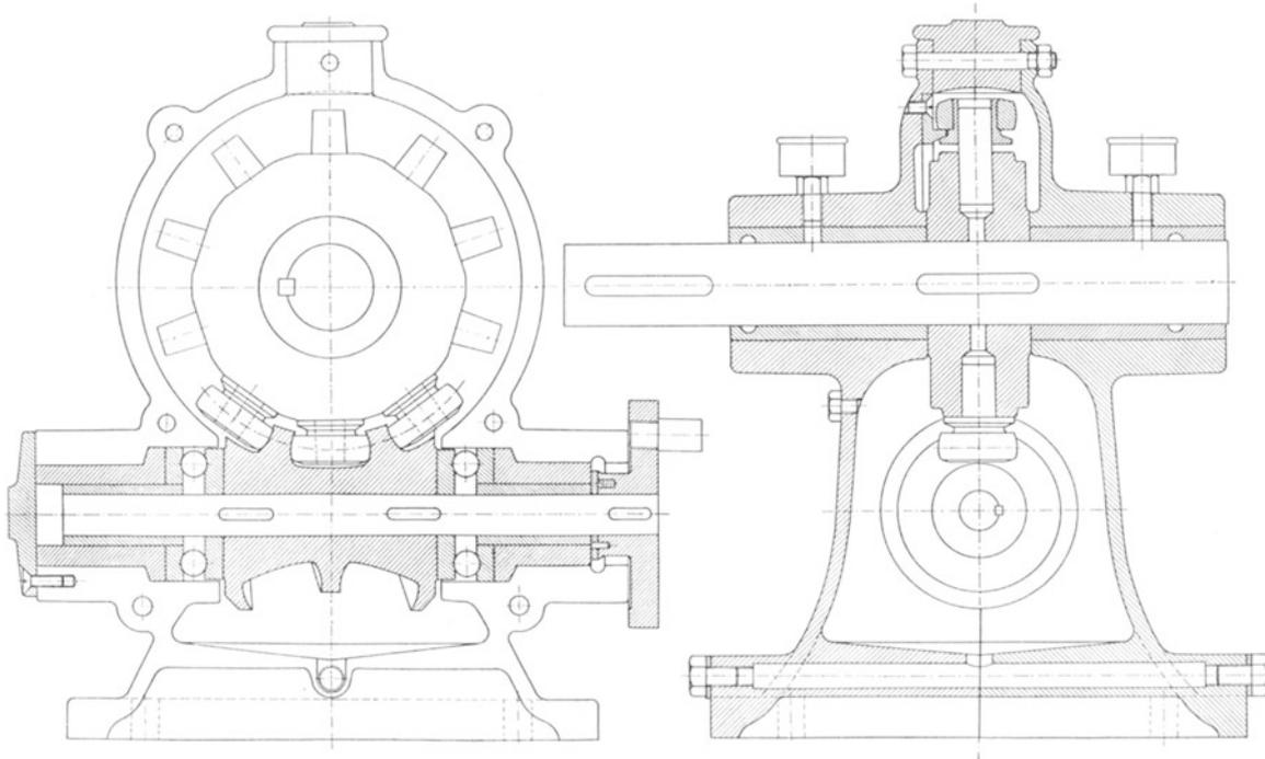
Abb. 174. Schneckengetriebe mit kugelförmigen Rollenzähnen.
