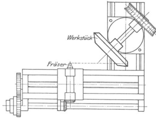
Abb. 52. Kegelradbearbeitung mit Fingerfräser.
