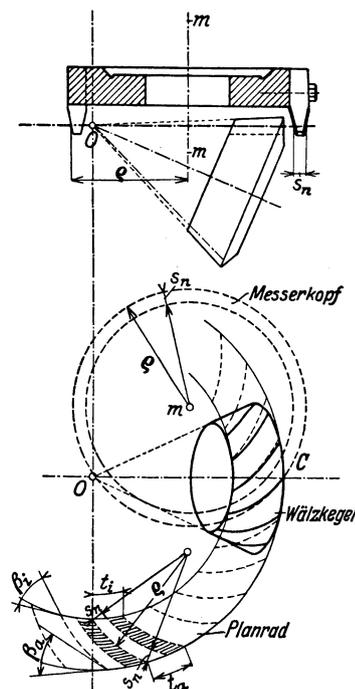
Abb. 61. Fräser von Kreisbogenzähnen (Wälzverfahren).
