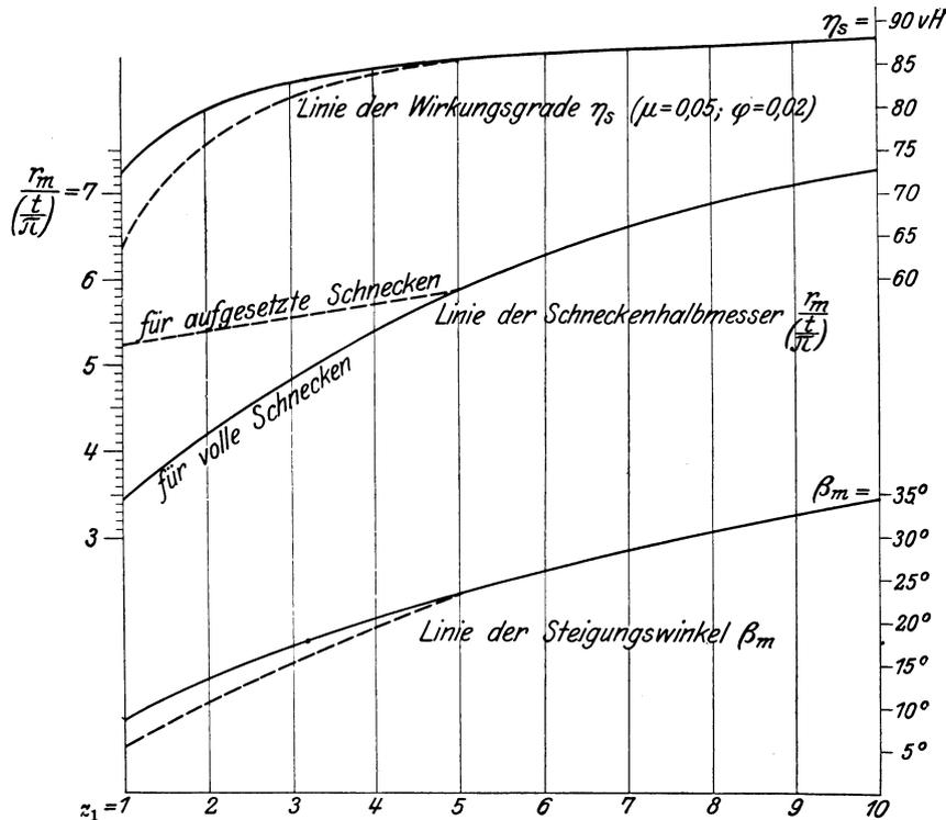
Abb. 145. Ausführungsgrößen der Schnecke.
