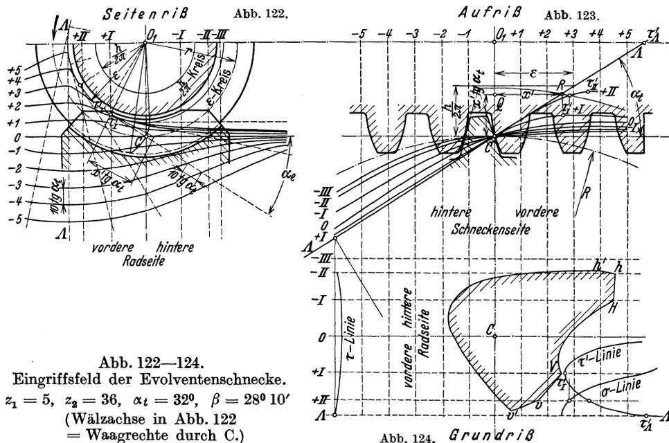
Die Maximapunkte  $\tau'$  werden im Aufriß durch Hinüberloten der Schnittpunkte, z. B.  $\tau'_I$  (Abb. 122), der Seitenrißspuren  $0, +I, +II, \dots$  mit dem  $\varepsilon$ -Kreise gefunden. Die axiale Entfernung  $x'$  des Punktes  $\tau'_I$  im Aufriß von der Kreuzungslinie ergibt sich aus dem rechtwinkligen Dreiecke  $CQR$ , das über der  $\Lambda$ -Linie errichtet wird und dessen Kathete  $CQ$  gleich dem Tangentenabschnitt des Kreuzrisses  $x' \operatorname{tg} \alpha_t$  gemacht wird.
