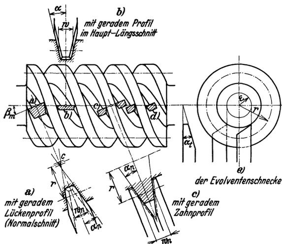
Abb. 131. Ausdrehen der reinen (b und d) und der angenäherten Spiralschnecke (a und c) und der Evolventenschnecke (e).
