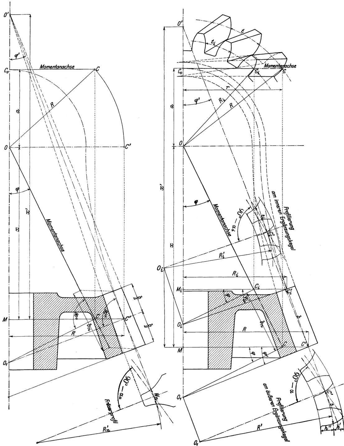
Abb. 76. Abb. 75 und 76. Angenäherte Verzahnung. Abb. 75.
