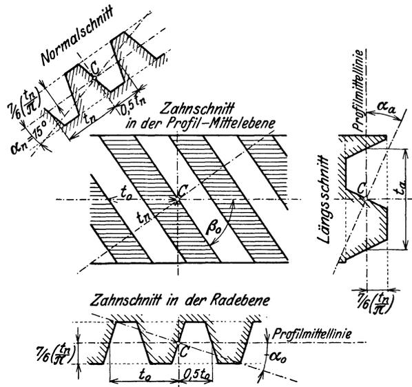
Abb. 8. Bezug Zahnstange der Schraubenzähne ( $\alpha_n = 15^\circ$ , nach DIN :  $20^\circ$ ).
