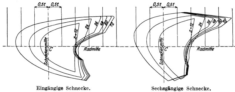
Abb. 146. Feldgrundrisse bei verschiedenen Übersetzungen.
