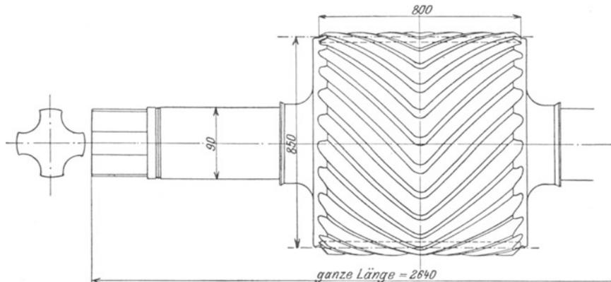
Abb. 29. Kammwalze, Siemens-Martinstahl  $z = 25$ ,  $t = 34\pi$ .
