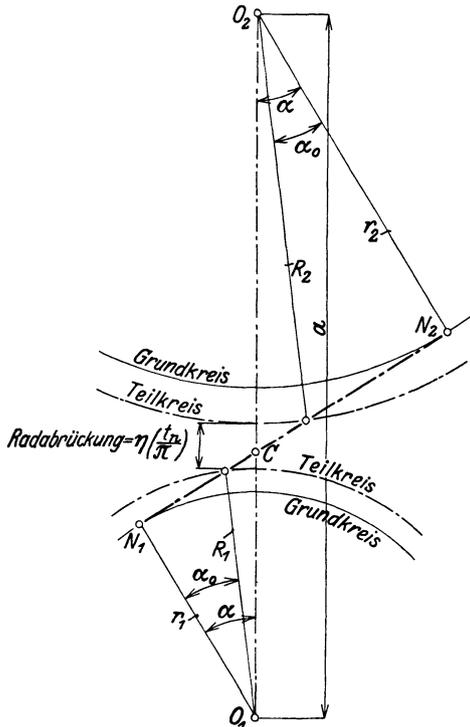
Abb. 13. Radabrückung bei Sonderverzahnung.
