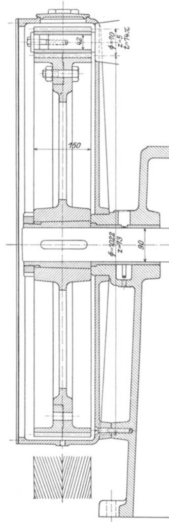
Abb. 38. Stirnschneckengetriebe.  $\beta \approx 20^\circ$ . Ritzel aufgesetzt; Radkranz geteilt, Nabe auf konischer Büchse.
