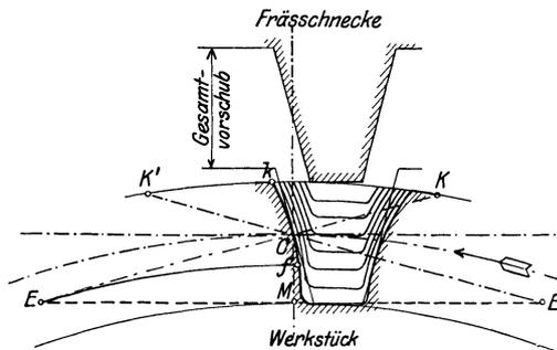
Abb. 137. Fräsen der Radzähne bei radialem Vorschub.
