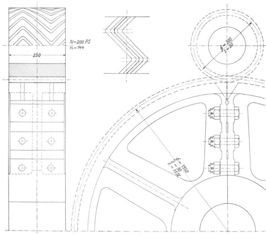
Abb. 41. Räder mit Doppelwinkelzähnen für wechselnde Drehrichtung.  $P = 55 b t$ . Ritzel geschmiedet, Rad aus Stahlguß.
