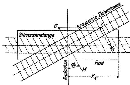
Abb. 81. Planverzahnung der Schraubenstirnrader.
