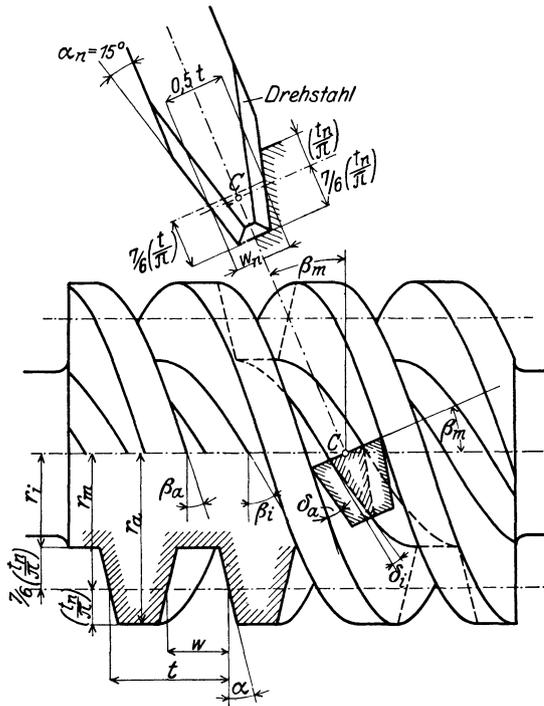
Abb. 130. Ausdrehen der Schnecke mit profiliertem Schneidestahl.
