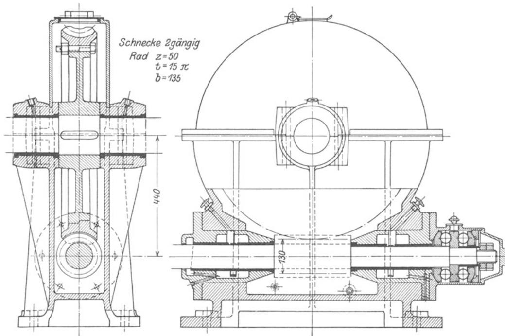
Abb. 155.  $N$  (Dauerbetrieb) = 40 PS,  $n = 510$ . — Zahnräderfabrik Augsburg, vorm. J. Renk. Aufgeschobener Radkranz mit Paßschrauben. Zweireihiges Wechsellaager. Getrennte Schmierung.
