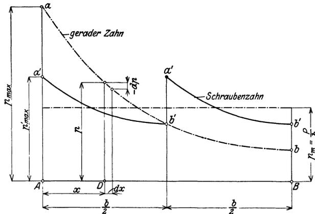
Abb. 42. Angenäherter Verlauf der Zahndruckverteilung.
