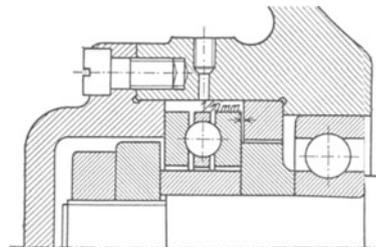
Abb. 150. Querkugellager und einreihiges Längskugellager für wechselnden Druck (Wechselager).
