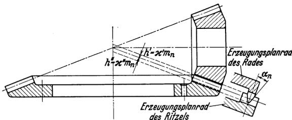
Abb. 62. Tellerrad mit Kreisbogenzähnen. Hinterachsenantrieb (Ersetze  $x'$  u.  $x''$  durch  $y'$  u.  $y''$ .)
