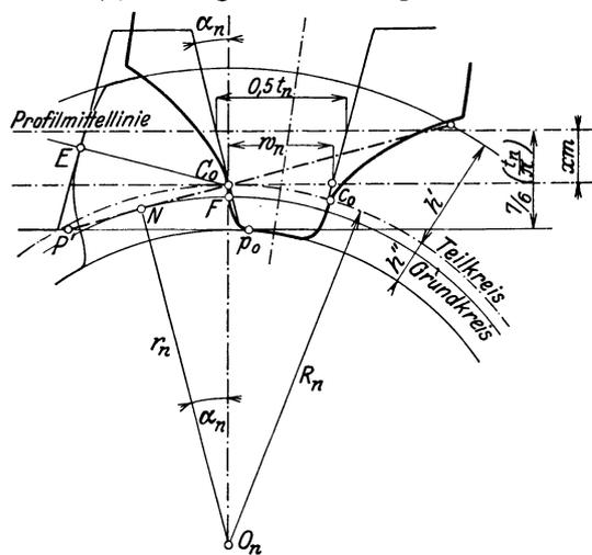
Abb. 10. Ermittlung des Formfräserprofils aus dem Normalschnitt (Verzahnung nach Abb. 9).
