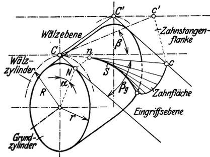
Abb. 4. Zahnstange mit gerader Flankenlinie  $Cc'$ ; Schraubenzahnfläche des Zahnes.
