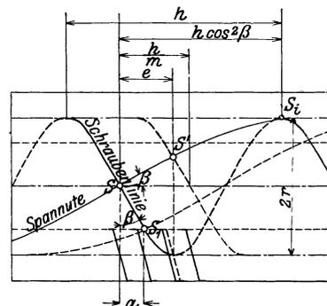
Abb. 138. Anordnung der Spannuten.
