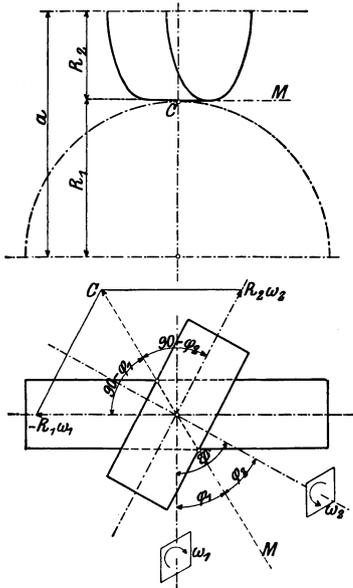
Abb. 78. Schraubstirnräder.
