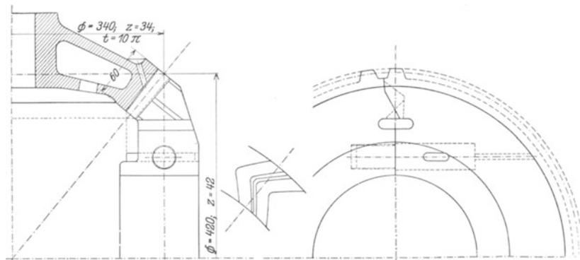
Abb. 40 b. Geteiltes Kegelrad. Teilfuge in der Mitte und an den Enden abgeflacht.
