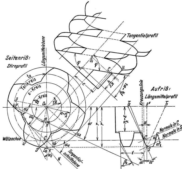
Abb. 120. Viergängige Evolventenschnecke,  $\alpha_n = 20^\circ$ ,  $\beta = 23^\circ 55'$ .
