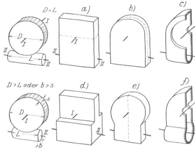
Abb. 162<sup>1</sup>. Gehäuseformen (Formenreihe) für „Welle I und II waagrecht, Schnecke unten“.
