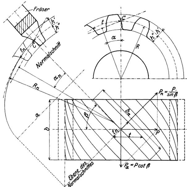
Abb. 7. Form und Maße des Schraubenzahnes.
