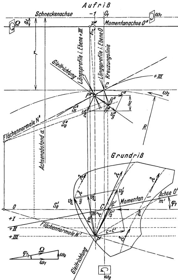
Abb. 126. Gleitgeschwindigkeit und Flankenanschmiegung. (Evolventenschnecke  $z_1 = 6$ ,  $z_2 = 36$ ,  $\alpha_t = 30^\circ$ ,  $\beta = 26^\circ 34'$ .)
