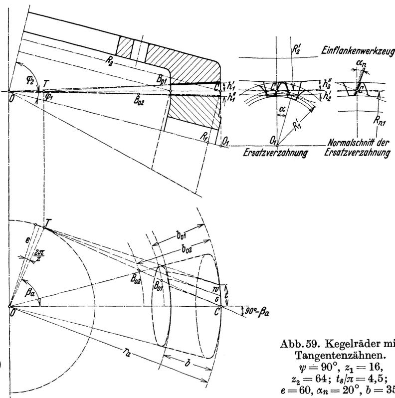
Abb. 59. Kegelräder mit Tangenzähnen.
