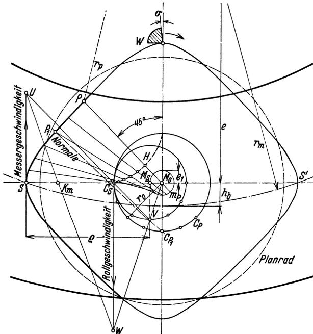
Abb. 64. Zyklische Pfeilverzahnung. Ermittlung des Krümmungsmittelpunktes  $K_m$  für  $S$ : Mache  $SU = SC_s$ , ziehe  $UC_sV$ , Tangente an  $C_s$  u.  $M_0VW$ . Gerade  $WU$  schneidet
