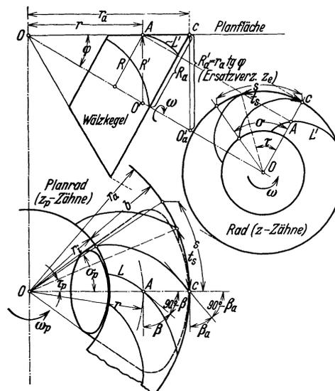
Abb. 48b. Verlauf der Flankenlinien in den Wälzflächen von Plan- und Kegelrad.
