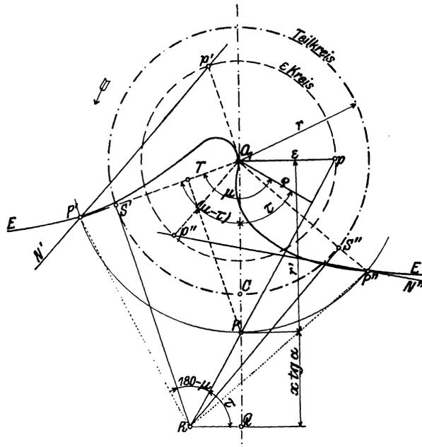
Abb. 97. Ermittlung der Eingriffspunkte der Spiralschnecke.
