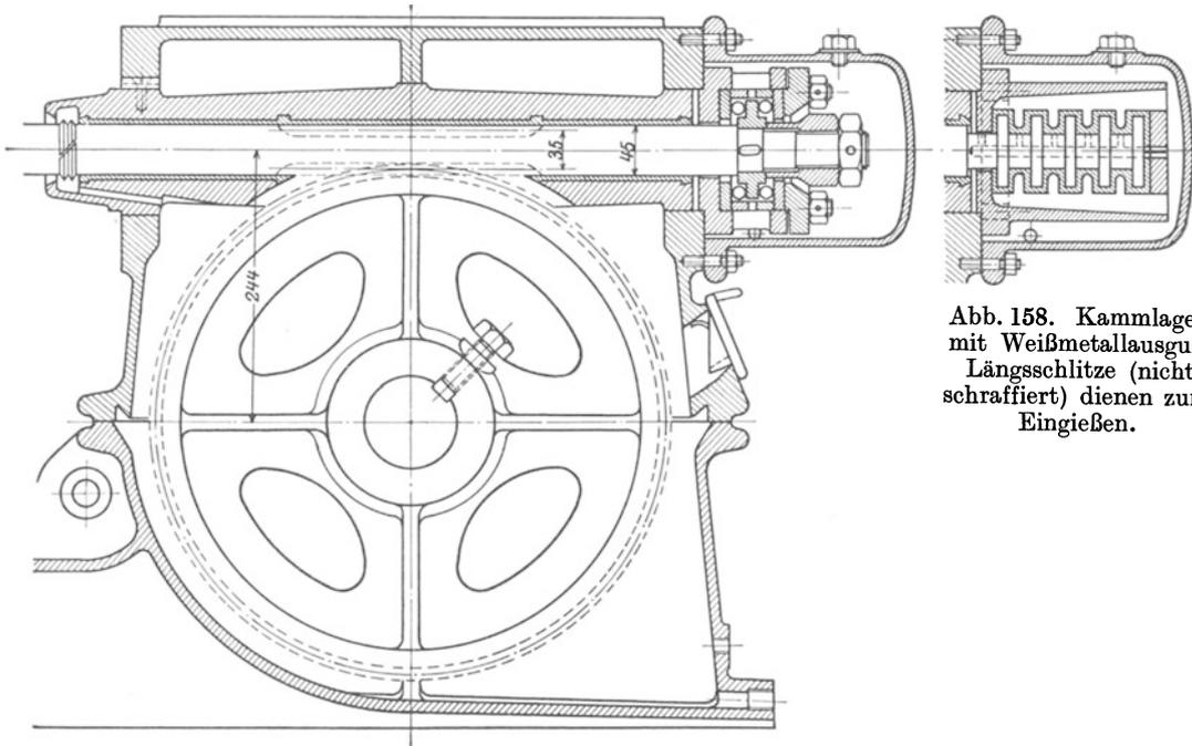
Abb. 158. Kammlager mit Weißmetallausguß. Längsschlitz (nicht schraffiert) dienen zum Eingießen.
