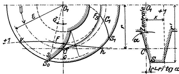
Abb. 96. Stirnprofil der Spiralschneckenfläche.  $O_1 C$  = Kreuzungslinie. Unterscheide  $\delta$  in Abb. 96 von  $\delta$  in Abb. 94 u. Gl. 59.
