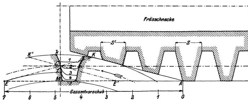
Abb. 139. Fräsen der Radzähne bei axialem Vorschub.
