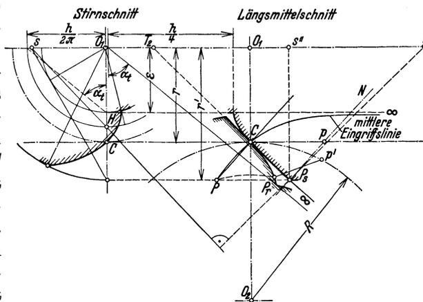
Abb. 125. Ermittlung des Radzahnprofils beim Evolventenschneckentrieb. (Verhältnis  $R:r$  übertrieben.)
