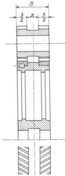
Abb. 26. Kränze mit Mittelnut für Fräserauslauf.
