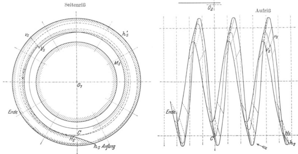
Abb. 102. Eingreifende Schneckenfläche.
