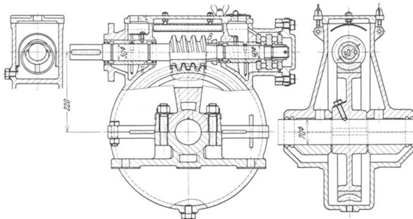
Abb. 154. Kranz (Ph.-Bronze) aufgeschumpft, Schnecke aufgepaßt, mit Feder. Längshalt durch zweiteiligs Buchse B, durch Ring zusammengehalten. Schmierung beachten. (Maschinenfabrik Oerlikon.)
