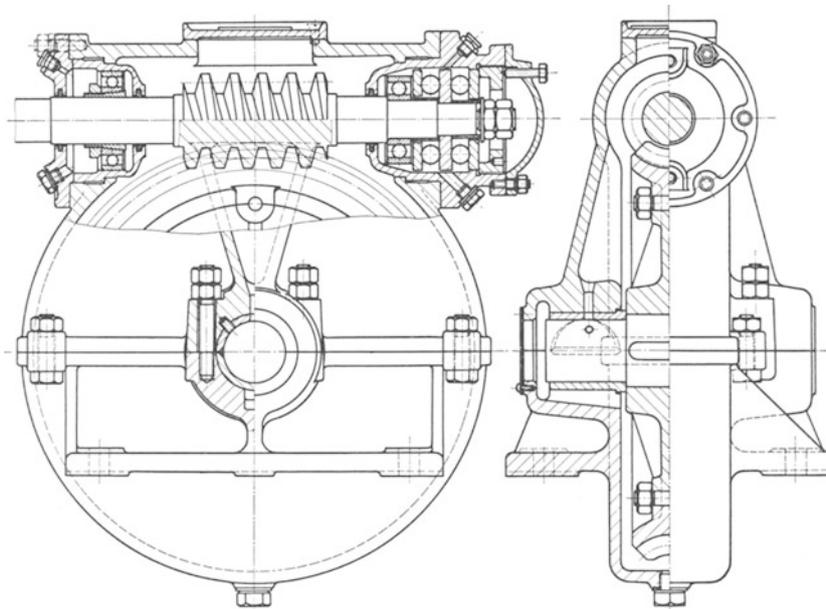
Abb. 153. Radkranz mit Paßschrauben. Zweireihiges Wechsellager in besonderem Gehäuse. Linkes Querlager mit Spannhülse, freie Ausdehnung der Schneckenwelle. (El. A. G. vorm. Kolben & Co., Prag.)
