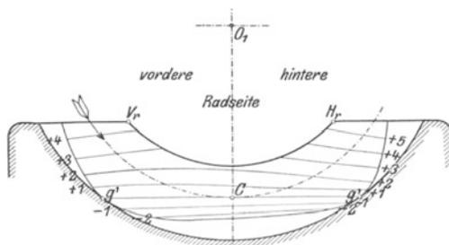
Abb. 135. Frässhnecke und Radzahn.
