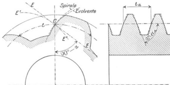
Abb. 36. Ausdrehen von Schraubenzähnen.
