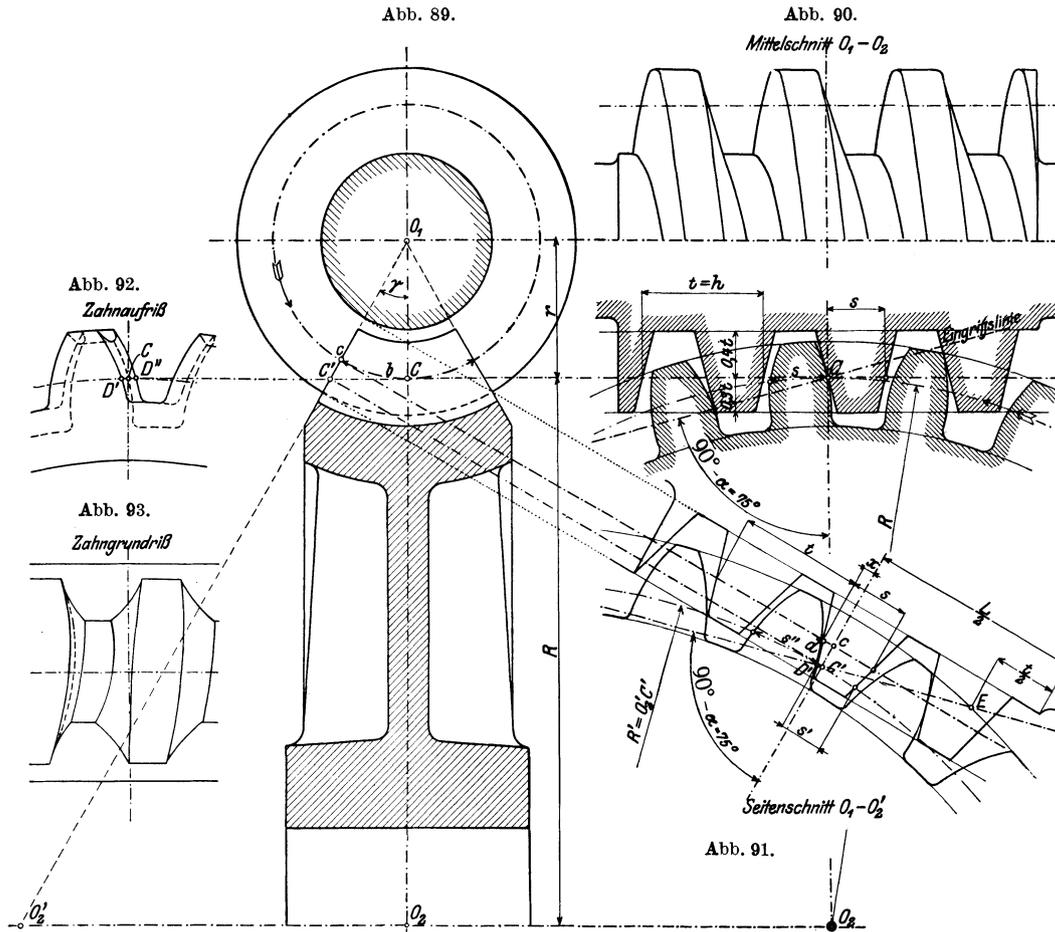
Abb. 89—93. Schneckengetriebe mit unbearbeiteten Zähnen.
