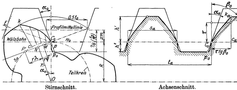
Abb. 9. Nach dem Wälzverfahren geschnittene Zahnflanken. (Sonderverzahnung;  $z_1 = 3$ ,  $z_2 = 8$ ,  $\beta_0 = 45^\circ$ ,  $x = 0,645$ ).
