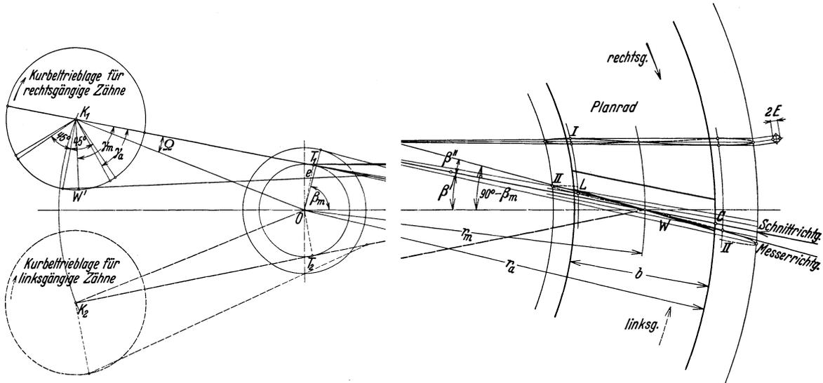
Abb. 60. Hobeln von Tangenzähnen. (Verfahren von Gleason.)
