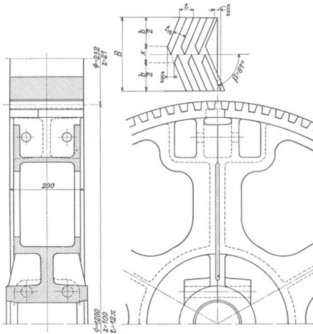
Abb. 37. Wüstrad, geteilt. Teilung durch Gesamtanordnung bedingt. Abstand der Schrauben vom Kranz möglichst gering.
