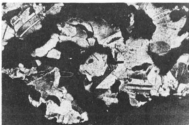
164. Эпигенетические преобразования дендритной структуры самородного золота в результате термального метаморфизма, проявленные в рекристаллизации краевых участков ветвей дендрита и выраженные в ориентированном расположении новообразованных зерен и двойников. Обр. из проявления золото-серебряной формации. Монтир. шл. Травление \text{HCl} + \text{CrO}_3 . Ув. 100
