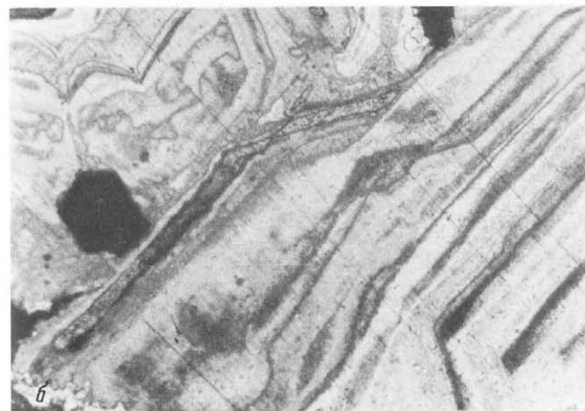
135. Друзовый сросток кристаллов с яснозональной структурой. Зоны подчинены кристаллографическим направлениям куба и октаэдра: а ) общий вид; б ) фрагмент, на котором показан характер срастания кристаллических индивидов. Монтир. шл. Травление \text{HNO}_3 + \text{CrO}_3 . Ув.: а – 150; б – 330
