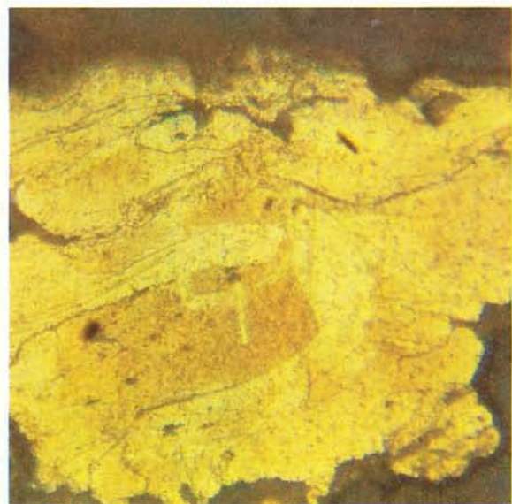
128. Деформационная структура высокопробного золота с клиновидными продольными изогнутыми двойниками. Видны резкие кратеры взрывов газожидких включений. Обр. из россыпи. Монтир. шл. Травление царской водкой. Ув. 100
