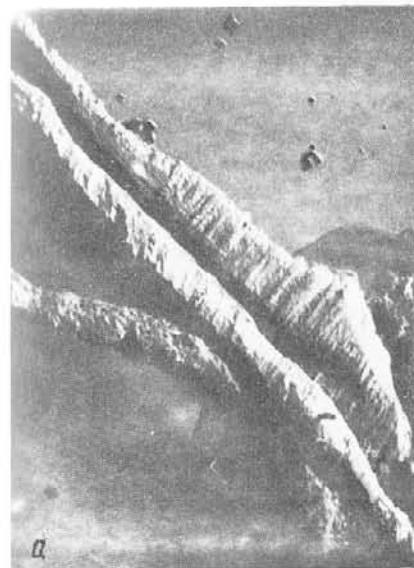
49. Результат стесненного и свободного роста самородного золота. Нижняя часть формировалась в трещине кварца, верхняя – в приоткрытой полости, где начали появляться собственные гранные формы, Ув. 2000
