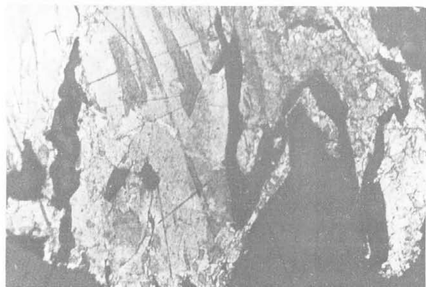
310. Полная экзогенная рекристаллизация золота из верхнемеловых конгломератов Охотско-Чукотского вулканогенного пояса. Монтир. шл. Травление \text{HCl} + \text{CrO}_3 . Ув. 50
