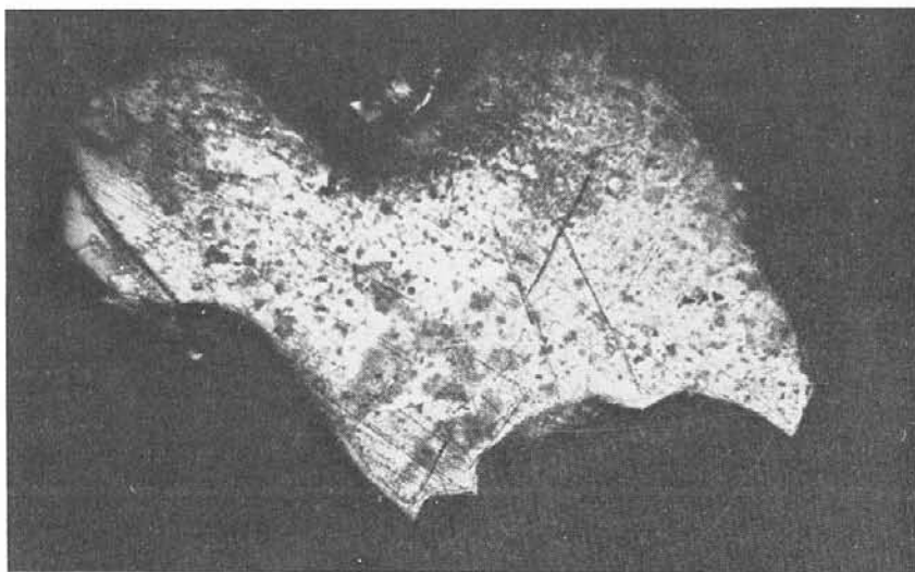
66. Структура пятнистой неоднородности относительно низкопробного самородного золота. Травление раствором \text{CrO}_3 в \text{HCl} . Полир. шл. Ув. 150
