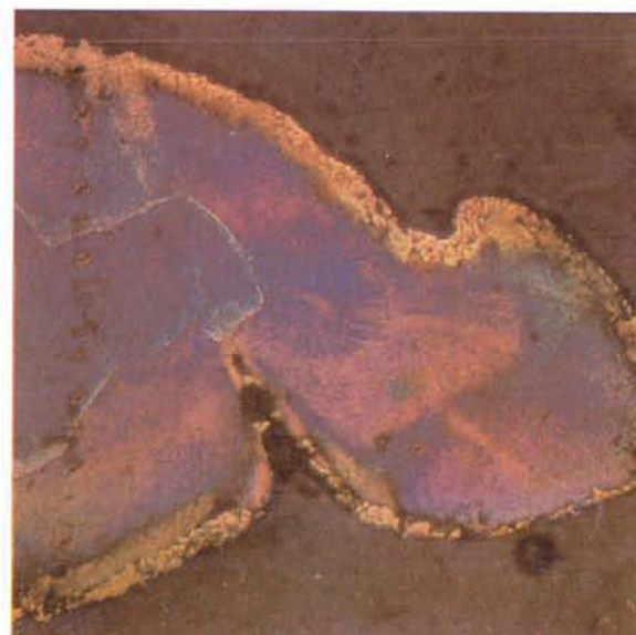
116. Яснозональная структура самородного золота низкой пробы. Зоны подчинены кристаллографическим направлениям. На периферии изогнутая зона – результат коррозии образовавшегося кристалла при нарастании новых зон. Монтир. шл. Травление \text{HNO}_3 + \text{CrO}_3 . Ув. 100
