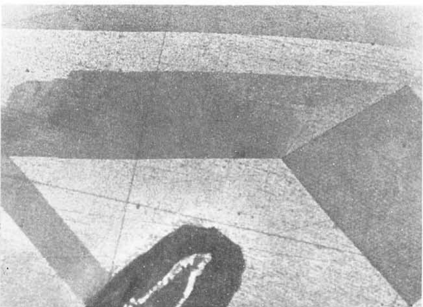
78. Крупнозернистая структура и полисинтетическое двойникование самородного золота высокой пробы. Серое внизу – кварц. Монтир. шл. Травление царской водкой. Ув. 200
