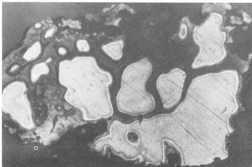
208. Грануляция относительно высокопробного золота и прожилки в межзерновых полостях зонального электрума. Обр. из россыпи, Монтир, шл. Травление \text{HCl} + \text{CrO}_3 . Ув. 100
