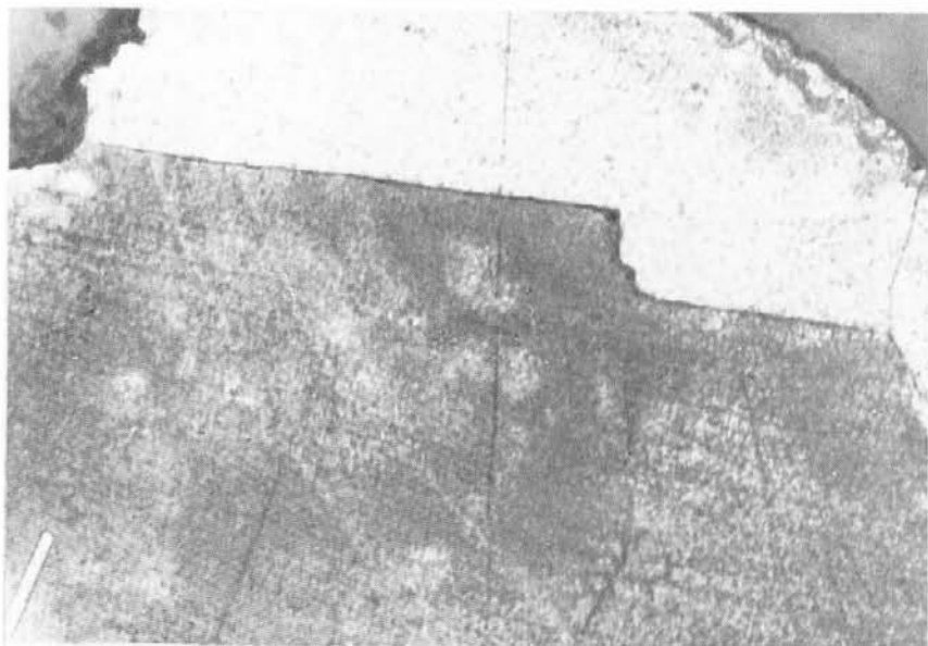
92. Структуры замещения низкопробного золота новообразованным высокопробным, связанные с термальным метаморфизмом. Монтир. шл. Травление \text{HCl} + \text{CrO}_3 . Ув. 150
