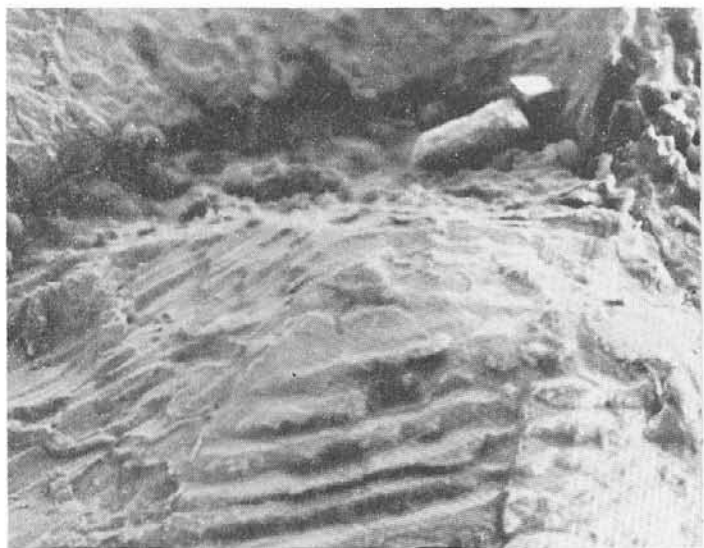
55. Прорастание золота в золоте. На границе прорастания пластинчатые микродеформации, развальцевание золота матрицы. Ув. 1000
