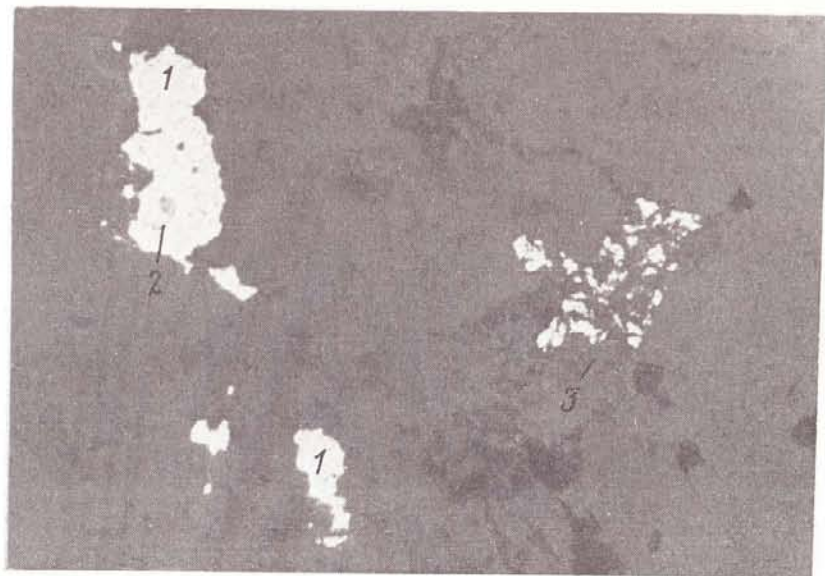
182. Срастание самородного золота (1) с халькопиритом (2), акантитом (3) в кварц-гидрослюдистом агрегате. Обр. из близповерхностного золото-серебряного проявления. Полир. шл. Ув. 200
