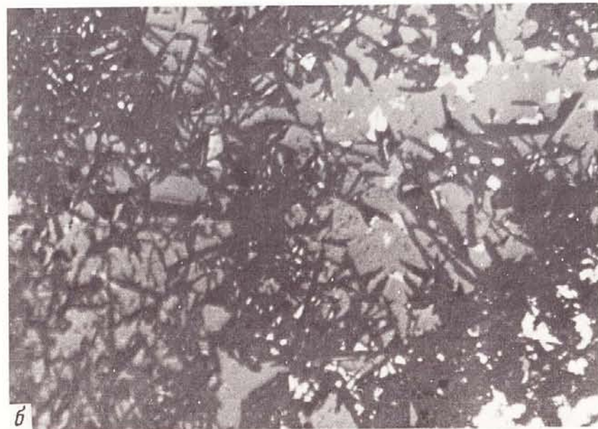
230. Срастание рудных минералов с гидрослюдой: а) срастание кюстелита; б) сфалерит-халькопиритового агрегата. Обр. из близповерхностного золото-серебряного проявления. Полир. шл. Ув. 200
