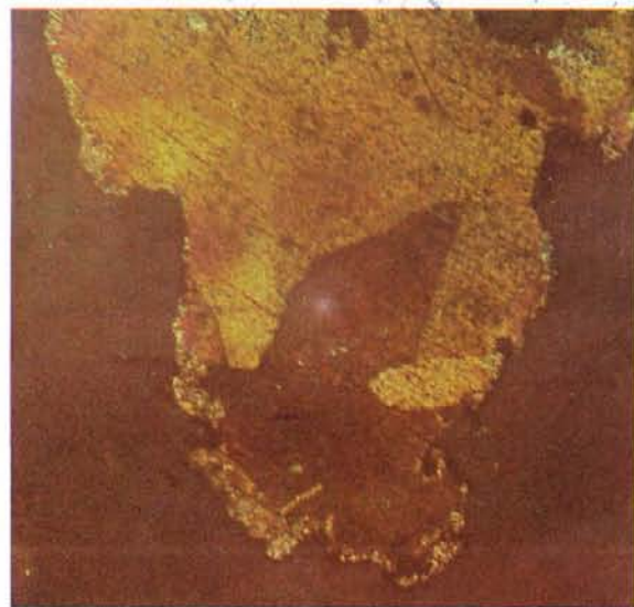
130. Структура, напоминающая эмульсионную структуру распада золота в золоте на фоне полисинтетического двойникования. Обр. из проявления золото-кварцевой формации в экзоконтакте гранитоидного массива. Монтир. шл. Травление \text{HCl} + \text{CrO}_3 . Ув. 130
