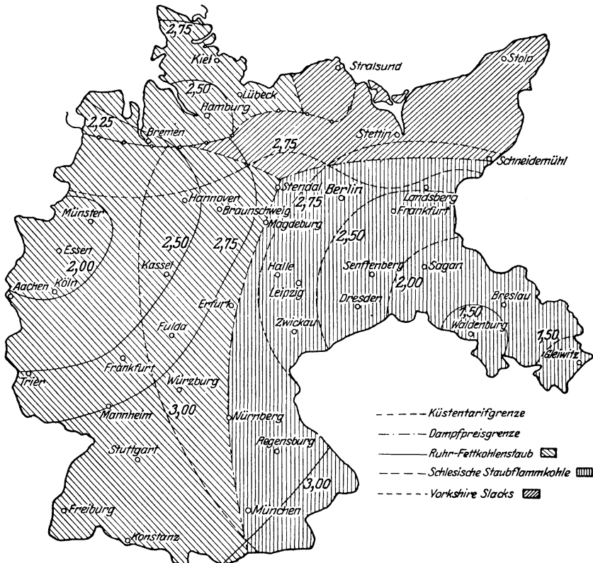
Abb. 15. Linien gleicher Dampfpreise für Ruhrfettkohlenstaub, schlesische Staubflammkohle und englische Yorkshire Slacks.
