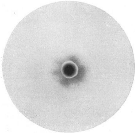
Abb. 226. Laue-Diagramm einer schwach rekristallisierten Aluminiumprobe.
