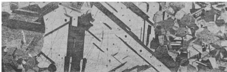
Abb. 282. Druckblech aus  $\alpha$ -Messing mit groben Kristallen, die zum Teil die ganze Blechdicke erfüllen. Geätzt mit Ammoniumsulfat 1:10. (Lin. Vgr. 30.)
