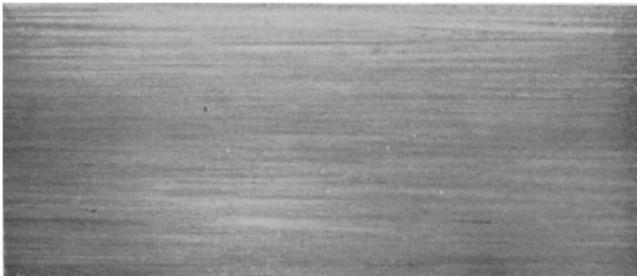
Abb. 259. Dieselbe Platte stärker kaltgewalzt (Höhenabnahme 99%). Die Helligkeitsunterschiede der einzelnen Kristalle sind fast völlig verwischt. Ätzung Flußsäure-Salzsäure. (Lin. Vgr. 1,3.)
