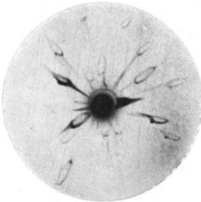
Abb. 194. Laue-Diagramm im Bereiche desselben Kugeleindrucks nach Erhöhung der Drucklast auf 5 kg.
