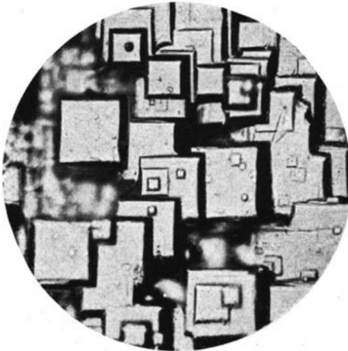
Abb. 48. Kristallfigurenätzung; phosphorhaltiger Eisenkristall mit Ätzfiguren. Geätzt mit Ammoniumpersulfat 10% (Lin. Vgr. 790.) (Nach Harnecker und Rassow.)
