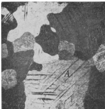
Abb. 138. Gefüge eines schwach deformierten Zinnschliffes vor dem Glühen. Geätzt mit Salzsäure-Kaliumchlorat. (Lin. Vgr. 3,5.)
