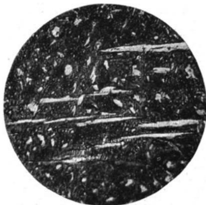
Abb. 59. Mangan-Messing, stark angelassen,  $\alpha$ -Kristalle fast unverändert,  $\beta$ -Kristalle charakteristisch oxydiert. (Lin. Vgr. 210.)
