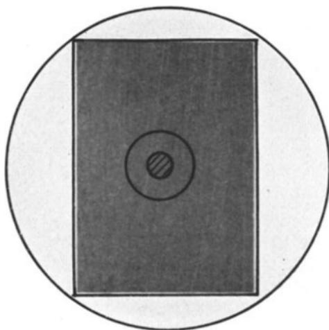
Abb. 191. Durchstrahlungsfeld des in Abb. 190 dargestellten Aluminium-Einkristalls mit eingezeichnetem Kugeleindruck. Geätzt mit Flußsäure-Salzsäure. (Lin. Vgr. 4,5.)
