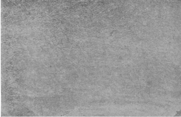
Abb. 93. Dieselbe Probe nach starker Kaltbearbeitung (Höhenabnahme beim Walzen 95 $\frac{0}{0}$ ). Die Helligkeitsunterschiede der einzelnen Kristalle sind völlig verwischt. Geätzt mit Ammoniumpersulfat 1 : 10. (Lin. Vgr. 0,9.)
