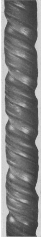
Abb. 242. Verdrehter Einkristall anderer Orientierung (Rundstab). (Etwa natürl. Größe.)
