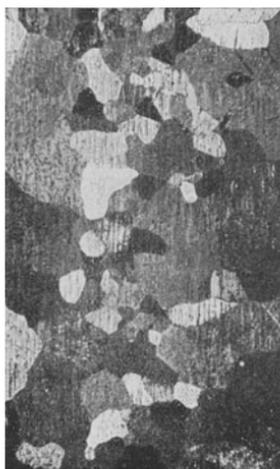
Abb. 150. Gefüge von gegossenem Zinn mit künstlicher Schlißfläche vor dem Glühen. Geätzt mit Salzsäure-Kaliumchlorat. (Lin. Vgr. 5.)
