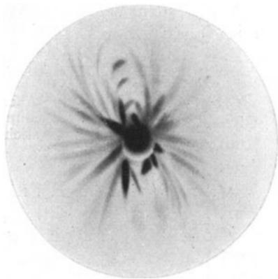
Abb. 199. Laue-Diagramm des selben Gipskristalls nach der Biegebeanspruchung.
