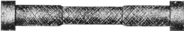
Abb. 121. Kraftwirkungslinien (nach Hartmann).
