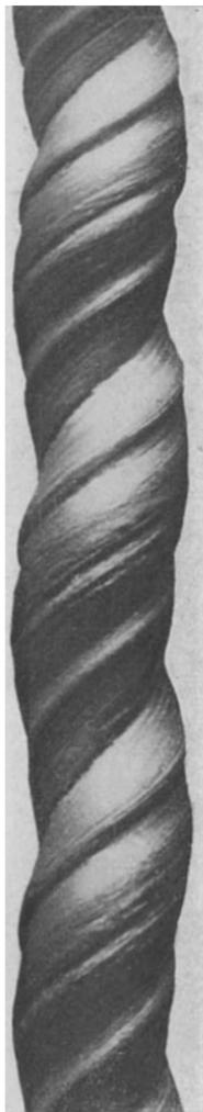
Abb. 239. Verdrehter Aluminium-Einkristall (Rundstab). (Etwa natürl. Größe.)
