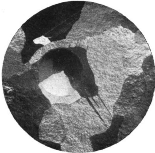
Abb. 157. Derselbe Zinnkristall nach stattgehabter Rekristallisation bei  $215^{\circ}$ , 30 Minuten. Ausbildung mehrerer neuer Kristalle. Geätzt mit Salzsäure-Kaliumchlorat. (Lin. Vgr. 5.)
