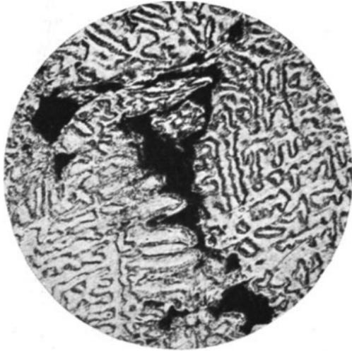
Abb. 78. Dendritische Hohlräume in Rotguß. Geätzt mit Ammoniak-Wattebausch. (Lin. Vgr. 150.)
