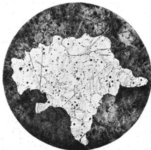
Abb. 67. Allotriomorphe Haufwerkskristalle von Kupfer in uneingeformtem Guß. Ätzipoliert mit ammoniakgetränktem Wattebausch. (Lin. Vgr. 40.)
