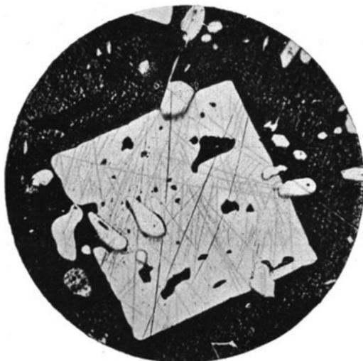
Abb. 71. Idiomorphe Kristalle in einer Zinn-Antimon-Kupferlegierung. Geätzt durch Verdunsten eines Tropfens Salzsäure auf der Schlißfläche. (Lin. Vgr. 180.)
