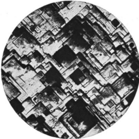
Abb. 163. Atzfiguren an einem Kristall der in Abb. 162 dargestellten Probe. Tiefgeätzt mit Kupferammoniumchlorid 1 : 12 (nach Harnecker u. Rassow). (Lin. Vgr. 700.)
