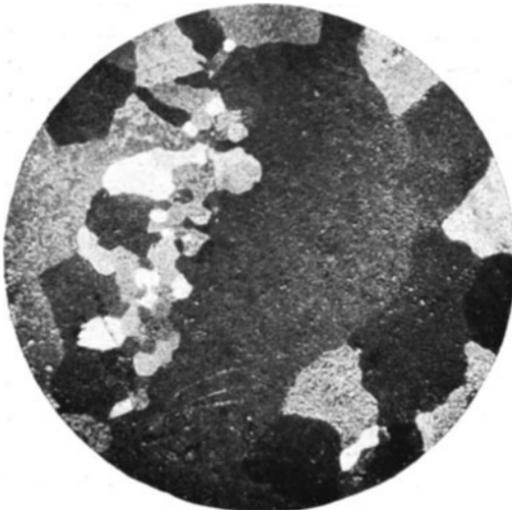
Abb. 149. Das in Abb. 148 dargestellte Metallstück nach einmonatigem Glühen bei 210°. Geätzt mit Salzsäure-Kaliumchlorat. (Lin. Vgr. 6.)
