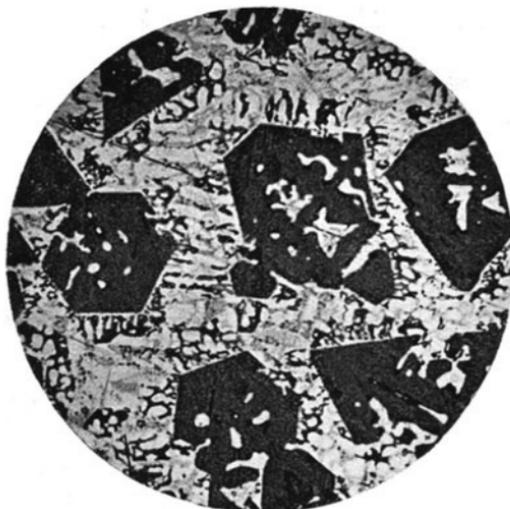
Abb. 70. Idiomorphe Kristalle in einer Zink-Zinn-Magnesiumlegierung. Geätzt durch Verdunsten eines Tropfens Salzsäure auf der Schlißfläche. (Lin. Vgr. 180.)
