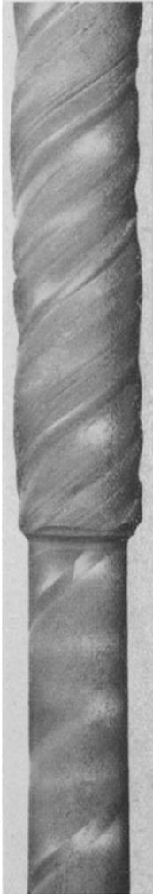
Abb. 245. Verdrehter Aluminium-Einkristall, linke Hälfte nach dem Abdrehen. Geätzt mit Flußsäure-Salzsäure. (Etwa natürl. Größe.)
