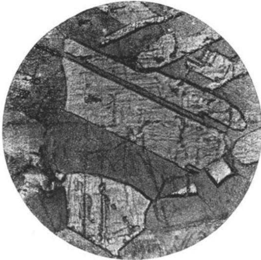
Abb. 164. Gefüge einer rekristallisierten Kupferprobe. Geätzt mit Ammoniumsulfat 1 : 10. (Lin. Vgr. 75.)
