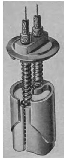
Abb. 161. Regulierschieber des A m a c-Vergaser
