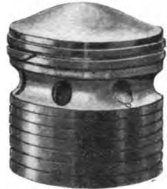
Abb. 126. Kolben mit Kolbenringen
