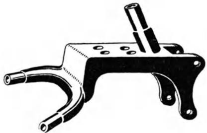
Abb. 46. Getriebebrücke (New Hudson)
