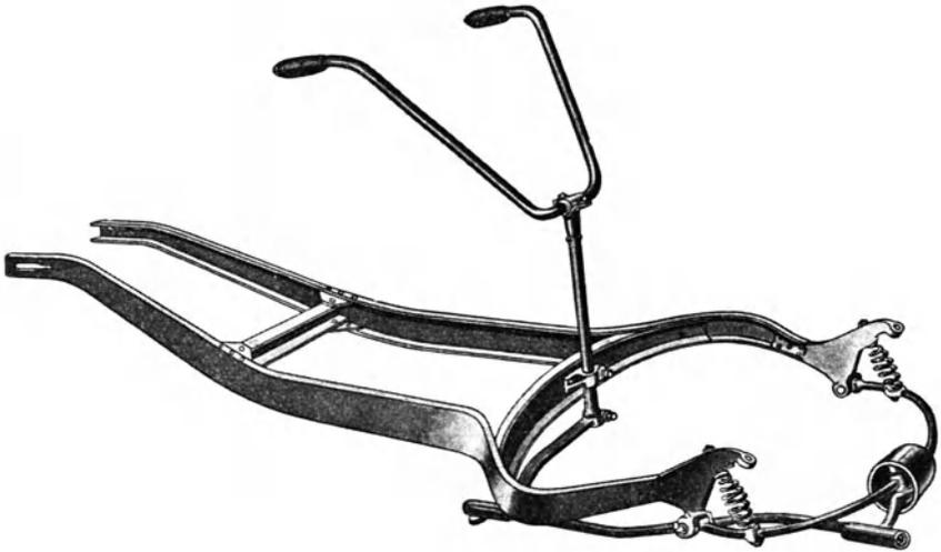
Abb. 58. Kastenrahmen (Neracar)
