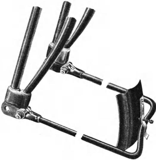
Abb. 80. Vorderradständer, aufgeklappt
