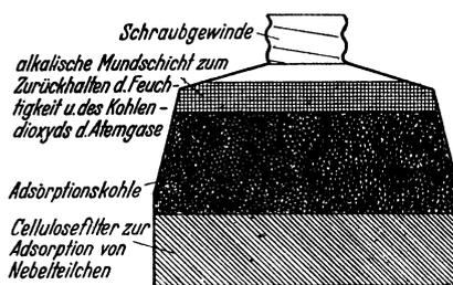
Abb. 28. Schnitt durch einen Gasmaskeneinsatz.
