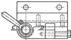
Abb. 109. Standbohrspannvorrichtung für 2. Arbeitsstufe. *a*<sub>1</sub>...*a*<sub>4</sub> Aufnahmebolzen zum Bestimmen des Werkstückes. *b*<sub>1</sub>...*b*<sub>3</sub> Kuppenstützen (Dreipunktauflage). *c* Verschlusschubriegel mit Spannschraube *d*.
