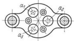
Abb. 47. Spann- und Bohrplatte mit drei ausmittenden und bestimmenden Kegelstiften als Ergänzungsteil zu Abb. 45.  $a_1 \dots a_3$  Kegelstifte, stehen unter Federdruck.
