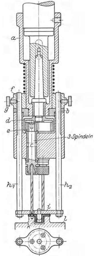
Abb. 45. Dreispindelkopf mit Bohrspannvorrichtung.
