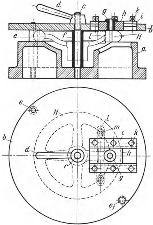
Abb. 140. Bohrspannvorrichtung für Handräder, zu umständlich im Gebrauch.
