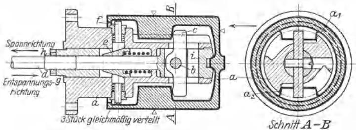
Abb. 78. Fliegende Rundbearbeitung-Spannvorrichtung.
