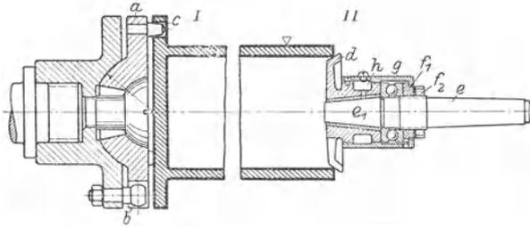
Abb. 73. I und II Spitzenvorrichtungen zum Drehen von Pufferstößeln. I a Druckverteiler (Kugelwippe), b Mitnehmerbolzen, c Ausmitt- und Mitnehmerstifte (drei Stück am Umfange gleichmäßig verteilt). II d Zentrierkegel, auf Kegeldorn e umlaufend,  $f_1$  und  $f_2$  Ringmuttern, auf e verstellbar, zum Einstellen des Kegelgleitlagers  $e_1$ . g Überwurfmutter, hält alle Teile zusammen. h Ölkammer.
