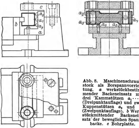
Abb. 8. Maschinenschraubstock als Borspanvorrichtung. *a* werkstückbestimmender Backeneinsatz mit drei Kammstützen  $a_1 \dots a_3$  (Dreipunktauflage) und zwei Kuppenstützen  $a_4$  und  $a_5$  (Zweipunktauflage), *b* Werkstückmittler Backeneinsatz der beweglichen Spannbacke. *c* Bohrplatte.
