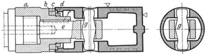
Abb. 89. Achsennut für Kolben.
