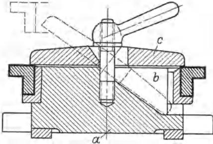
Abb. 125. Einfacher und billiger Schnellspanverschluß (Gegenentwurf zu Abb. 124). *a* Vorrichtungskörper mit Vertiefung *b*, in die Spanneisen *c* geklippt werden kann.
