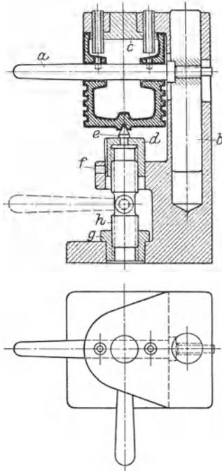
Abb. 83. Standbohrspannvorrichtung. *a* richtungsbestimmender Aufnahmedorn, sitzt fest in achsrecht beweglichem Geradführungsbolzen *b*. *c* Ausmittscheibe. *d* Spannmutter mit mehrgängigem Rechtsgewinde, trägt Körnerspitze *e* und wird durch Zapfenschraube *f* am Mitdrehen verhindert. *g* mehrgängige Mutter mit Linksgewinde, sitzt fest im Vorrichtungskörper. *h* Zwieselschraube, bewegt Spannmutter *d* um die doppelte Gewindesteigung.
