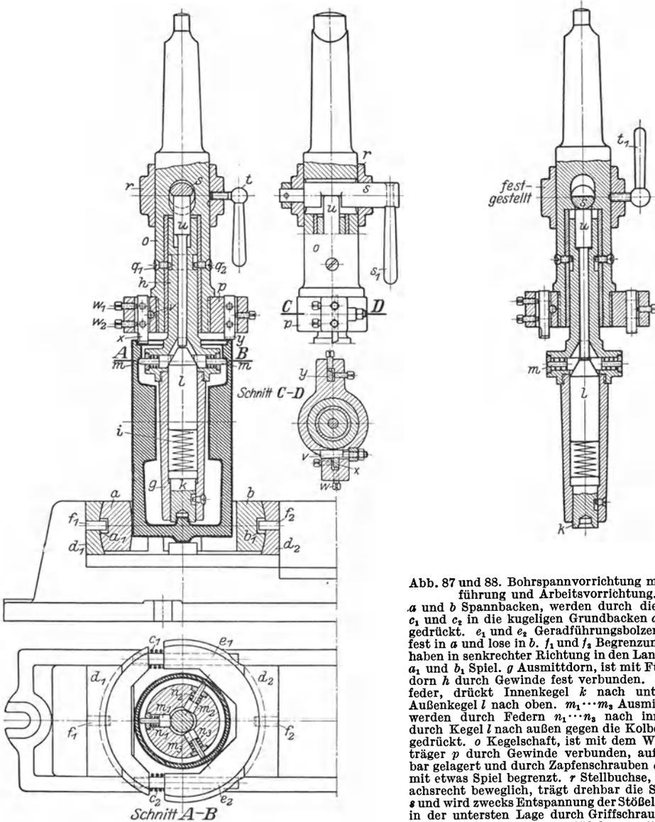
Abb. 87 und 88. Bohrspannvorrichtung mit Dornführung und Arbeitsvorrichtung.
