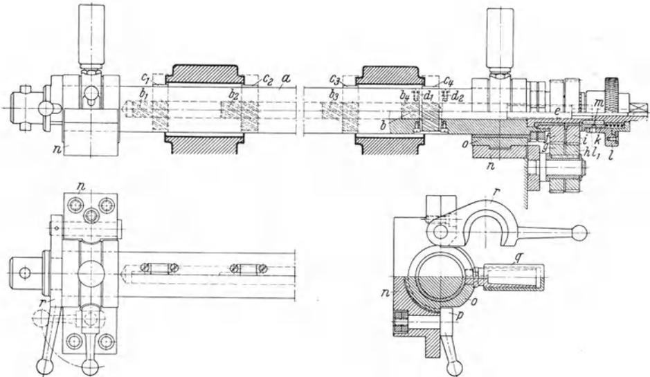
Abb. 111. Abflächvorrichtung zur Bohrspannvorrichtung Abb. 110.
