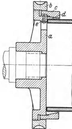
Abb. 12. Spannfutter für größere Spanndurchmesser.
