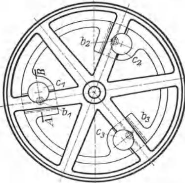
Abb. 90. Fliegende Rundbearbeitung-Spannvorrichtung.
