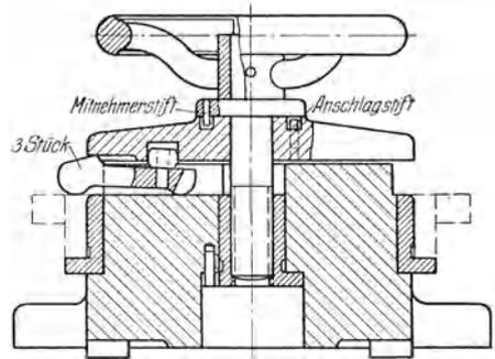
Abb. 124. Vorrichtung mit fehlerhaftem und zu teurem Schnellspannverschluß.
