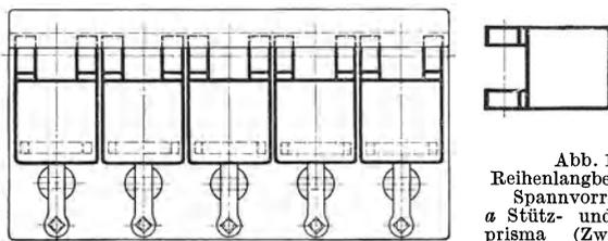
Abb. 104. Reihenlangbearbeitung-Spannvorrichtung. a Stütz- und Ausmittprisma (Zweipunktauf-lage). b Spannebel.
