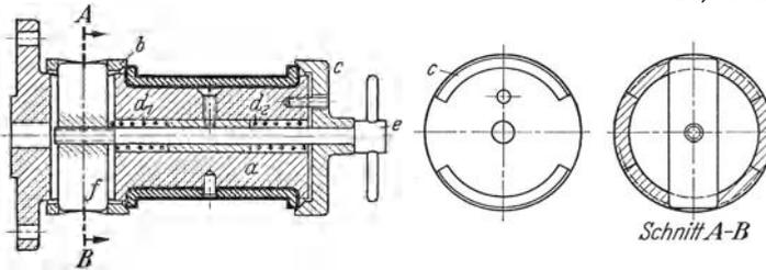
Abb. 103. Fliegende Rundbearbeitung-Spannvorrichtung. a Ausmitt- und Aufnahmedorn. b, c Spannscheiben, werden durch Druckfedern  $d_1, d_2$  auseinander- und durch Spannschraube e mit Querstück f zusammengedrückt.
