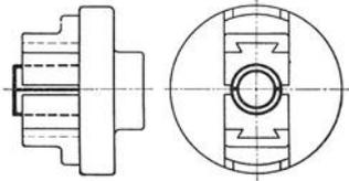
Abb. 102. Zweibackenfutter zum Ausbohren von Lagerschalen.
