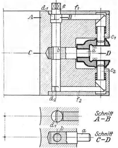
Abb. 93. Spanneinheit einer Reihenrundbearbeitungs-Spannvorrichtung.
