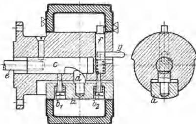
Abb. 21. Fliegender Dorn mit beweglicher Spannbacke. *a* Spannbacke, wird durch Druckfedern *b*<sub>1</sub>, *b*<sub>2</sub> nach innen gedrückt (entspannt) und durch Keilstößel *c*, der mit Zugstange *e* verbunden ist, nach außen gedrückt. *f* Mitnehmerstift, wird durch Griff *g* radial bewegt.
