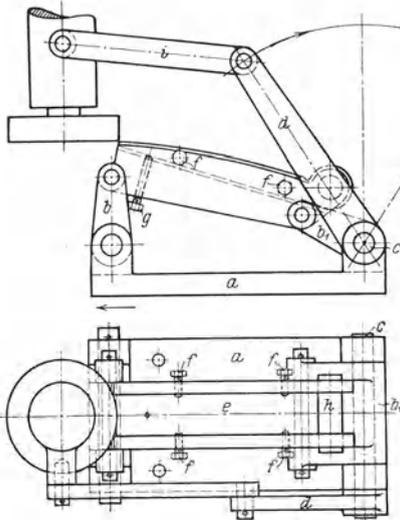
Abb. 56. Schleifvorrichtung für gekrümmte Flächen.
