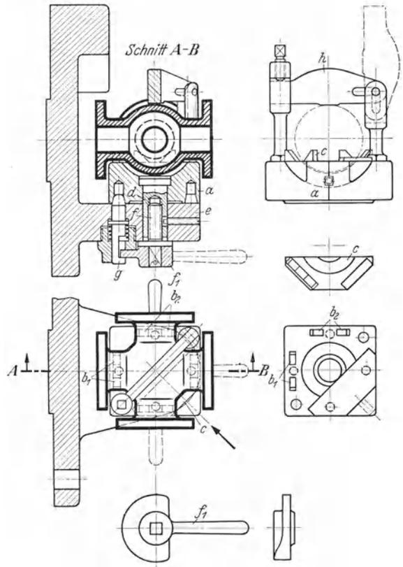
Abb. 28. Schwenkbare Rundbearbeitung-Spannvorrichtung. *a* schwenkbarer Aufnahmekörper, trägt als Stütz- und Zentriermittel die beiden prismatischen Knaggen  $b_1$ ,  $b_2$  und die Wippe *c*, die zusammen eine Dreipunktauflage ergeben. *d* Spannbolzen, verbindet *a* mit Vorrichtungskörper *e*. *f* Griffschraube mit Kurvenflansch, dient zum festen Verspannen von *a* mit *e* und zum Bewegen des Feststellbolzens *g*. *h* Spannbügel.
