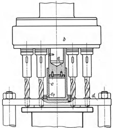
Abb. 60. Mehrspindelbohrkopf mit Preßluft-Hebeeinrichtung. *a* Preßluftkolben, am Bohrkopf *b* befestigt. *c* Preßluftzylinder, an der Standbohrspannvorrichtung *d* befestigt. *c*<sub>1</sub> Öffnung für Preßluftanschluß.
