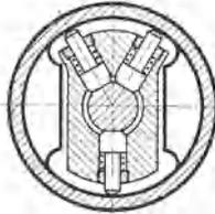
Abb. 76. Schlecht ausgemitteter Kolben.
