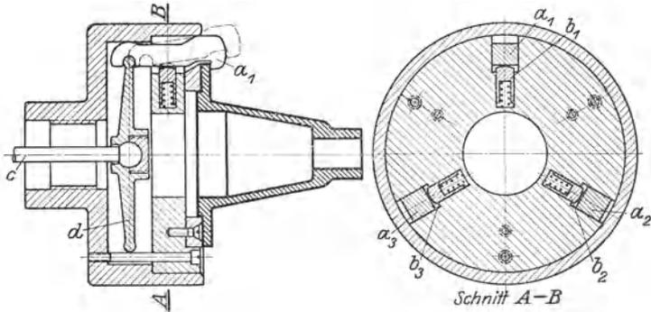
Abb. 25. Achsenspannfutter für Außenspannung.
