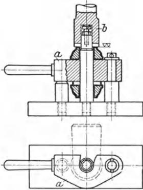
Abb. 94. Standbohrspannvorrichtung mit Dornführung.  $a$  entfernungsbestimmende Schwenkstütze.  $b$  Senkwerkzeug.
