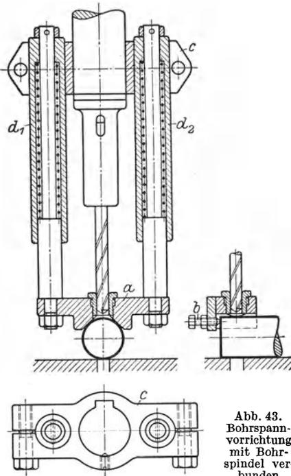
Abb. 43. Bohrspannvorrichtung mit Bohrspindel verbunden.
