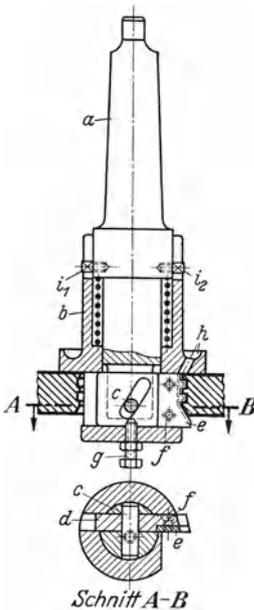
Abb. 50. Rillenschneider. *a* Kegeldorn, trägt achsrecht beweglich die unter Federdruck stehende Hülse *b* und fest den Bolzen *c*, der in schräger Nut des Messerbalkens *d* gleitet und diesen radial bewegt. *e* Rillmesser, durch Schrauben *f* an *d* befestigt. *g* Anschlagschraube. *h* Kühlmittelfangrille.  $i_1, i_2$  Mitnehmerschrauben.
