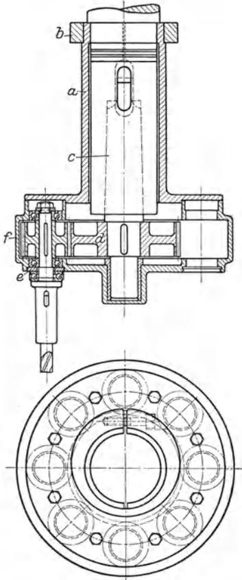
Abb. 59. Mehrspindelbohrkopf auf Kugellager laufend. *a* Deckel mit Befestigungsschraube, wird an nicht umlaufender Bohrspindelhülse durch Klemmring *b* befestigt. *c* Kegelschaft mit treibendem Rad *d*, in Bohrspindel befestigt. *e* Gewinding in Gehäuse *f* befestigt.
