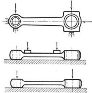
Abb. 32...34. Spannkkräfte beim Bohren von Schubstangen.
