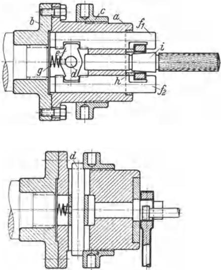
Abb. 26. Achsenspannfutter zum Schleifen.
