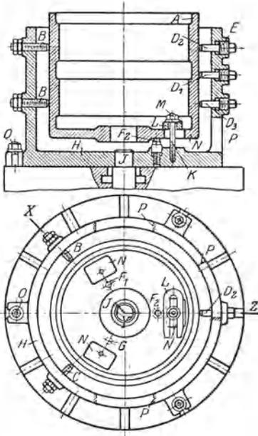
Abb. 112. Rundbearbeitungs-Spannvorrichtung mit schlechter Wirkungsweise.
