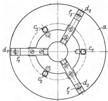
Abb. 127. Vergrößertes Dreibackenfutter als Sonderspannvorrichtung (Gegenentwurf zu Abb. 126). *a* Führungsring, auf Futterkörper *b* durch Schrauben *c*<sub>1</sub>...*c*<sub>3</sub> befestigt. *d*<sub>1</sub>...*d*<sub>3</sub> Sonderbacken, auf den Futtergrundbacken *e*<sub>1</sub>...*e*<sub>3</sub> befestigt und durch Schrauben *f*<sub>1</sub>...*f*<sub>3</sub> mit *a* in Langlöchern beweglich verbunden.
