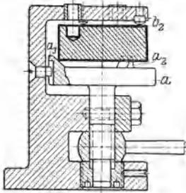
Abb. 69. Standbohrspannvorrichtung für 1. Arbeitsstufe.  $a$  Spann- und Ausmittstück.  $a_1, a_2, a_3$  Ausmittknaggen (Teile eines Innenkegels).  $b_1, b_2, b_3$  Kuppenstützen (Dreipunktauflage).
