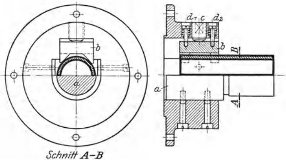
Abb. 100. Fliegende Rundbearbeitungsspannvorrichtung.
