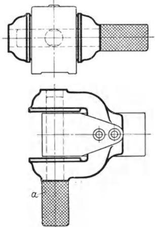
Abb. 96. Standbohrspannvorrichtung mit doppelter Werkzeugführung.  $a$  Entfernung- und richtungsbestimmender Bolzen.  $b$  Aufnahme dorn mit Führungsbüchsen.
