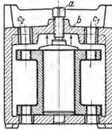
Abb. 128. Fehlerhafte Kippbohrspannvorrichtung.
