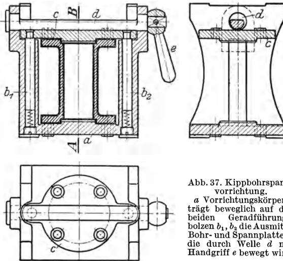
Abb. 37. Kippbohrspannvorrichtung. *a* Vorrichtungskörper, trägt beweglich auf den beiden Geradführungsbolzen *b<sub>1</sub>, b<sub>2</sub>* die Ausmitt-, Bohr- und Spannplatte *c*, die durch Welle *d* mit Handgriff *e* bewegt wird.
