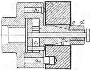
Abb. 71. Fliegende Rundbearbeitungs-Spannvorrichtung.  $a_1, a_2, a_3$  Ausmitt- und Mitnehmerstifte.  $b_1, b_2, b_3$  Kuppenstützen (Dreipunktauflage).  $c_1, c_2, c_3$  Auswerferstifte (durch Spannmutter  $d$  zu betätigen).  $e$  Spannbüchse.
