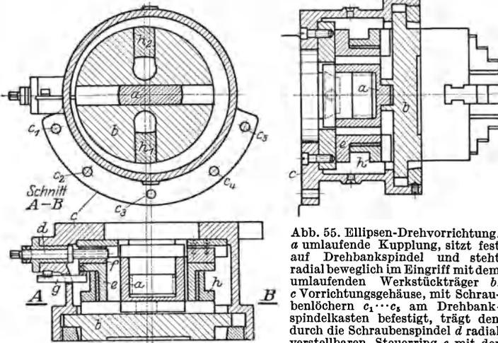
Abb. 55. Ellipsen-Drehvorrichtung. *a* umlaufende Kupplung, sitzt fest auf Drehbankspindel und steht radial beweglich im Eingriff mit dem umlaufenden Werkstückträger *b*. *c* Vorrichtunggehäuse, mit Schraubenlöchern *c*<sub>1</sub>...*c*<sub>3</sub> am Drehbankspindelkasten befestigt, trägt den durch die Schraubenspinde *d* radial verstellbaren Steuerring *e* mit der Mutter *f* und dem Verstellanzeiger *g*.
