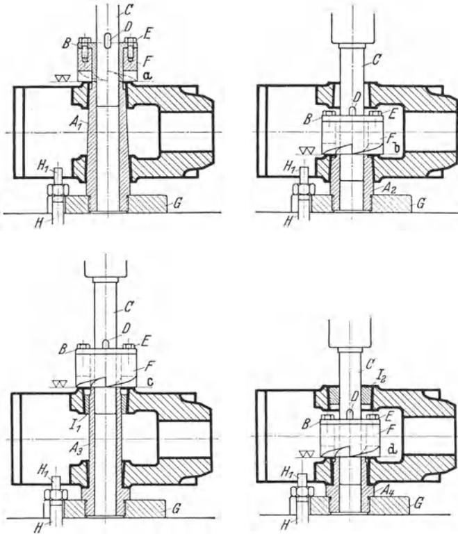
Abb. 64...67. Vier Standbohrspannvorrichtungen zum Abflächen.
