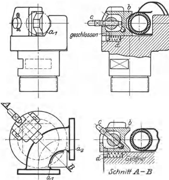
Abb. 30. Ergänzungsteil zur Vorrichtung Abb. 29.  $a_1 \dots a_2$  prismatische Knaggen, unterstützen das Werkstück (Zweipunktauf-
