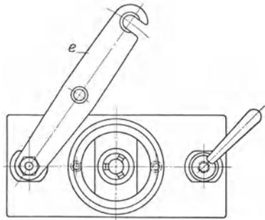
Abb. 85. Bohrspannvorrichtung zum mittigen Anbohren von Kolben.
