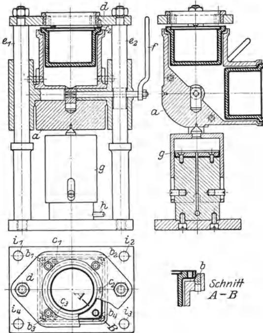
Abb. 41. Preßluft-Bohrspanvorrichtung mit schwenkbarem Aufnahmekörper.
