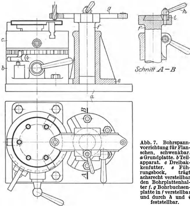
Abb. 7. Bohrspanvorrichtung für Flanschen, schwenkbar. *a* Grundplatte, *b* Teilapparat, *c* Dreipunktfutter, *e* Führungsbock, trägt achsrecht verstellbar den Bohrplattenhalter *f, g* Bohrbochsenplatte in *f* verstellbar und durch *h* und *i* feststellbar.
