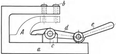
Abb. 144. Schlecht eingespanntes Werkstück.
