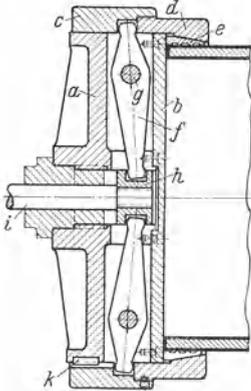
Abb. 14. Spannfutter für großen Spanndurchmesser und Preßluftbetrieb.
