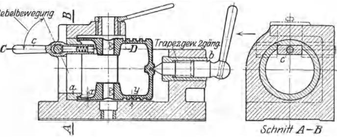
Abb. 80. Standbohrspannvorrichtung mit doppelter Werkzeugführung.
