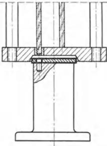
Abb. 46. Spann- und Ausmittstück mit Innenkegel für Wellenstumpfe als Ergänzungsteil zu Abb. 45.
