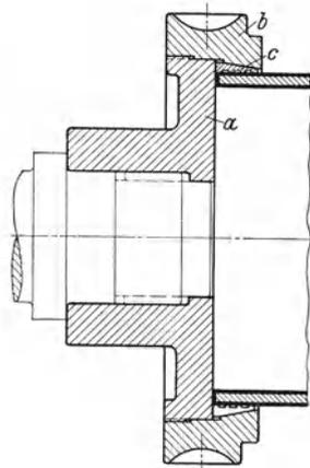
Abb. 11. Spannfutter für kleine Spanndurchmesser.
