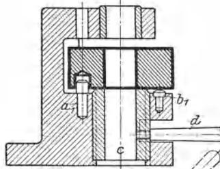
Abb. 70. Standbohrspannvorrichtung für 2. Arbeitsstufe.  $a_1, a_2, a_3$  Ausmitt- und Haltestifte.  $b_1, b_2, b_3$  Kuppenstützen (Dreipunktauflage).  $c$  Auswerferschraube (durch Handgriff  $d$  betätigt).
