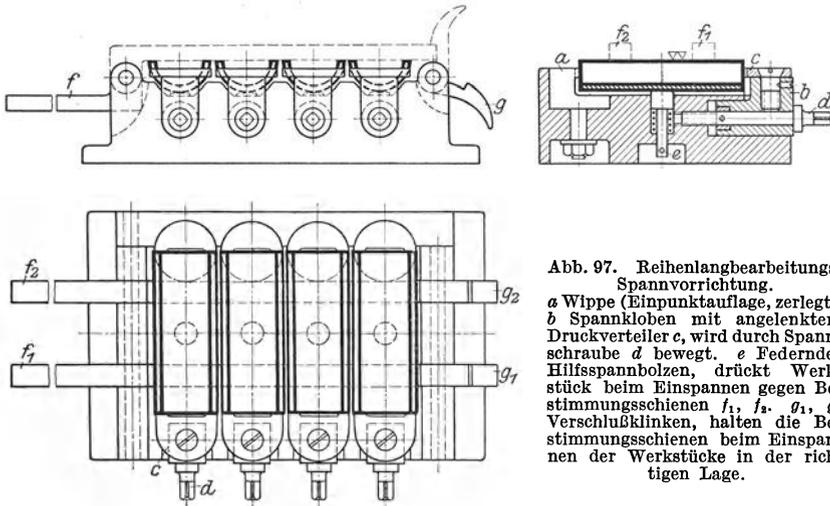
Abb. 97. Reihenlangbearbeitungs-Spannvorrichtung.
