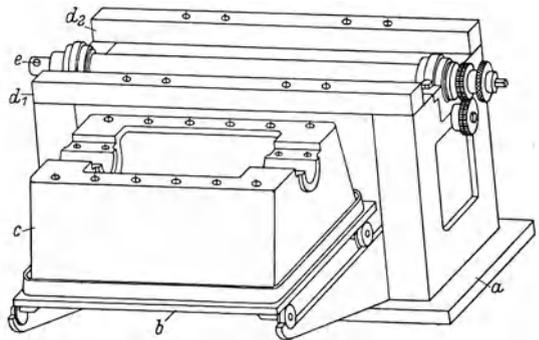
Abb. 110. Bohrspannvorrichtung mit eingesetzter Abflächvorrichtung nach Abb.111.
