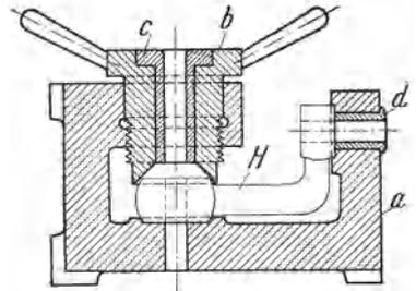
Abb. 130. Fehlerhafte und unvollständige Kippbohrspannvorrichtung.
