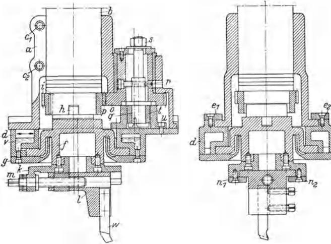
Abb. 54. Ellipsenbohrvorrichtung.
