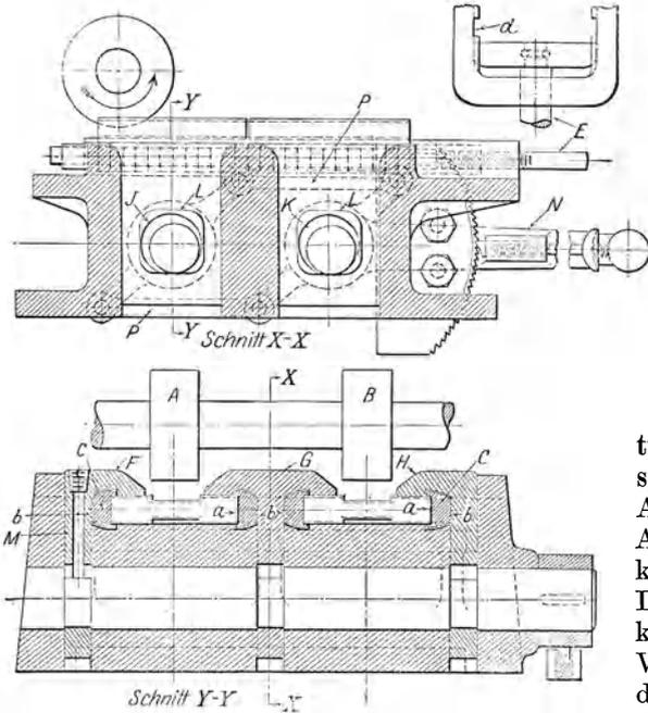
Abb. 36. Reihenspannvorrichtung mit Ladekäfig. *F, G, H* Spannbacken, werden in den Durchbrüchen *L, L* durch Kröpfscheibenwellen *J* und *K* bewegt. *C, C* Ladekäfige. *N* Spannhebel mit Feststellklinke. *E* Spannschraube, drückt Werkstücke im Ladekäfig zusammen.
