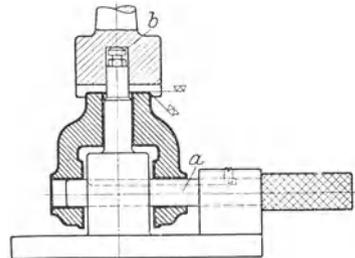
Abb. 92. Standbohrspannvorrichtung mit
