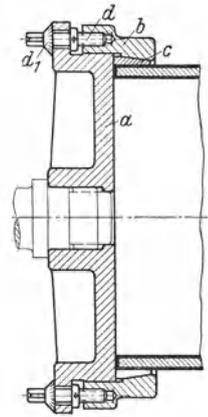
Abb. 16. Spannfutter mit handwerklicher Ausmittlung.
