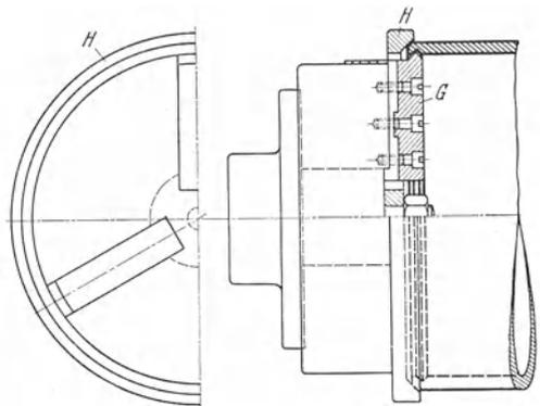
Abb. 4. Mittendes Futtert mit Sonderspannbacken und Gegenring. *G* Sonderspannbacke mit schneidenartiger Druckfläche, dreifach, fest verbunden mit Grundbacken des Futtert. *H* Innenkegelscheibe, Gegendruck der Spannbacken aufnehmend.
