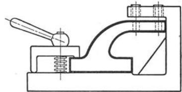
Abb. 145. Gut eingespanntes Werkstück (Gegenentwurf zu Abb. 144).
