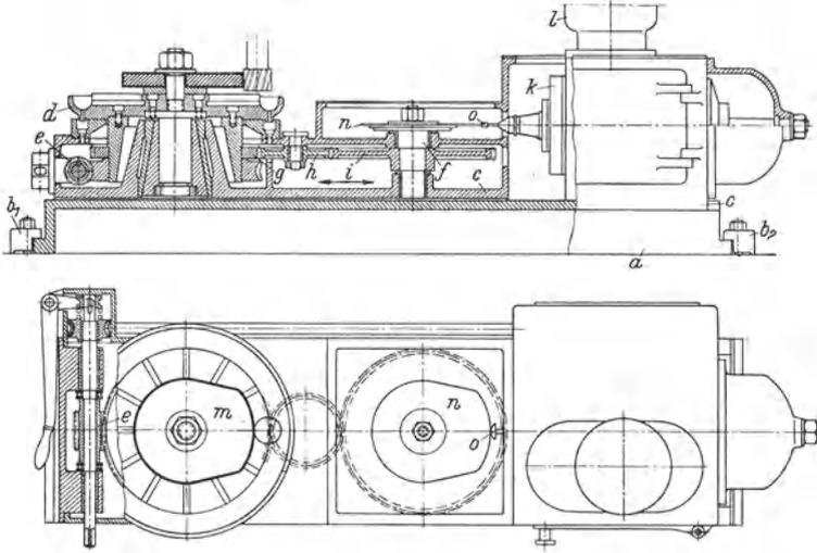
Abb. 58. Hydraulische Kopier-Fräsvorrichtung.
