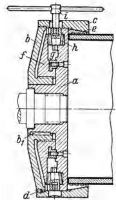
Abb. 13. Spannfutter für große Spanndurchmesser.
