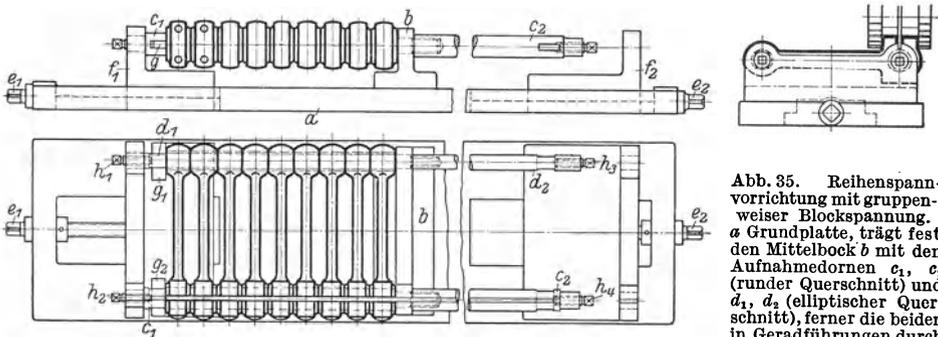
Abb. 35. Reihenspannvorrichtung mit gruppenweiser Blockspeannung. *a* Grundplatte, trägt fest den Mittelbock *b* mit den Aufnahmedornen *c*<sub>1</sub>, *c*<sub>2</sub> (runder Querschnitt) und *d*<sub>1</sub>, *d*<sub>2</sub> (elliptischer Querschnitt), ferner die beiden in Geradführungen durch Spindeln *e*<sub>1</sub>, *e*<sub>2</sub> beweg-
