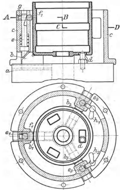
Abb. 113. Rundbearbeitungs-Spannvorrichtung mit Dreibackenfutter verbunden (Gegenentwurf zu Abb. 112).
