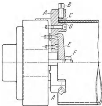
Abb. 3. Mittendes Futtert mit Sonderschraubenspannbacken. *A* Sonderspannbacke, dreifach, mit Grundbacke des Futtert fest verbunden. *B* Spannschraube, dreifach, zum Festklemmen der Werkstückwand. *C* Werkstückschonende Beilage. *D* rundgearbeitete Backenauflage an *A*. *E* backenfestklemmende Scheibe. *F* Spannmutter.
