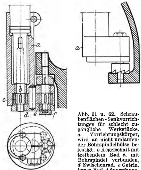
Abb. 61 u. 62. Schraubenflächen-Senkvorrichtungen für schlecht zugängliche Werkstücke. *a* Vorrichtungskörper, wird an nicht umlaufender Bohrspindelhülse befestigt. *b* Kegelschaft mit treibendem Rad *c*, mit Bohrspindel verbunden. *d* Zwischenrad. *e* Getriebenes Rad. *f* Spurpfanne.
