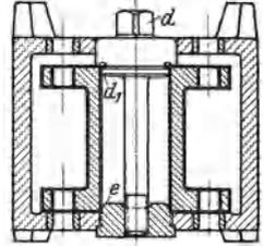
Abb. 129. Kippbohrspannvorrichtung mit richtiger Anordnung der Spannschraube (Gegenentwurf zu Abb. 128). Spannschraube *d* drückt das Werkstück auf die untere Gehäusewand, *d*<sub>1</sub> mit dem Werkstück oben, *e* unten.
