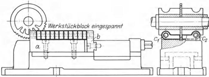
Abb. 9. Maschinenschraubstock als Reihenspannvorrichtung mit Blockspannung. *a* Sonderbacke mit Auflage-
