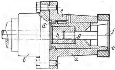
Abb. 18. Tiefspannfutter für Innenspannung. *a* Vorrichtungskörper, mit Drehbankmitnehmerscheibe *b* fest verbunden. *c* Spannzange, in *a* achsrecht ein wenig beweglich, durch *d* in dieser Bewegung begrenzt und durch Gleitfeder *e* am Verdrehen verhindert. *f* Spreizkegel, durch Doppelmutter *g* mit Kolbenstange *h* des Preßluftspanners fest verbunden.
