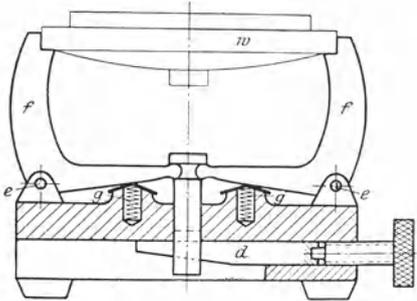
Abb. 126. Schlecht durchgebildete und zu teure Spannvorrichtung.
