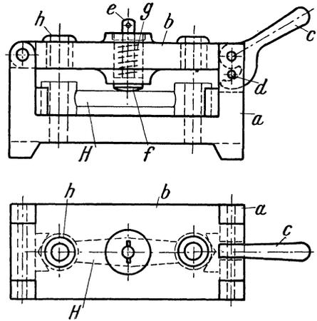
Abb. 136. Standbohrspanvorrichtung mit schlechter Wirkungsweise.
