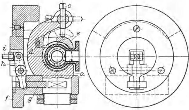
obere Teil der Abb. 30 verbunden werden, womit gezeigt wird, daß bei nicht genügenden Stückzahlen der Unterteil für mehrere Werkstücke gleicher oder ähnlicher Art und Größe verwendet werden kann.
