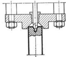
Abb. 44. Spann- und Bohrplatte mit Innenkegelausmittlung als Ergänzungsteil zu Abb. 43.
