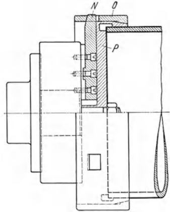
Abb. 6. Mittendes Futter mit Sonderspannfutter für Außenspannung verbunden.
