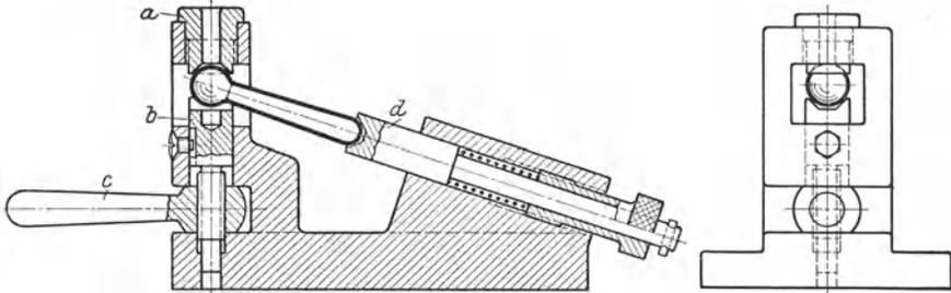
Abb. 143. Standbohrspannvorrichtung für Griffmuttern verschiedener Abmessung (Gegenentwurf zu Abb. 142).
