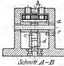
Abb. 108. Standbohrspannvorrichtung für 1. Arbeitsstufe. *a* Druckverteiler mit den prismatischen Knaggen *a*<sub>1</sub>, *a*<sub>2</sub>, *a*<sub>3</sub>, *a*<sub>4</sub>, durch die das Werkstück halb ausgemittet wird. *a*<sub>5</sub> Kante zum Entfernungsbestimmen des Werkstückes. *b*<sub>1</sub>, *b*<sub>2</sub>, *b*<sub>3</sub> Kuppenstützen (Dreipunktauflage). *c* Spannschraube an *a*
