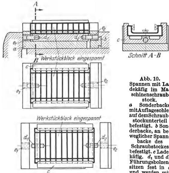
Abb. 10. Spannen mit Ladekäfig im Maschinenschraubstock.
