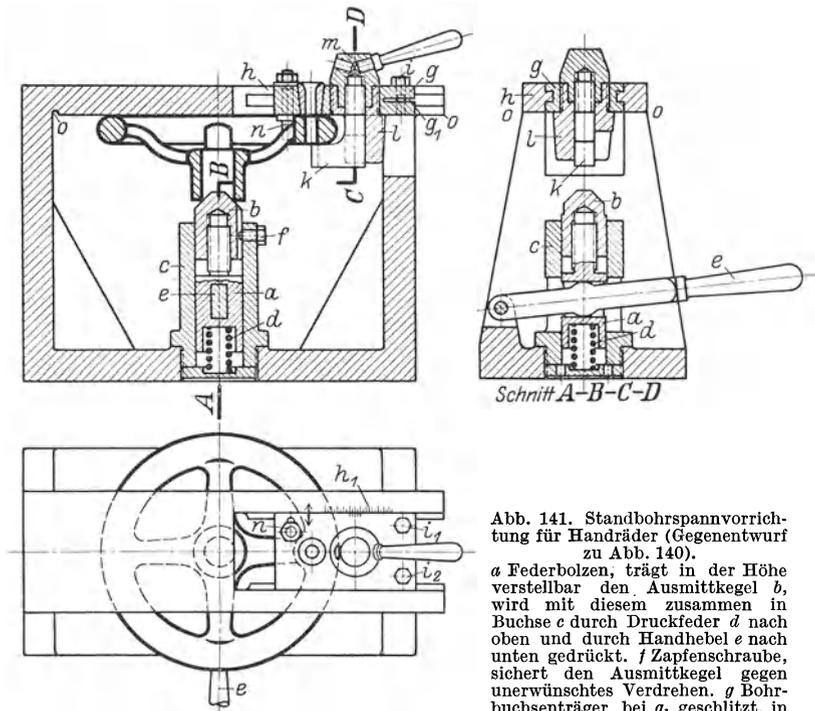
Abb. 141. Standbohrspannvorrichtung für Handräder (Gegenentwurf zu Abb. 140).
