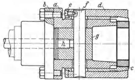
Abb. 19. Tiefspannfutter für Außenspannung. *a* Vorrichtungskörper, mit Drehbankmitnehmerscheibe *b* fest verbunden. *c* Spannzange, auf *a* in Achsenrichtung ein wenig beweglich. *d* Spannbuchse, auf *c* in Achsenrichtung ein wenig beweglich und durch Haltering *e* in dieser Bewegung begrenzt. *f* Verbindungsbolzen, sitzt fest in *d* und *g*. *h* Kolbenstange des Preßluftspanners, mit *g* fest verbunden.
