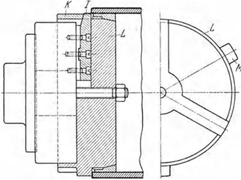
Abb. 5. Mittendes Futter mit Sonderspannfutter für Innenspannung verbunden.
