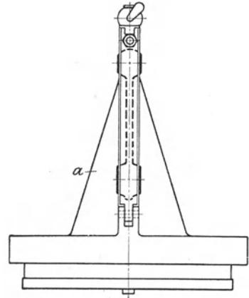
Abb. 31. Schwenkbare Doppelspannvorrichtung für Langbearbeitung. *a* schwenkbarer Aufnahmekörper mit zwei Spanneinheiten. *b* Prismenwippe (Einpunktauflage zerlegt), mittels das Werkstück mit Hilfe der prismatischen Knaggen *c* des Spannbügels *d*. *e* Zugfeststeller, dient zum Schwenken und Feststellen des Obertheiles. *f* Griffmutter, verspannt Obertheil *a* mit dem Unterteil *g*.
