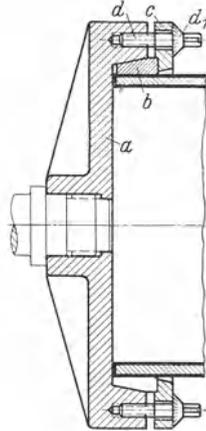
Abb. 15. Spannfutter mit handwerklicher Ausmittlung und einfacher Form. *a* Futterkörper, mit Maschinenspindel fest verbunden. *c* Spannring. *b* Spreizring, einmal geschlitzt, in *a* lose eingemittet. *d* Spannschrauben, mehrfach, mit Gradskala *d*<sub>1</sub> versehen, werden nacheinander angezogen und bewegen damit *b* und *c*.
