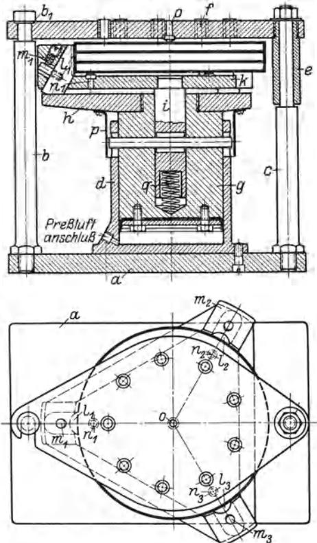
Abb. 42. Preßluft-Bohrspanvorrichtung zum paketweisen Bohren runder Scheiben.
