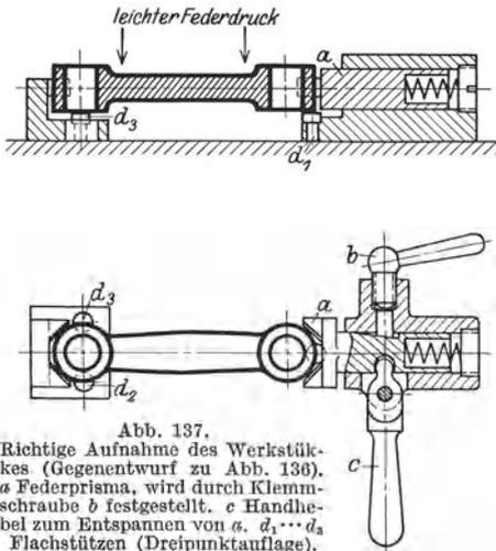
Abb. 137. Richtige Aufnahme des Werkstückes (Gegentwurf zu Abb. 136).  $a$  Federprisma, wird durch Klemmschraube  $b$  festgestellt.  $c$  Handhebel zum Entspannen von  $a$ ,  $d_1 \dots d_3$  Flachstützen (Dreipunktauflage).
