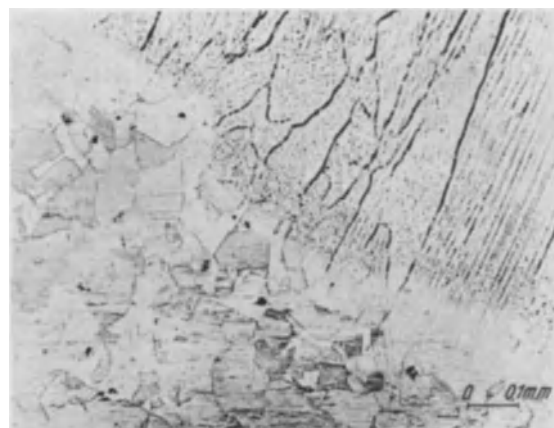
Bild 24. Gute Bindung der Nickel-Schweißung am Nickel-Blech.
