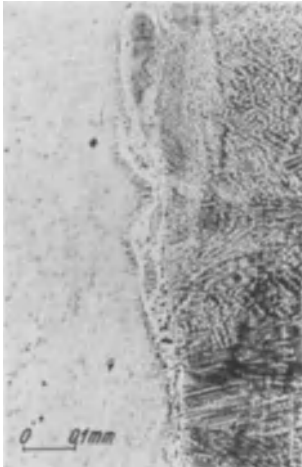
Bild 25. Gute Bindung. Nickelschweiße — Eisenschweiße.
