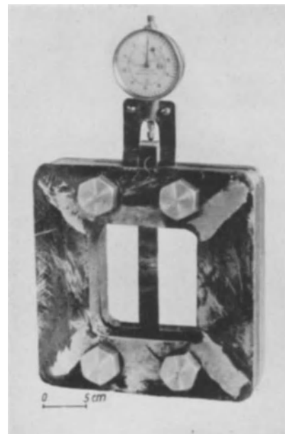
Bild 7. Einspannrahmen von J. Müller zur Bestimmung der Längenänderungen beim Schweißen schmaler Blechstreifen. (Nach J. Müller, Luftfahrtforsch., 11. (1934) 93.)
