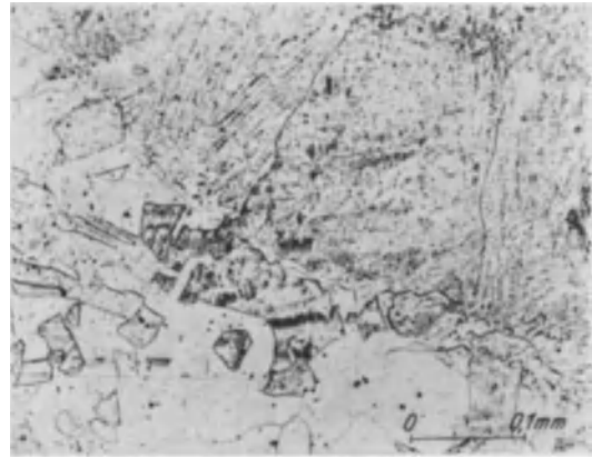
Bild 36. Gute Bindung der Remanit-Schweißung.
