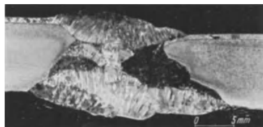
Bild 38. Schnitt durch Kreuznaht (Remanit-Plattierung).
