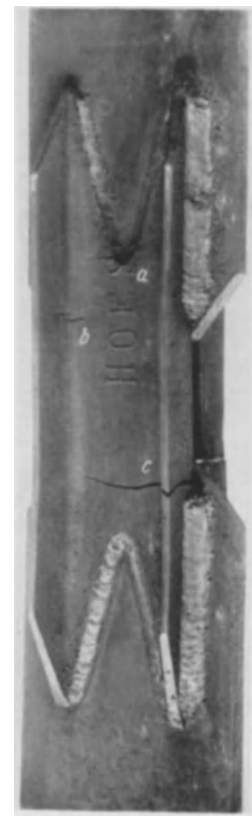
Bild 22. Kehlnahtverbindung mit [-Eisen. Die Enden der [-Eisen sind V-förmig ausgeschnitten. Der Bruch begann bei a, b und c.
