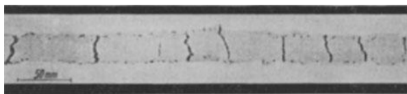
Abb. 6. Schweißnahtzone eines Stabes mit Längsnaht nach dem statischen Zugversuch Stabquerschnitt 220 \times 40 \text{ mm}^2 . Wenig dehnungsfähiges Schweißgut. Schliff parallel zur Nahtoberfläche
