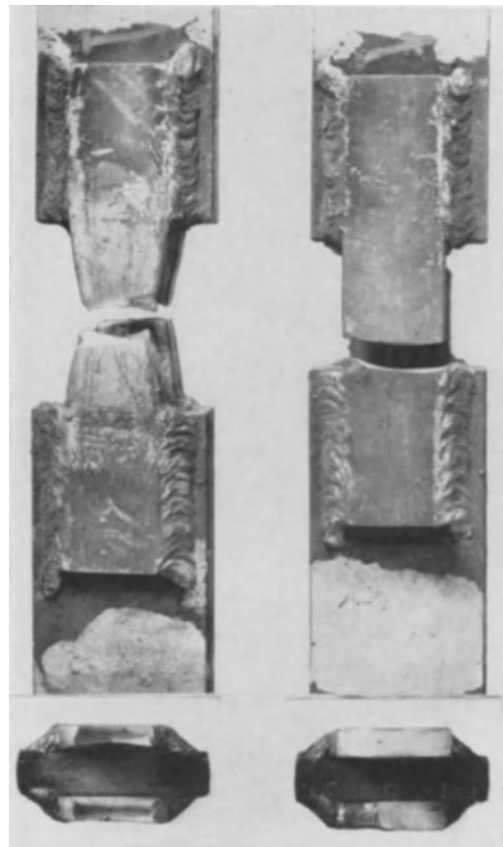
Bilder 1a und 1b. Kehlnahtverbindungen; Probe in Bild 1a bei zügiger Belastung, Probe in Bild 1b unter oftmals wiederkehrenden Lasten geprüft.
