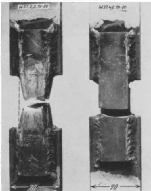
Bild 10. Zugversuch mit einer Schweißverbindung aus St 37 mit Flankenkehlnähten.
