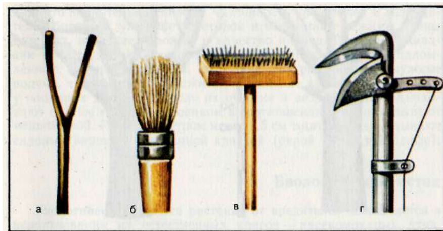
Рис. 3. Приспособления для снятия с деревьев гнезд вредителей: а — рогатка; б, в — щетки; г — воздушный секатор
