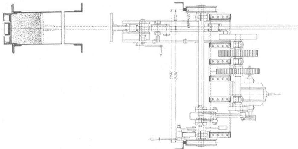
freien Falles des Stampfers erst ein, wenn dieser in der Ruhelage sich befindet. Die Maschine besitzt gleichfalls zwei Stampfer; der Antrieb ist für beide gleich. Durch Versetzung der Kurbelscheiben um  $90^{\circ}$  gegen-
