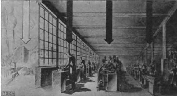
Abb. 52. Abstand vom Fenster und Beleuchtungsstärke
