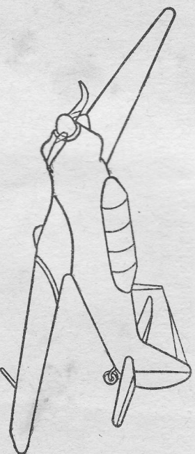
Фиг. 1. Общий вид самолета, совершившего посадку с убранным шасси.
