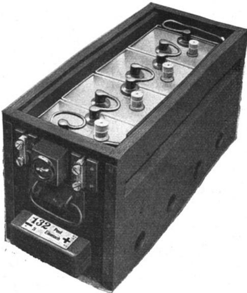
Abb. 19. Batteriekasten für Postwagenbeleuchtung, Deutsche Reichspost.
