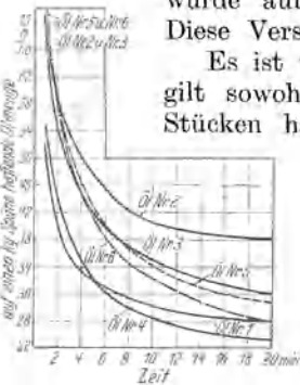
Abb. 28. Abtropffähigkeit verschiedener Schneidöle.
