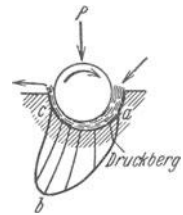
Abb. 9a. Druckberg bei einem Traglager.
