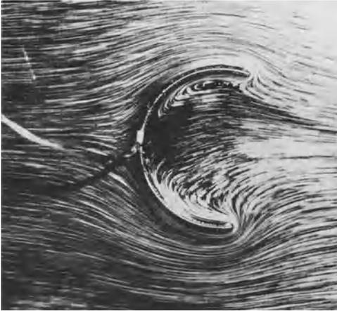
Abb. 44. Umströmung eines offenen Halbkreises (reibungsflos).
