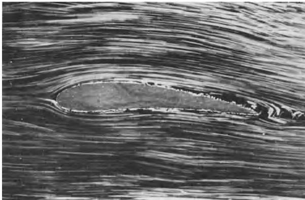
Abb. 32. Anliegende Tragflächenströmung.
