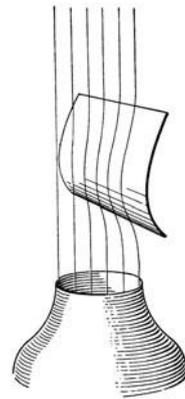
Abb. 66. Ansaugen einer gewölbten Platte durch den Luftstrom.
