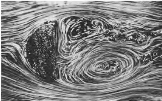
Abb. 29. Strömung um einen Halbzylinder.
