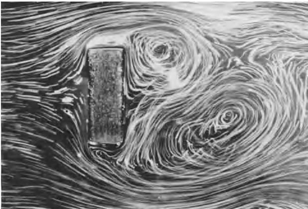
Abb. 30. Umströmung eines rechteckigen Körpers.
