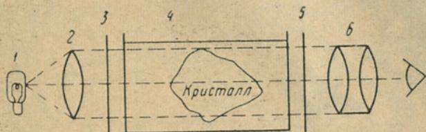
Рис. 1-6. Схема полярископа.
