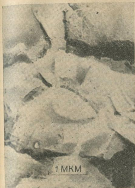
Рис. 2-18. Электронно-микроскопический снимок поверхности кварца, подвергнутого нагреванию до  $550^{\circ}\text{C}$ .
