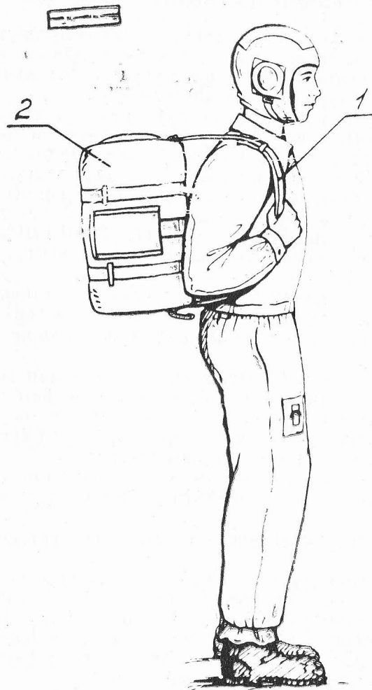
Рис. 36. Переноска грузового контейнера: 1 — переносные ремни; 2 — грузовой контейнер ГК-30-У
