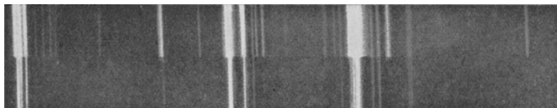
Abb. 9. Polarisation des Ramanspektrums von \text{CCl}_4 .
