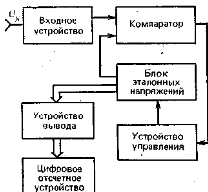
Рис. 8. Структурная схема вольтметра с поразрядным уравниванием
