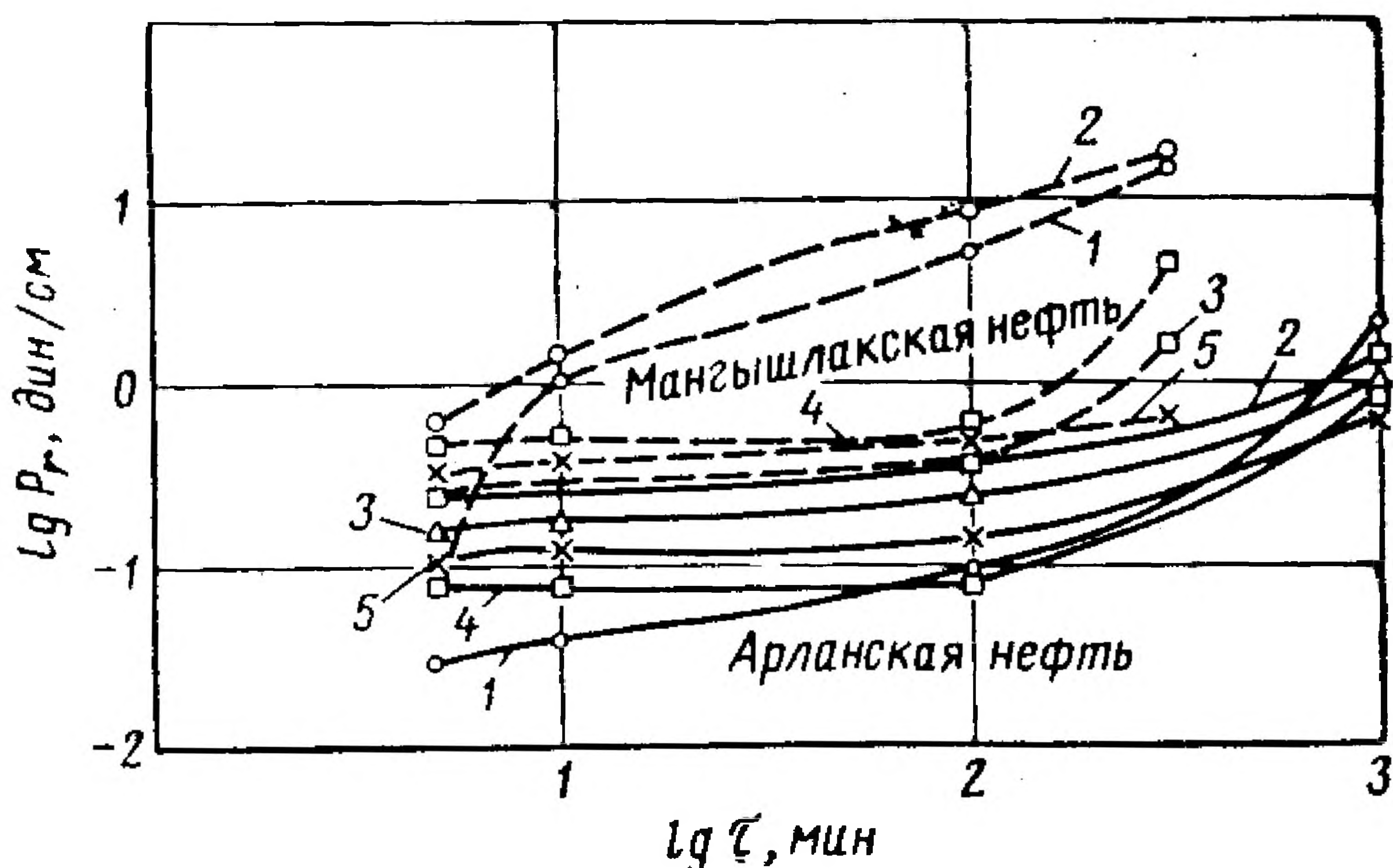
Рис. 7. Влияние концентрации деэмульгатора диссольтвана 4411 на механическую прочность слоя арланской и мангышлакской нефтей:
