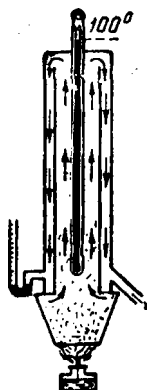
Фиг. 42. Определение точки кипения ( 100^{\circ} C) на термометре.
