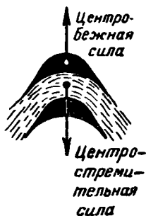
Фиг. 93. Центростремительная и центробежная силы при движении пара между лопатками.
