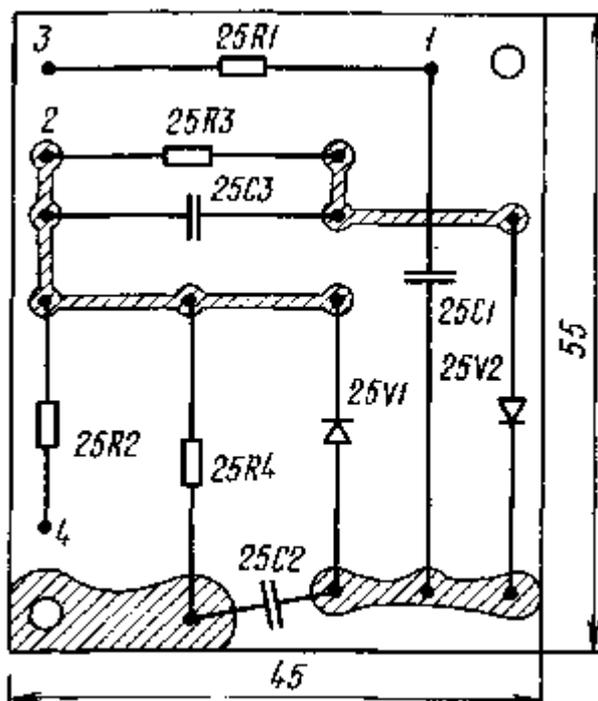
Рис. 2.22. Плата узла автоматической регулировки сигнала
