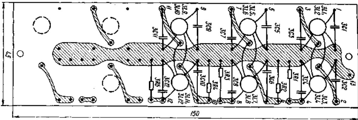
Рис. 1.19. Плата полосовых фильтров частоты сигнала
