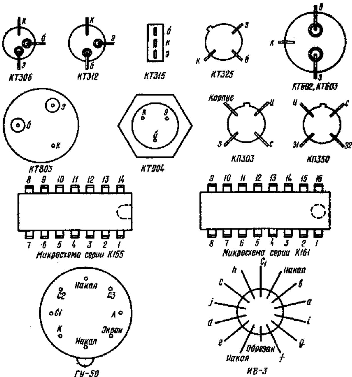
Цоколевки транзисторов, микросхем и электровакуумных приборов, примененных в радиостанции
