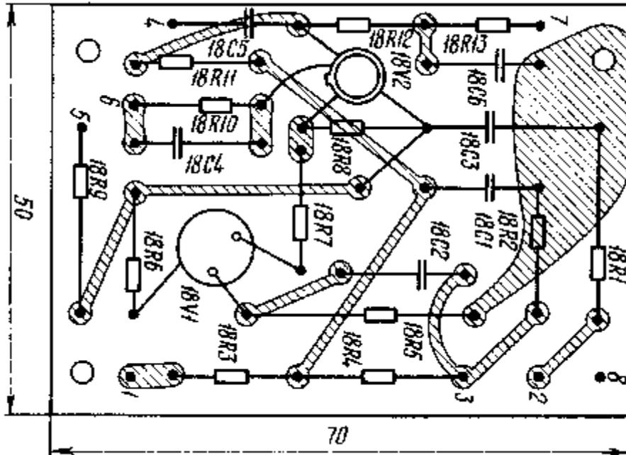
Рис. 2.11. Плата предварительного усилителя мощности передатчика
