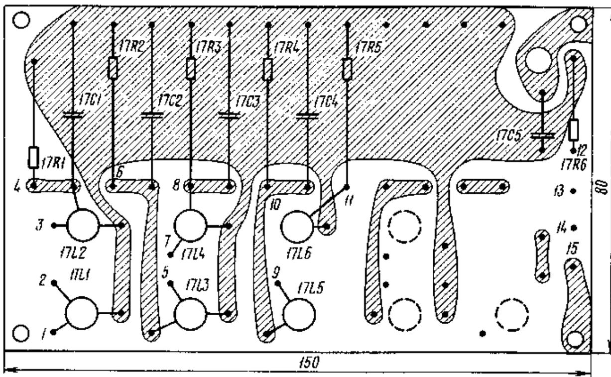
Рис. 2.10. Плата согласующих фильтров частоты сигнала
