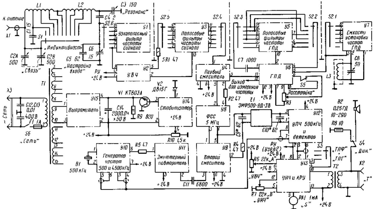
Рис. 1.1. Принципиальная электрическая схема приемника
