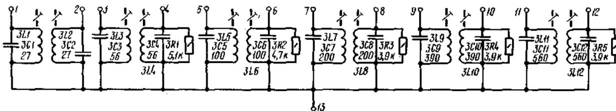
Рис. 1.4. Принципиальная электрическая схема полосовых фильтров частоты сигнала
