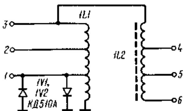
Рис. 1.2. Принципиальная электрическая схема узкополосного фильтра частоты сигнала
