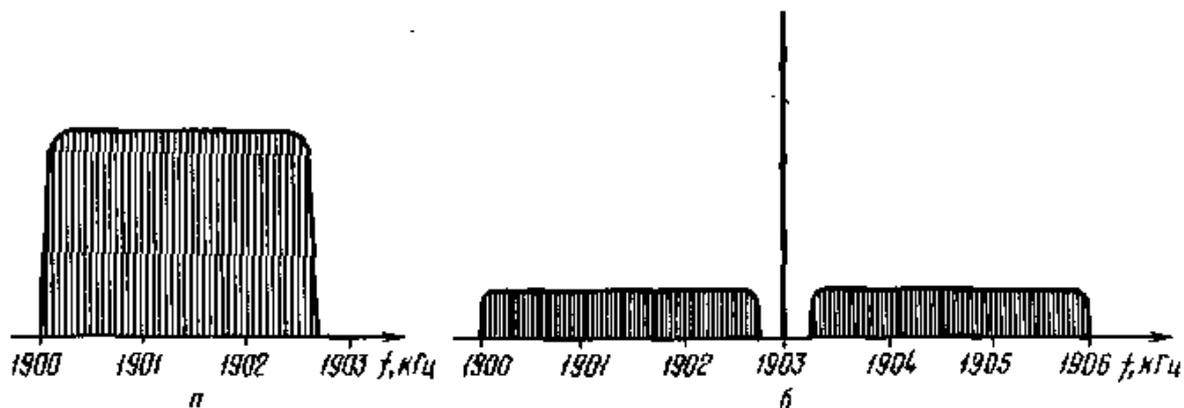
**Рис. 2.16. Спектры сигналов однополосного передатчика а и передатчика с амплитудной модуляцией б при одинаковой максимальной мощности**
