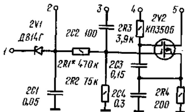
Рис. 1.3. Принципиальная электрическая схема УВЧ
