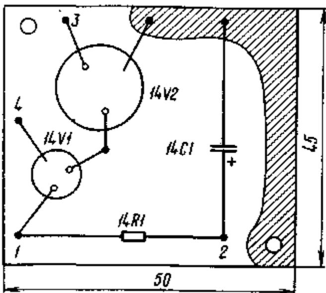
Рис. 1.29. Плата стабилизатора +24 В
