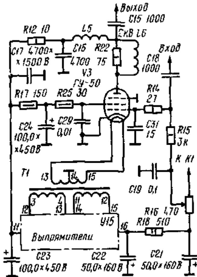
Рис. 2.3. Принципиальная электрическая схема выходного каскада усилителя мощности
