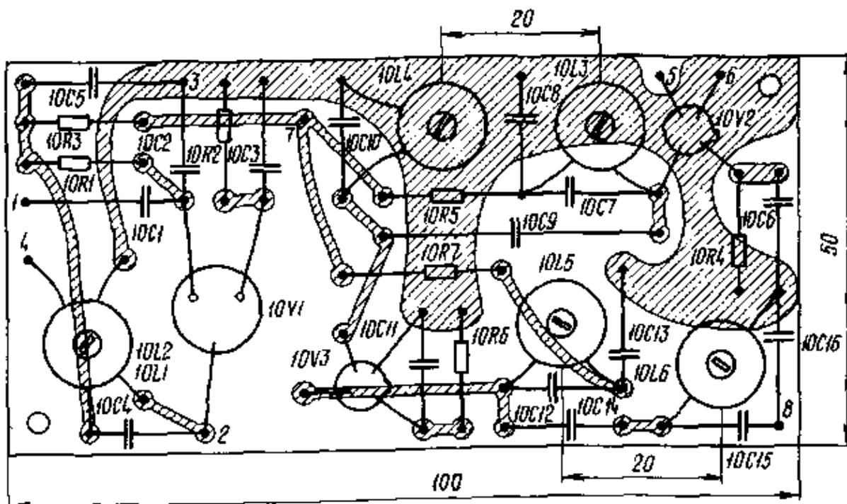
Рис. 1.25. Плата генератора частот 500 и 4500 кГц
