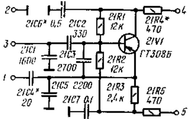
Рис. 2.7. Принципиальная электрическая схема узла генератора 500 кГц С1Г
