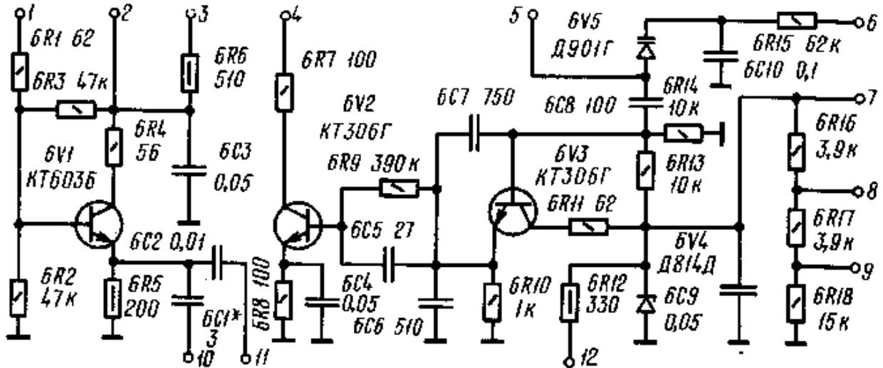
Рис. 1.7. Принципиальная электрическая схема ГПД
