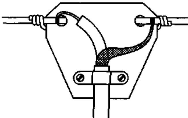
**Рис. 3.4. Подключение кабеля к диполю**
