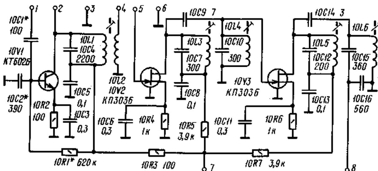
Рис. 1.10. Принципиальная электрическая схема генератора частот 500 и 4500 кГц
