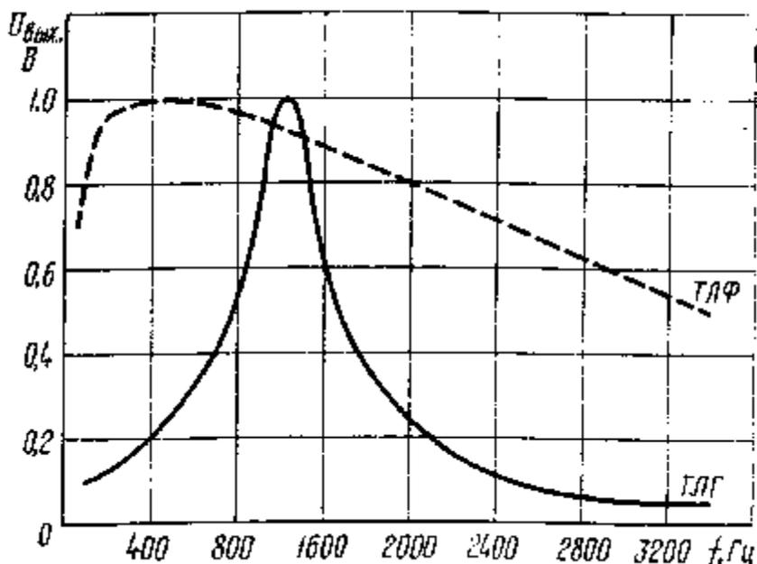
Рис. 1.31. Частотные характеристики УНЧ
