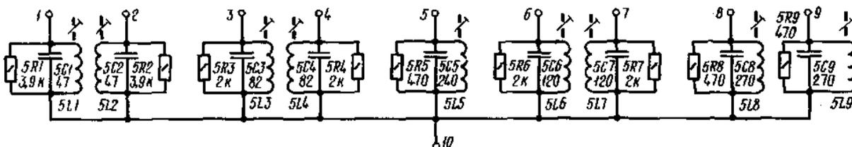
Рис. 1.5. Принципиальная электрическая схема полосовых фильтров частоты ГПД
