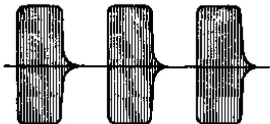
Рис. 2.15. Телеграфный сигнал на выходе ЭМФ
