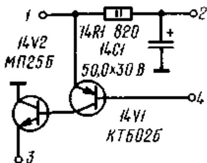
Рис. 1.14. Принципиальная электрическая схема узла стабилизатора + 24 В
