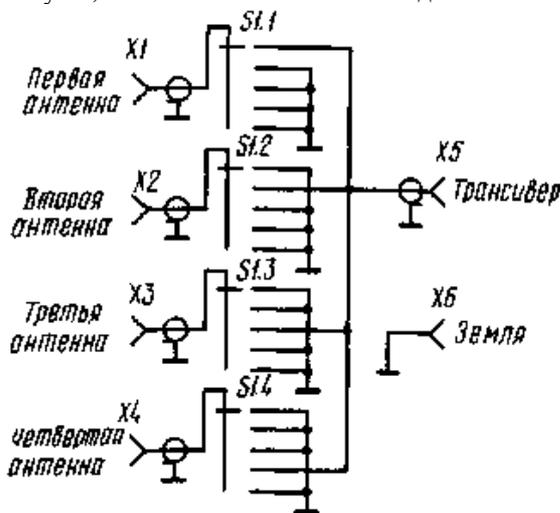
Рис. 3.12. Принципиальная электрическая схема антенного коммутатора
