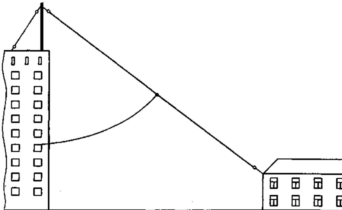
Рис. 3.3. Полуволновый диполь на 160 м
