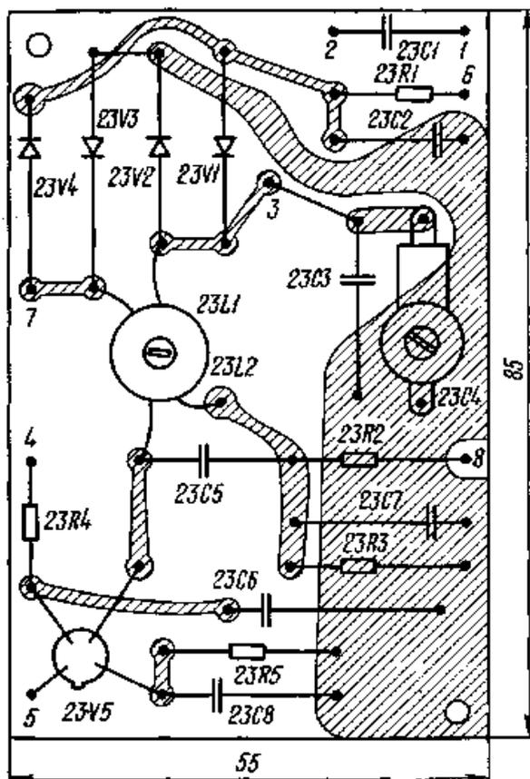
Рис. 2.20. Плата генератора 500 кГц DSB
