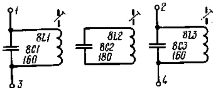
Рис. 1.9. Принципиальная электрическая схема ФСС 5 МГц
