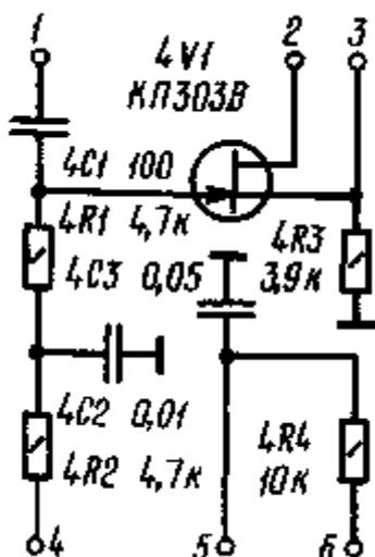
Рис. 1.6. Принципиальная электрическая схема смесителя
