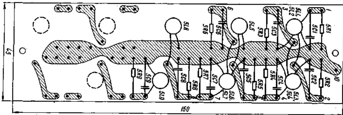
Рис. 1.21. Плата полосовых фильтров частоты ГПД
