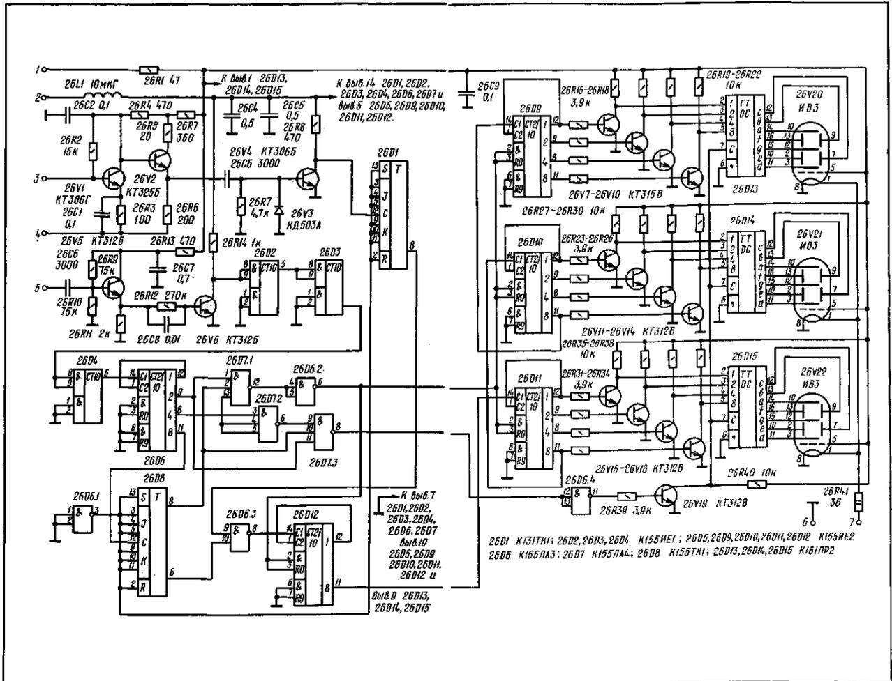
Рис. 2.24. Принципиальная электрическая схема цифровой шкалы
