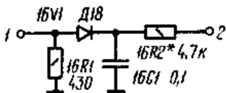
Рис. 2.2. Принципиальная электрическая схема детектора напряжений в антенне
