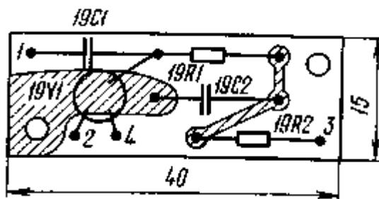
Рис. 2.12. Плата смесителей передатчика
