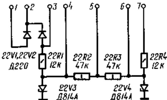
Рис. 2.8. Принципиальная электрическая схема узла переключения «Прием — Передача»
