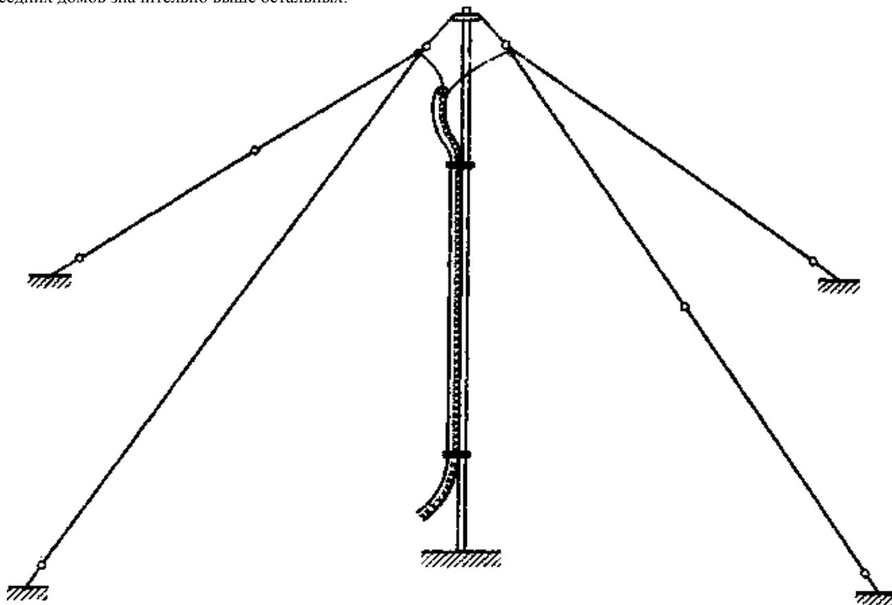
Рис. 3.7. Антенна «Inverted V» на 2 диапазона Антенна «треугольник»
