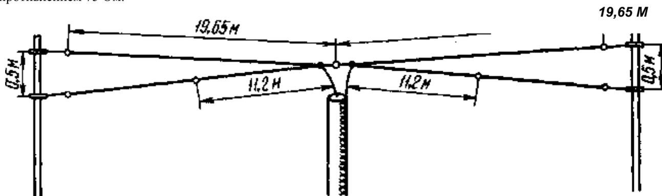
Рис. 3.6. Сдвоенный диполь для работы на диапазонах 40 и 80 м
