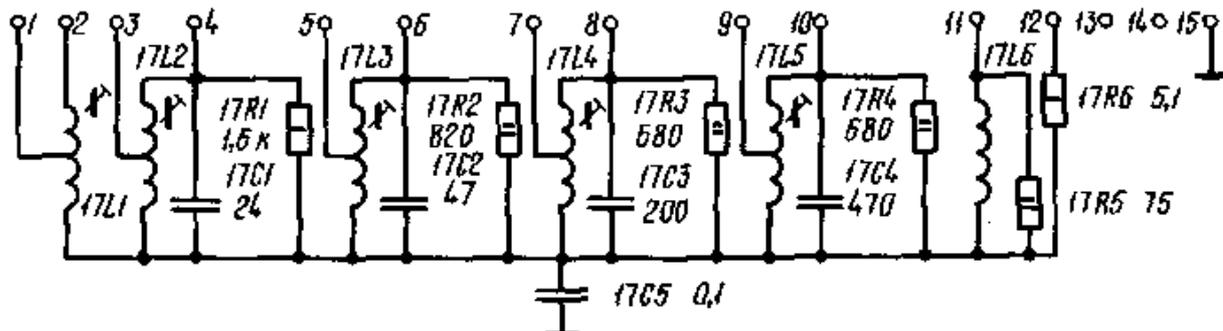
Рис. 2.4. Принципиальная электрическая схема согласующих фильтров частоты сигнала
