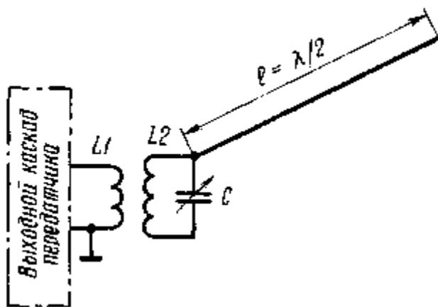
Рис. 3.2. Пример нерациональной схемы подключения антенны
