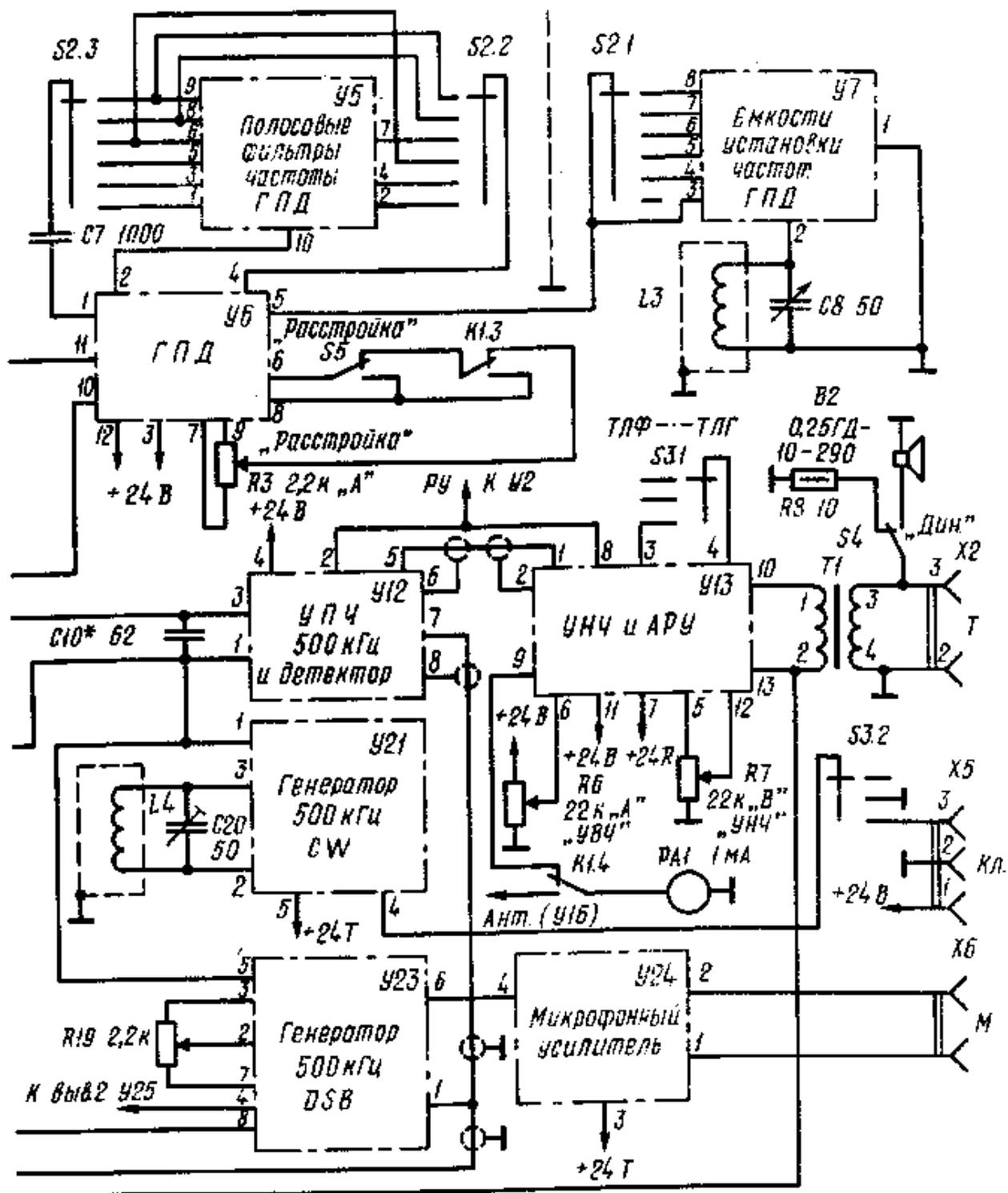
Рис. 2.1. Принципиальная электрическая схема трансивера
