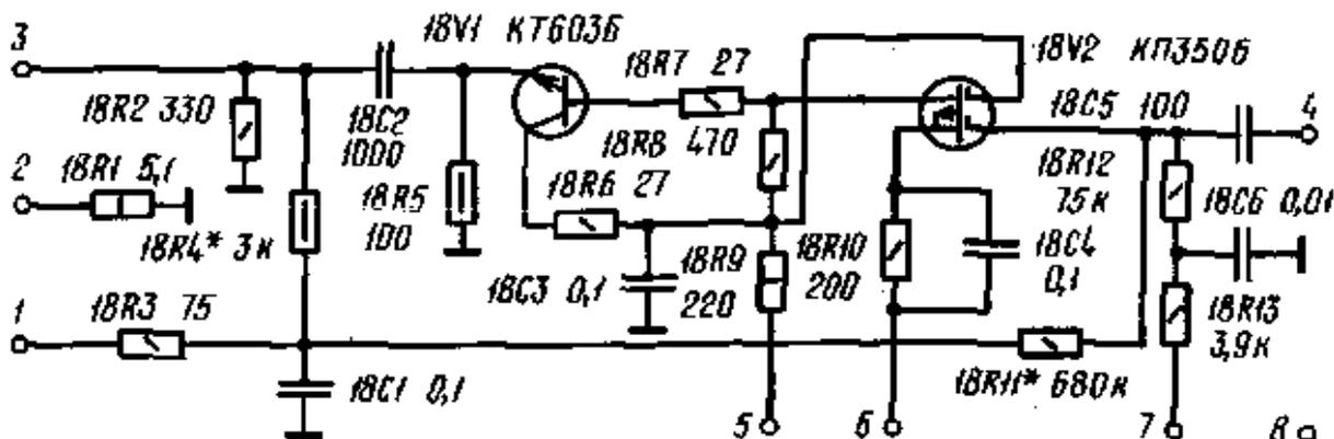
Рис. 2.5. Принципиальная электрическая схема предварительного усилителя мощности передатчика
