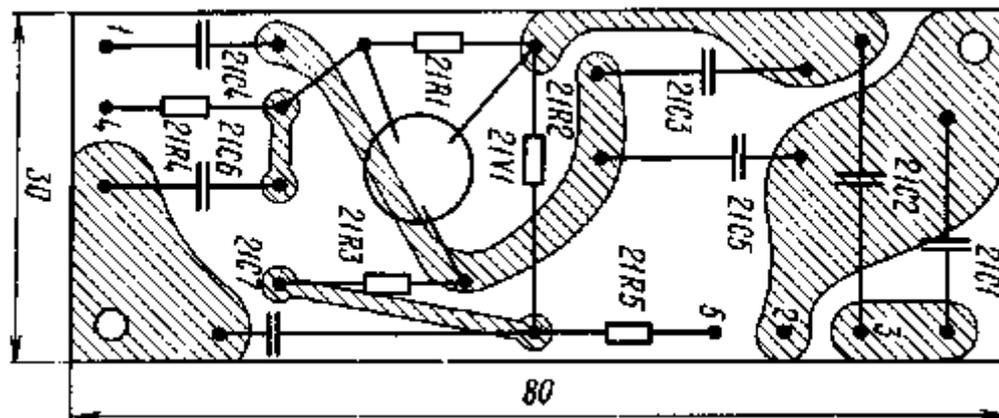
Рис. 2.13. Плата генератора 500 кГц CW
