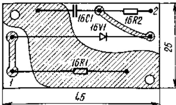
Рис. 2.9. Плата детектора напряжения в антенне
