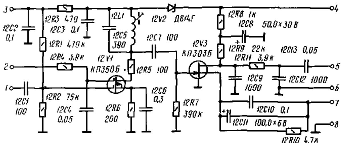
Рис. 1.12. Принципиальная электрическая схема УПЧ 500 кГц и детектора
