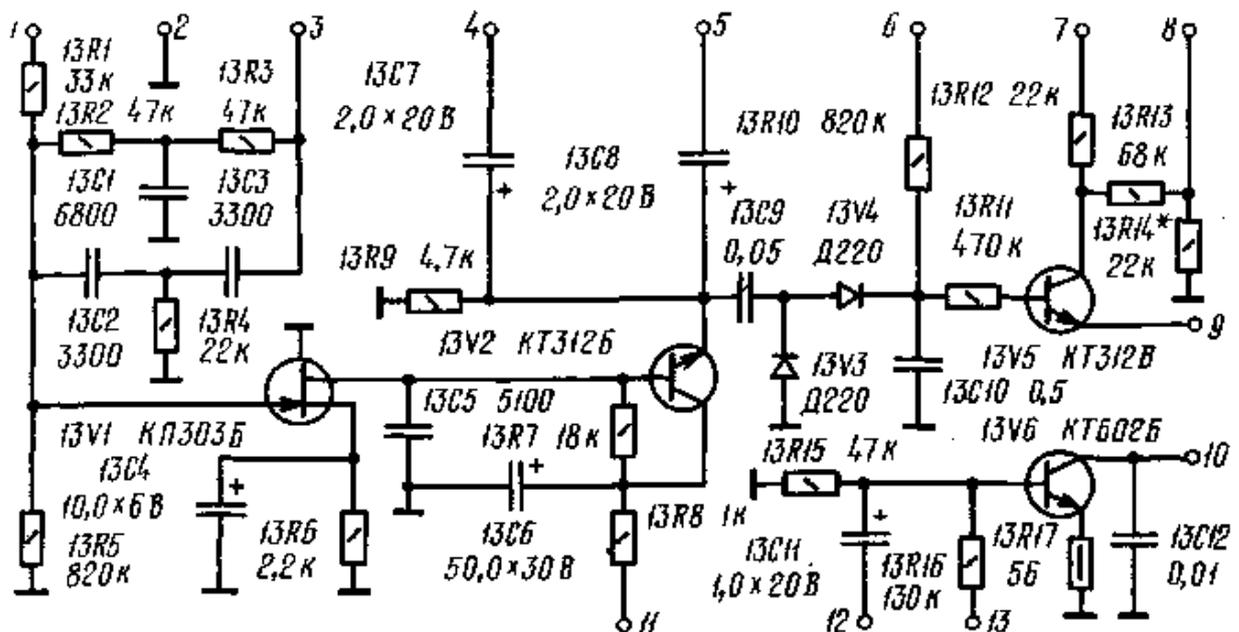
Рис. 1.13. Принципиальная электрическая схема УНЧ и АРУ
