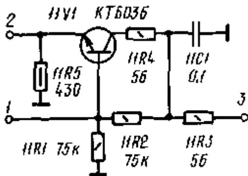
Рис. 1.11. Принципиальная электрическая схема эмиттерного повторителя
