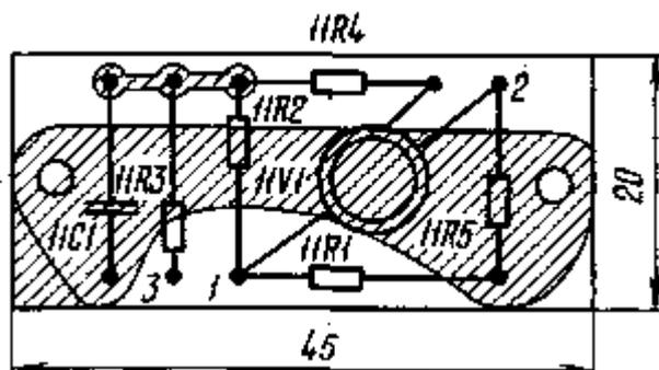
Рис. 1.26. Плата эмиттерного повторителя
