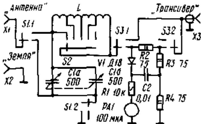
Рис. 3.5. Согласующее устройство для антенны «наклонный луч» на 160 м
