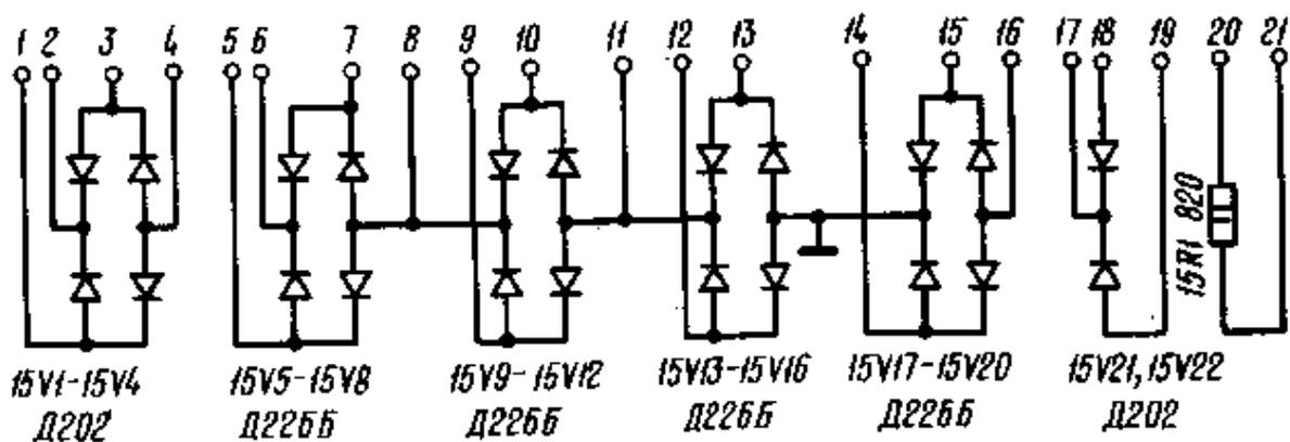
Рис. 1.15. Принципиальная электрическая схема выпрямителя
