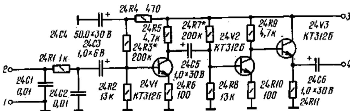
Рис. 2.17. Принципиальная электрическая схема микрофонного усилителя
