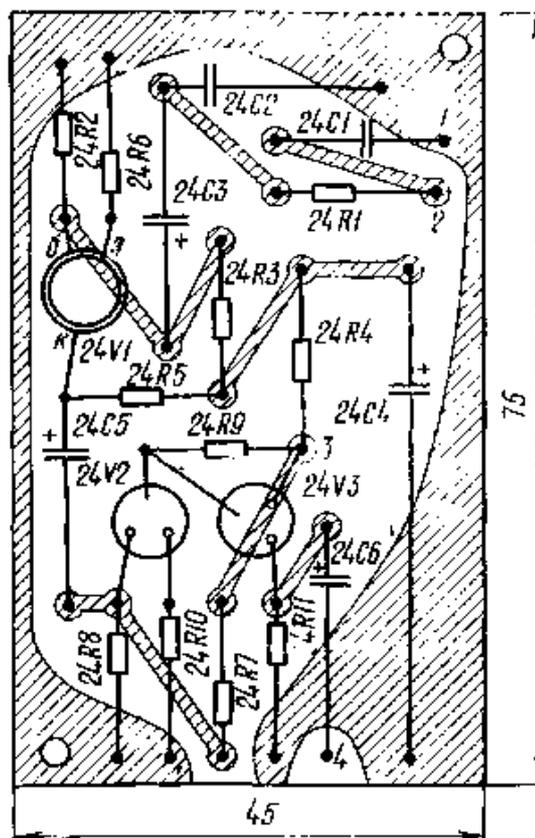
Рис. 2.21. Плата микрофонного усилителя
