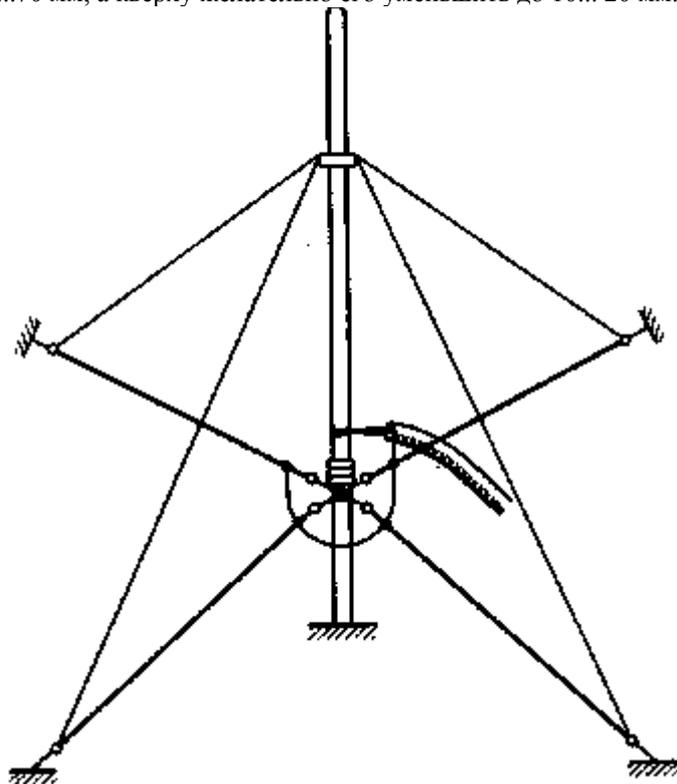
**Рис. 3.9. Антенна «Ground plane»**
