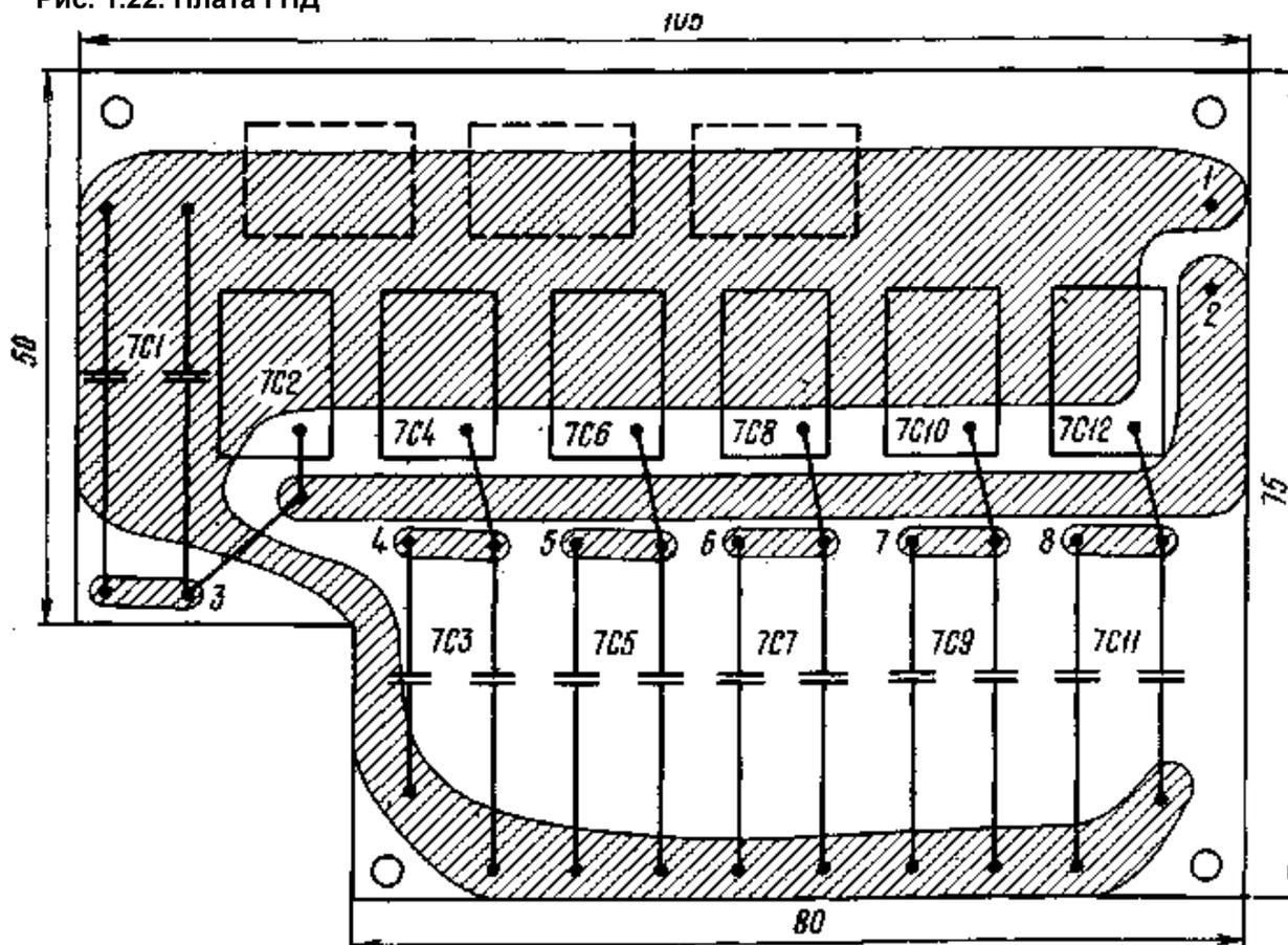
Рис. 1.23. Плата емкостей установки частот ГПД
