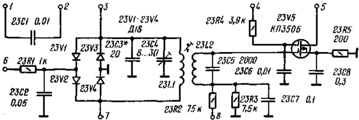
Рис. 2.18. Принципиальная электрическая схема генератора 500 кГц DSB
