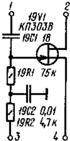
Рис. 2.6. Принципиальная электрическая схема смесителя передатчика
