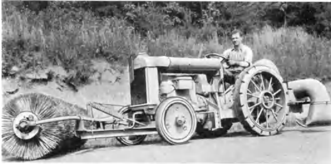
Abb. 75. Zugmaschine mit Kehrwalzen (rotary broom) und Gebläse (blower) zur Beseitigung aller losen Bestandteile auf der Straßendecke [E 8].
