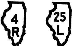
Abb. 36. Nummernschild einer Staatsstraße in Illinois, entsprechend der Form der geographischen Gestalt des Staates mit Angabe einer folgenden Rechts- oder Linkskurve [E 7].
