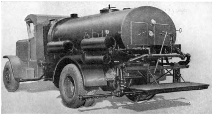
Abb. 96. Drucksprengwagen der Fa. Hvaß & Co. in New York mit vorn angeordneter Druckpumpe [D 37].
