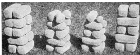
Abb. 187. Klinker nach der Abnutzungsprüfung. Das Abnutzungsverhältnis der beiden äußeren Haufen ist 16%, die Klinker haben sich in 4½jähriger Liegezeit bewährt. Das Abnutzungsverhältnis der beiden mittleren Haufen ist 30,7% und 47,7%, die Klinker haben sich in derselben Liegezeit nicht bewährt [A 20].
