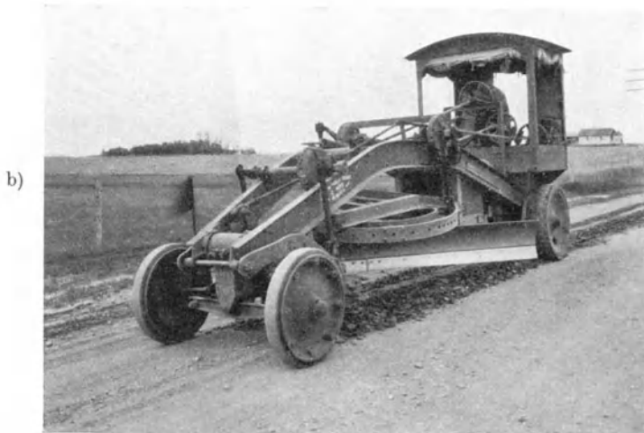
Abb. 56. Planiermaschine (grading machine oder blade grader) der Firma J. D. Adams Comp., Indianapolis, Ind. a) für Pferde- und Traktorenzug [D 3], b) mit Motorentrieb (auf einer Kiesstraße) [E 2].
