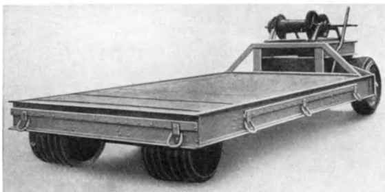
Abb. 118. Anhänger zur Beförderung von schweren Straßenbaumaschinen [D 37].
