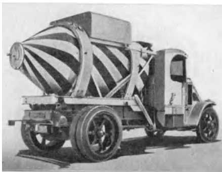
Abb. 150. Transportwagen für Beton mit beweglichem Behälter [D 46].
