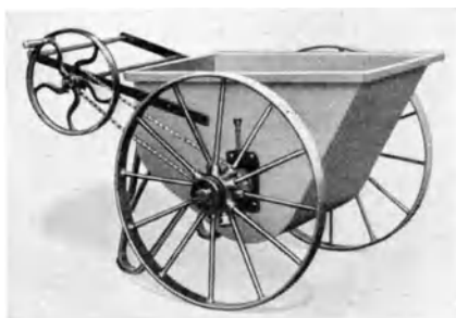
Abb. 116. Mischer mit Handbetrieb für kleine Ausbesserungsarbeiten an Bitumendecken [D 43].
