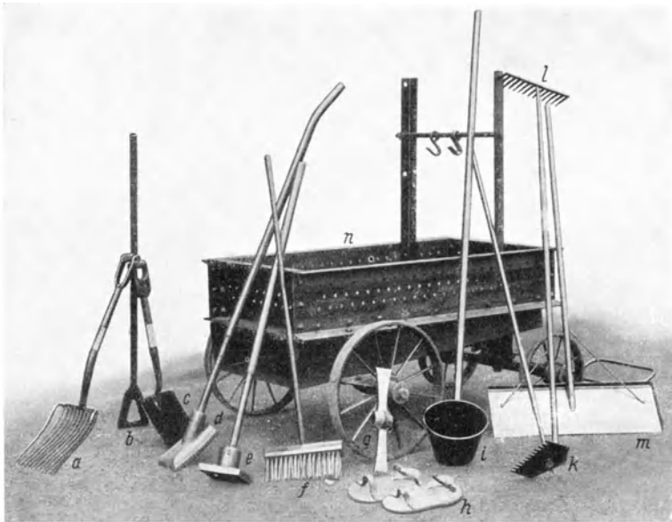
Abb. 85. Handgeräte mit Wärmewagen für Bitumendecken. a = Gabel, b = Rührreisen, c = Schaufel, d = Glätteisen, e = Stampfer, f = Besen, g = Hacke, h = Asphaltsandalen, i = Schöpfer, k = Kratzer, l = Rechen, m = Verteilungsblech, n = Heizwagen [D 26].
