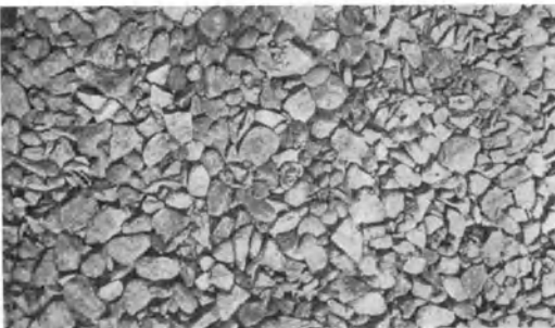
Abb. 125. Tränkmakadam, Aufsicht auf die Gesteinslage. a) in guter Zusammensetzung, b) in ungeeigneter Zusammensetzung, aber entsprechend natürlichem Anfall [D 15].
