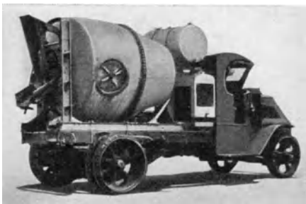
Abb. 152. Betonmischer, aufmontiert auf einem Transportwagen (truck mixer) [D 46].
