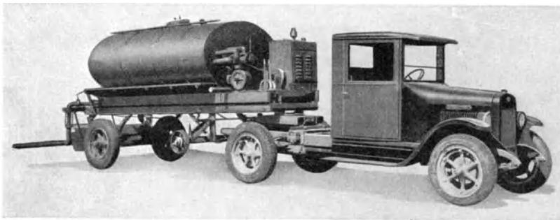
Abb. 97. Drucksprengwagen der Fa. W. Rosholt Comp. in Minneapolis, Minnesota, als Anhänger eines Sattelschleppers mit vorn angeordneter Druckpumpe [D 60].
