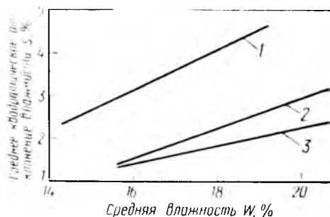
Рис. 54. Зависимости среднего квадратического отклонения влажности от средней влажности партии пиломатериалов толщиной, мм: 1 — 22...25; 2 — 32...47; 3 — 50...75
