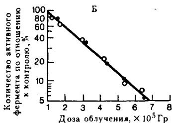
Рис. III—1. Инактивация РНКазы рентгеновскими лучами. Ферментативная активность определялась с помощью двух различных субстратов: 1 — ДНК; 2 — цитидин-2',3'-циклофосфата (по Юнгу и Дертингеру, 1973); А — зависимость «доза — эффект» выражена в линейных координатах; Б — эти же данные представлены в полулогарифмических координатах, экспериментальные точки укладываются на прямую
