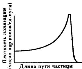
Рис. 1—9. Изменение линейной плотности ионизации при прохождении ускоренной заряженной частицы через вещество
