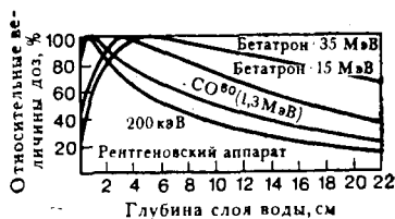
Рис. I—14. Кривые поглощения энергии в воде для рентгеновского и \gamma -излучения с разной энергией квантов (по Линденбрантену, 1969)
