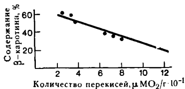
Рис. VI—19. Радиолиз β-каротина, растворенного в олеиновой кислоте, в зависимости от содержания перекисей в растворе (по Кудряшову и Балтбарздысу, 1966, 1967).
