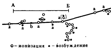
Рис. 1—10. Передача энергии по траектории тяжелой заряженной частицы (по Полларду, 1964). Для \alpha -частицы с энергией 6 МэВ расстояние АБ=31 А, что соответствует толщине средней молекулы белка: а — «рой ионов»; а (б) — \delta -излучение
