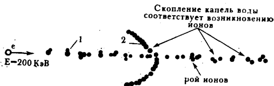
Рис. 1—12. Трек быстрого электрона (по фотографии в камере Вильсона): 1 — трек быстрого электрона ( E \approx 200 КэВ), 2 — трек медленных электронов ( E \approx 20 КэВ). При низкой энергии изгибание трека вызвано рассеянием (по Баку и Александеру)
