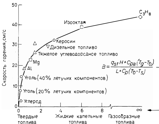
Рис. 5.6. Скорости ламинарного горения топливно-воздушных смесей, когда распространение пламени контролируется физическими процессами ( d = 30 мкм, p_0 = 1 бар, T = 290 К, \varphi = 1 ) [270].
