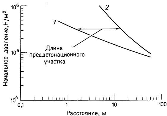
Рис. 5.12. Влияние начального давления на длину преддетонационного участка при детонации чистого ацетилена в замкнутом объеме [147].
