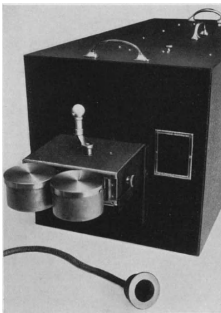
Abb. 250. Film-Aufnahmeeinrichtung mit Handantrieb und Fenster für gleichzeitige Beobachtung der Schwingung im rotierenden Spiegel.
