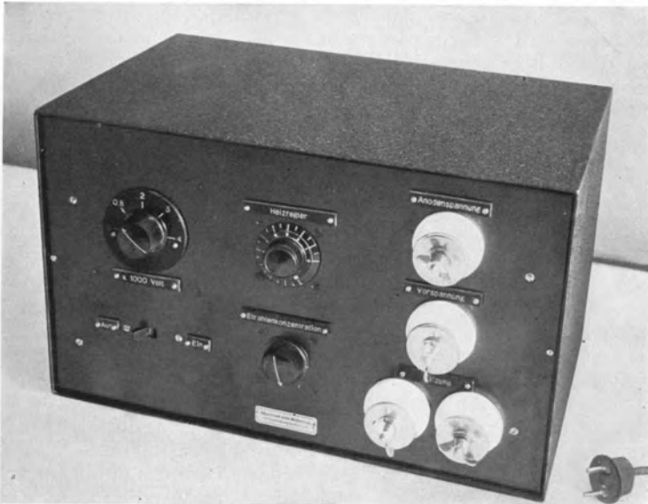
Abb. 152. Großes Netzanschlußgerät für Anodenspannungen bis zu 4000 V.
