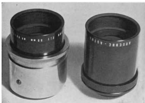
Abb. 244. Spezialoptik für Kathodenstrahloszillographen der Astro-Gesellschaft (geometrisches Öffnungsverhältnis 1 : 1, Brennweite 50 mm).
