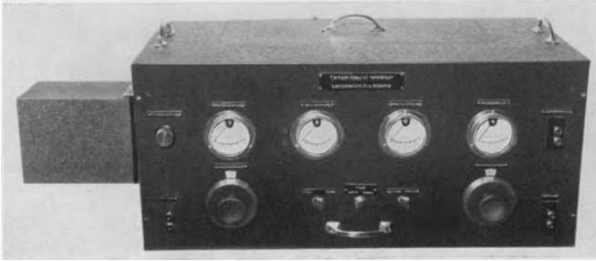
Abb. 161. Ansicht des ausgeführten Modells mit seitlich ansteckbarer erster Stufe.
