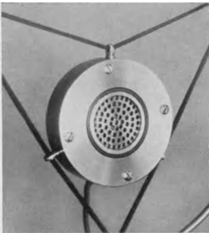
Abb. 183. Modernes Kondensator-Meßmikrophon. (Charlottenburger Motoren - Ges.)
