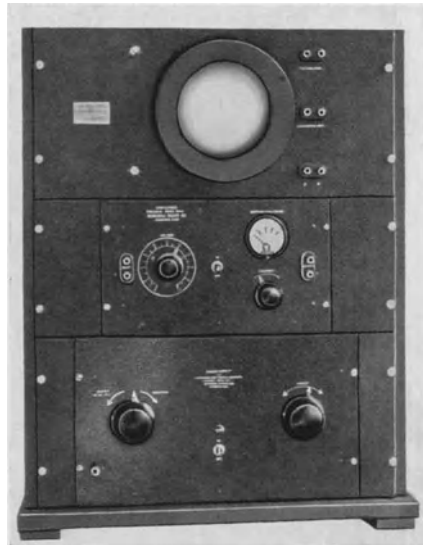
Abb. 266. Einheitliche Apparatur mit leichter Austauschbarkeit der Nebenapparate.
