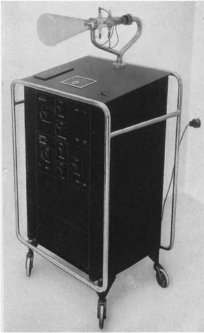
Abb. 269. Fahrbare, aus dem Lichtnetz betriebene Apparatur mit eingebauten Hilfsgeräten (Versuchsapparatur des Verfassers).
