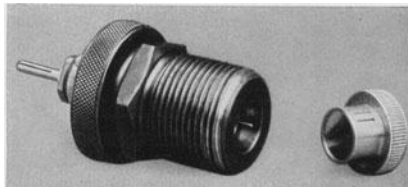
Abb. 384. Piezodruckmikrophon für die Messung von Explosionsdrucken (Zeiss Ikon).
