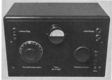
Abb. 155. Außenansicht des eichfähigen Netzverstärkers mit zwei Stufen.
