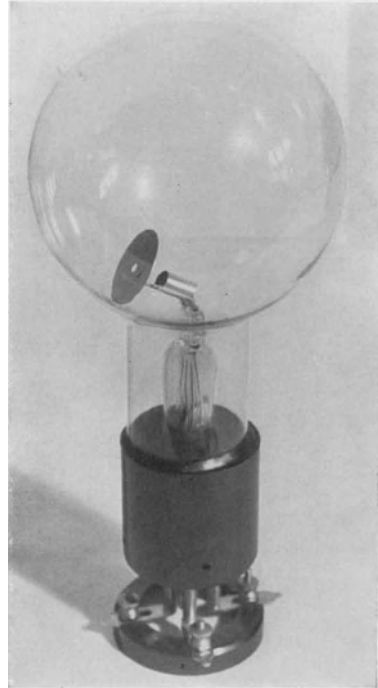
Abb. 286. Ansicht einer Röhre für Bestimmung des Wertes \frac{e}{m} aus der Strahlbahn.
