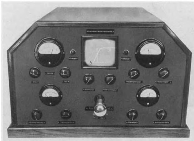
Abb. 298. Außenansicht eines Kennlinienschreibers für die Untersuchung verschiedenster Röhrentypen.
