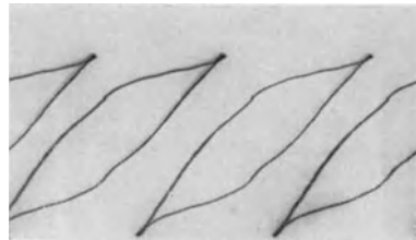
Abb. 382. Oszillographische Untersuchungen über den Einfluß von Zugspannungen auf die magnetischen Eigenschaften von Stahl.
