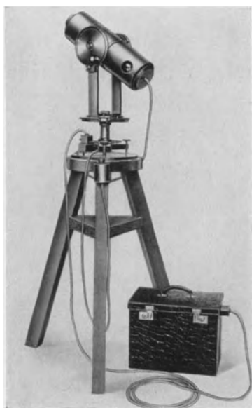
Abb. 281. Elektronenstrahl-Meßgerät zur schnellen Festlegung von Größe und Richtung eines ausgedehnten magnetischen Feldes.
