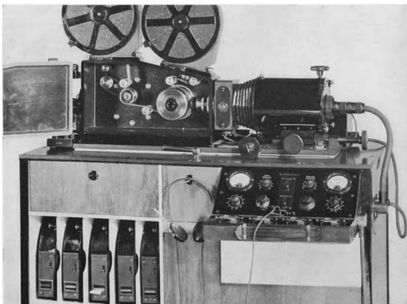
Abb. 401. Fährbare Kathodenstrahl-Aufnahmeeinrichtung der Frieß A. G.
