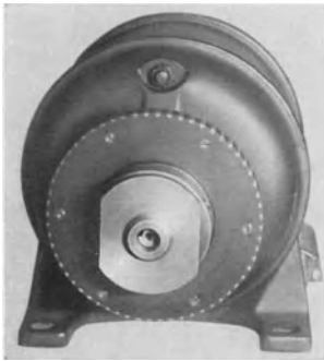
Abb. 421. Kollektor zur mechanischen Erzeugung einer synchronen Zeilenfrequenz.
