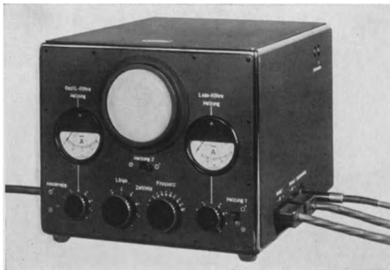
Abb. 268. Gerät für Batteriebetrieb mit Zeitablenkung (AEG).
