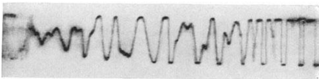
Abb. 303. Oszillogramm einer durch Übersteuerung verzerrten Niederfrequenzschwingung.
