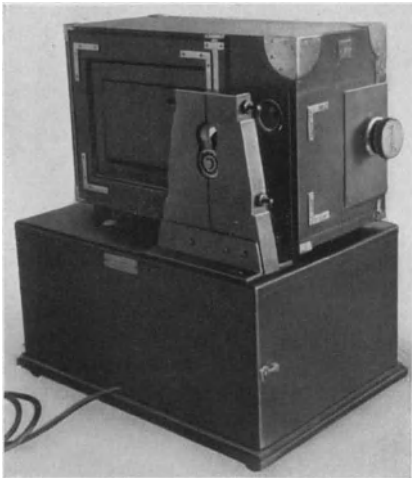
Abb. 252. Große Filmkamera mit Motorantrieb für die Aufnahme langer Oszillogramme.
