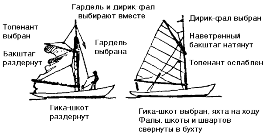
Рис. 164. Постановка гафельного грота
