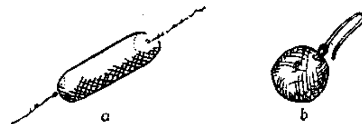
Рис. 158. Виды кранцев: а — удлиненный (валик), б — круглый (шарообразный кранец)
