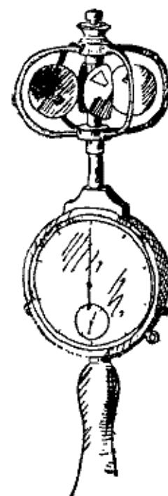
Рис. 181. Прибор для измерения скорости ветра (анемометр)
