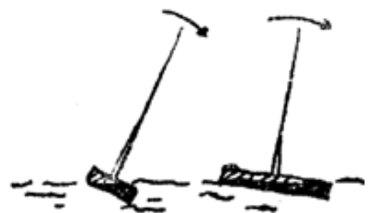
Рис. 6. Низкая и высокая остойчивость формы
