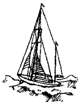
Рис. 71. Штормовое вооружение яхты
