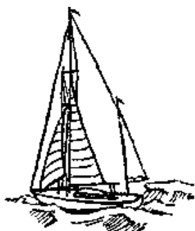
Рис. 70. Вооружение яхты при штормовом ветре
