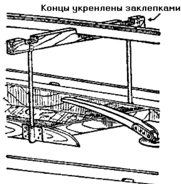
Рис. 254. Постоянно укрепленный сектор гика с деревянной поперечной опорой и трубчатыми стойками. При изготовлении из цельного дерева концы и углы поперечного бруса должны усиливаться заклепками во избежание скалывания
