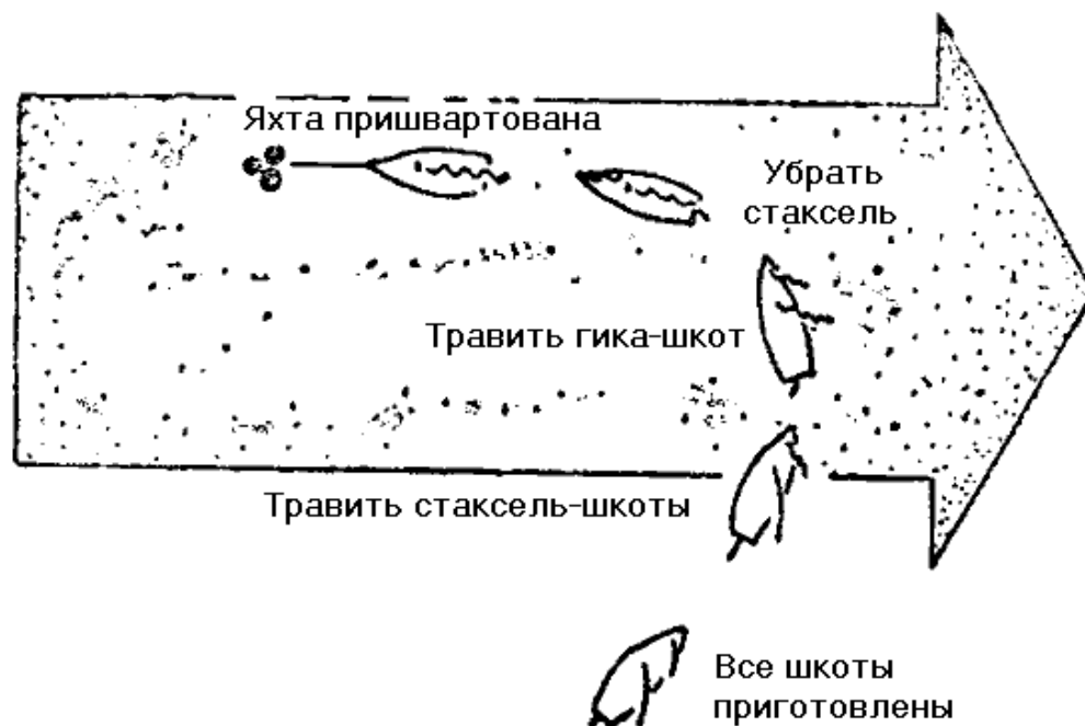
Рис. 165. Приведение к ветру при швартовке
