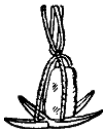
Рис. 263. Якорный камень с деревянными лапами
