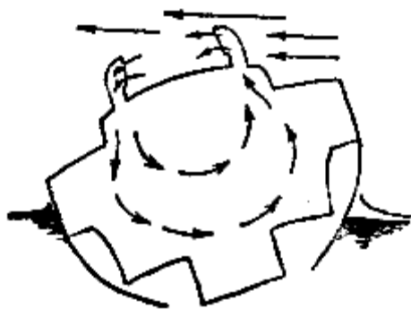
Рис 245 Циркуляция воздуха в каюте на курсе галфвинд (по Хэману)
