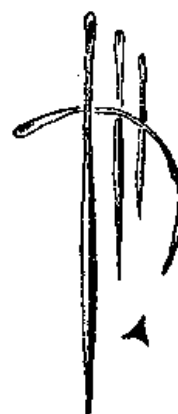
Рис. 98. Различные виды парусных игл и их сечение
