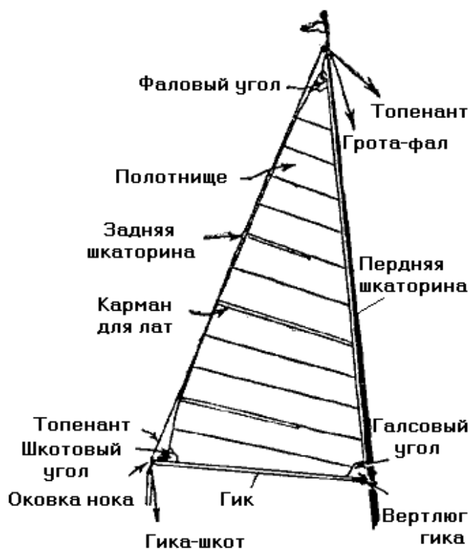
Рис 53 Название частей грота (бермудское вооружение)
