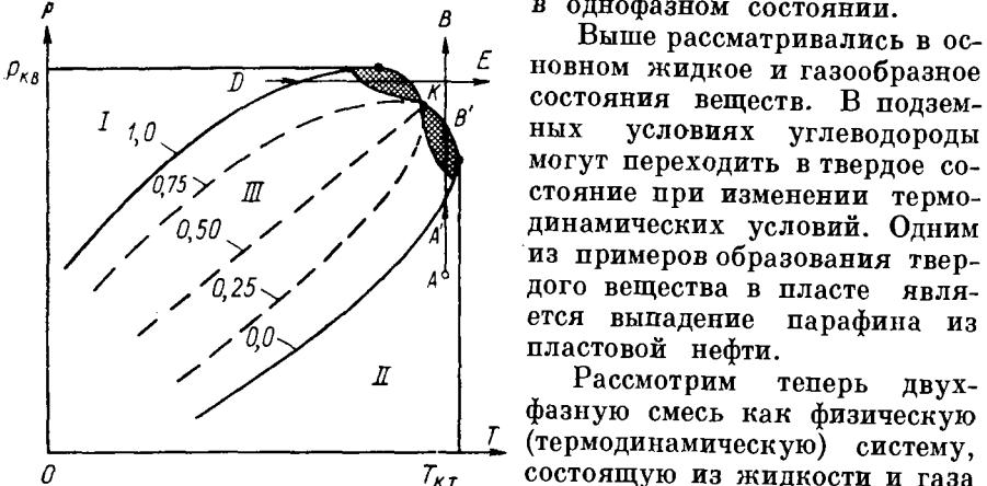
Рис. 30.  $pT$ -диаграмма для двухкомпонентного вещества:
