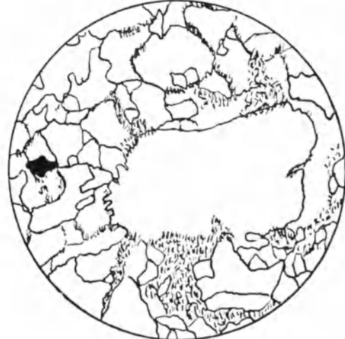
Abb. 5b. Zeichnung des mikroskopischen Schliffs vom Südafrikanischen „Banket“ (Sandsteinbank), den die Abb. 5a der Mikroaufnahme zeigt. Die hellen Felder sind Quarz, die nadelförmigen Fasern sind meistens Sericit. Die schwarze Stelle ist Pyrit.
