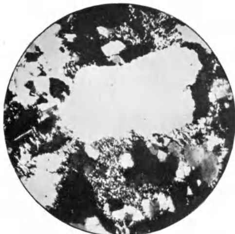
Abb. 5a. Mikroskopischer Schliff des „Banket“, des goldhaltigen Gesteins, welches bei Witwatersrand (Südafrika) bearbeitet wird. (In polarisiertem Licht 30fache Vergrößerung.) Die nadelförmigen Sericitbestandteile liegen in der Gangart zwischen dem Quarzkiesel und den Quarzkörnern.
