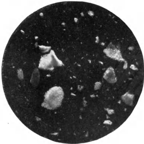
Abb. 4a. Mineralteilchen aus den Rückständen einer silikotischen Kohlenbergmannslunge in polarisiertem Licht. 30fache Vergrößerung.
