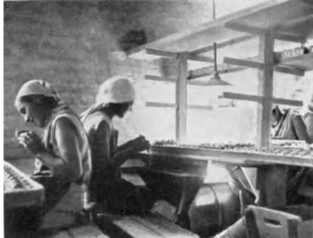
Abb. 3. Verputzen von Stanzporzellan (mit Staubabsaugung nach unten). Ungünstige Arbeitsplatzgestaltung.
