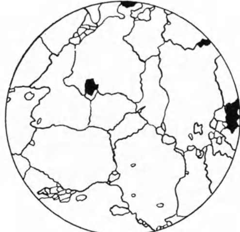
Abb. 6 b. Zeichnung des mikroskopischen Schliffs des goldhaltigen Quarzes von Kolar (Indien), den die Abb. 6 a als Mikroaufnahme zeigt. Die hellen Felder sind Quarz, die schwarzen Flächen Pyrit. Es liegen keine Sericitfasern zwischen den Quarzteilen.
