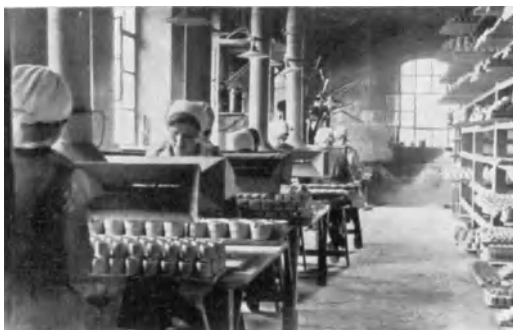
Abb. 5. Verputzen von Stanzporzellan (mit Staubabsaugung nach oben).
