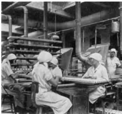
Abb. 4. Verputzen von Stanzporzellan (mit Staubabsaugung nach unten). Gute Arbeitsplatzgestaltung.
