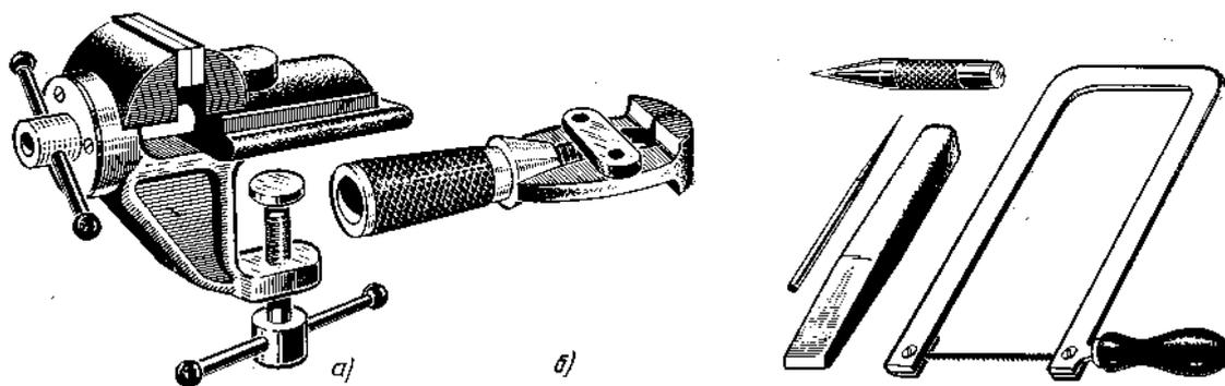
Рис. 30. Тиски слесарные съемные (а) и ручные (б)
