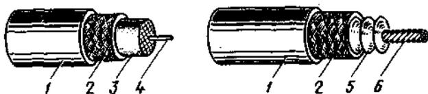
Рис. 3. Конструкция некоторых видов экранированных высокочастотных кабелей: 1 — пластмассовая внешняя изоляция; 2 — оплетка из медной проволоки (экран); 3 — внутренняя диэлектрическая оболочка; 4 — медный провод; 5 — внутренняя изоляция из керамических (или пластмассовых) шайб; 6 — провод из медных проволок
