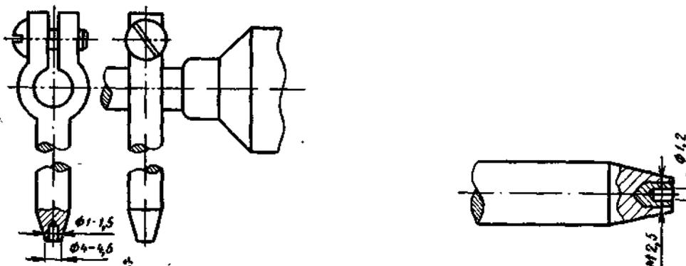
Рис. 12. Съемная насадка для монтажа малогабаритных деталей
