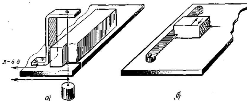
Рис. 32. Приспособления для разрезания термопластических материалов
