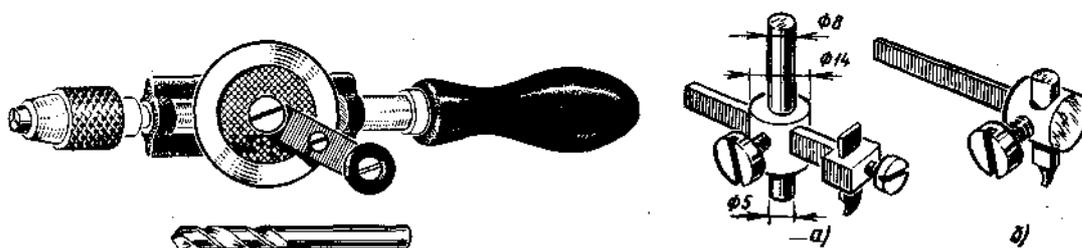
Рис. 28. Дрель ручная и спиральное сверло
