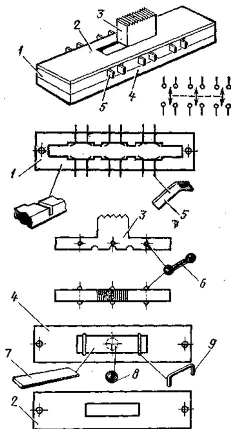
Рис. 43. Самодельный конденсатор переменной емкости
