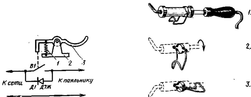
**Рис. 7. Электрическая схема контактно-гасящего устройства подставки паяльника:** 1 — пружина; 2 — опора; 3 — рычаг
