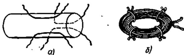
**Рис. 18. Вид оправки (а) готовой бескаркасной катушки (б) для горшкообразного магнитопровода**
