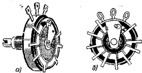
**Рис. 45. Переключатель из переменного резистора СП:**
