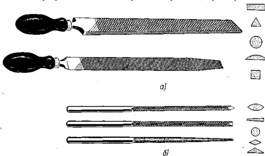
Рис. 27. Напильники (а) и надфили (б) разной формы
