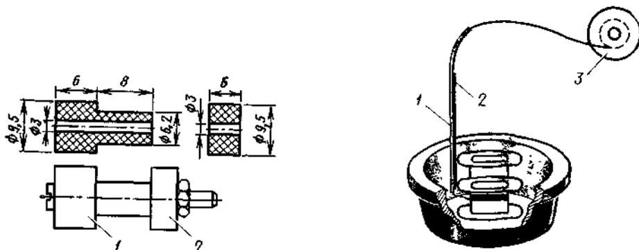
**Рис. 19. Разборная оправка для намотки бескаркасной катушки**
