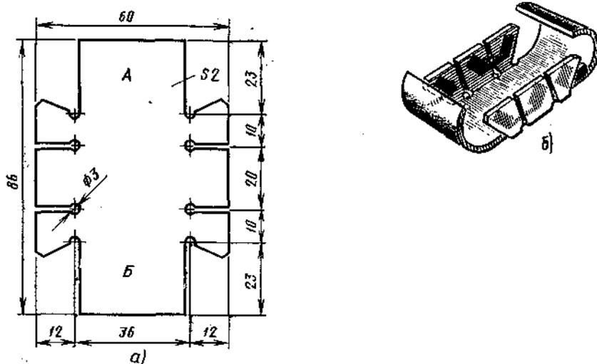
Рис. 51. Развертка (а) и внешний вид (б) обоймы для трех элементов 332 (размеры для справок)
