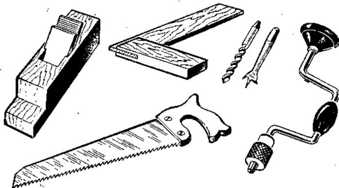
**Рис. 33. Инструменты для обработки древесины: рубанок, угольник, спиральное сверло, перовое сверло, коловорот и ножовка по древесине**
