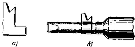
**Рис. 9. Приспособление для снятия по-ливинилхлоридной или полиэтиленовой изоляции с монтажных проводов: в — «флажок»; б — крепление «флажка» к жалу паяльника**
