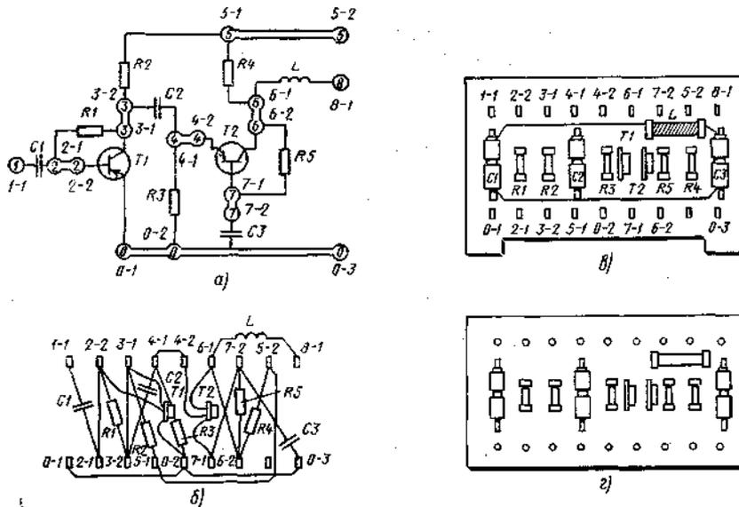
Рис. 38. Последовательное преобразование принципиальной схемы устройства (а) в монтажную (б) и эскизы монтажа на лепестках (в) и на плате с пистонами (е)
