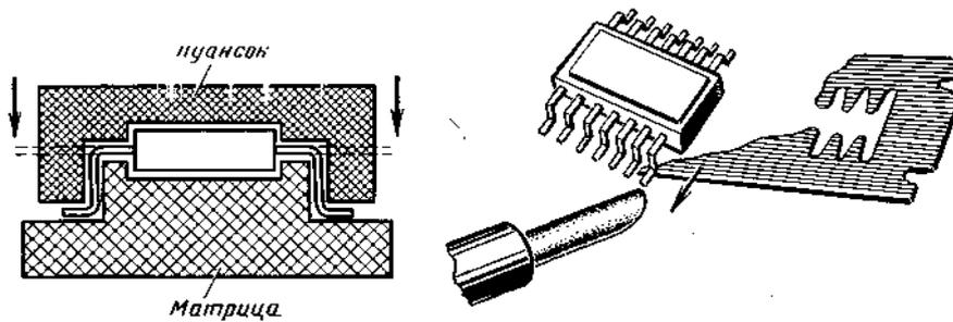
Рис. 23. Приспособление для формования выводов микросхемы
