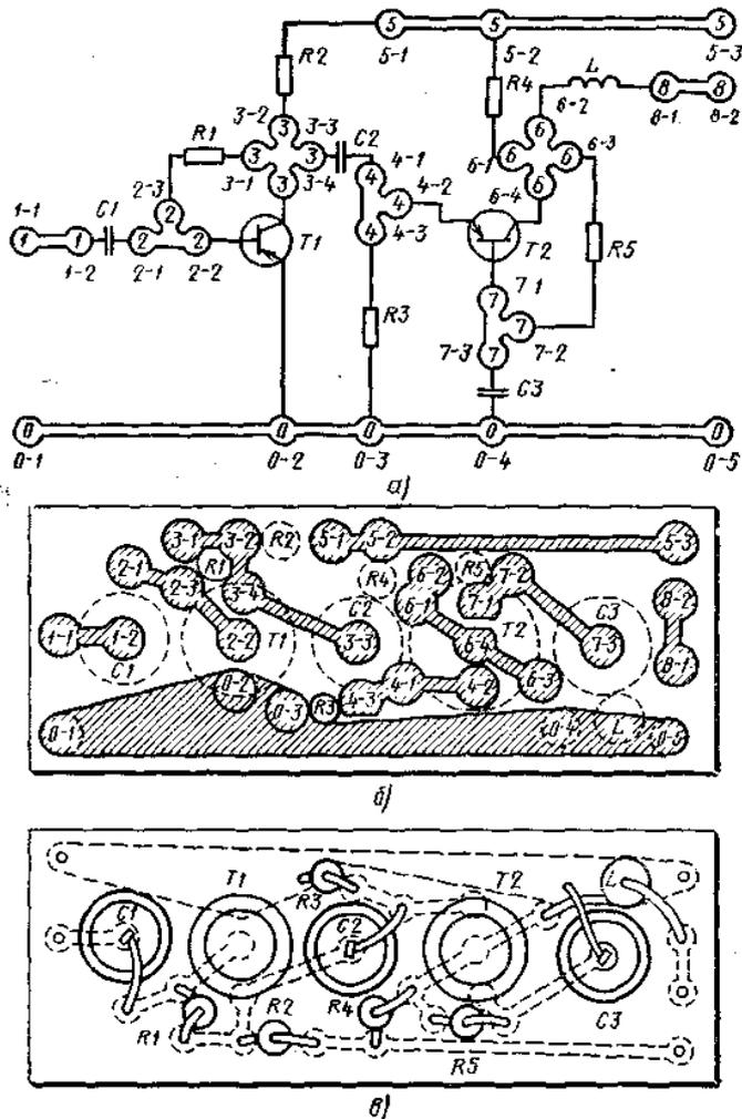
Рис. 39. Последовательное преобразование принципиальной схемы (а) в монтажную на печатной плате, вид платы со стороны печатных дорожек (б) и деталей (е)
