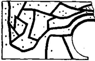
Рис. 21. Вид печатной платы при механическом удалении фольги
