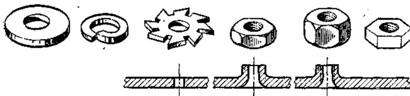
**Рис. 49. Виды шайб и гаек (шайба нормальная, шайба Гровера, звездчатая шайба, гайки точеные низкая и высокая, гайка штампованная); формирование резьбы в тонком материале (сверление, вытяжка материала в отверстие и нарезание резьбы)**
