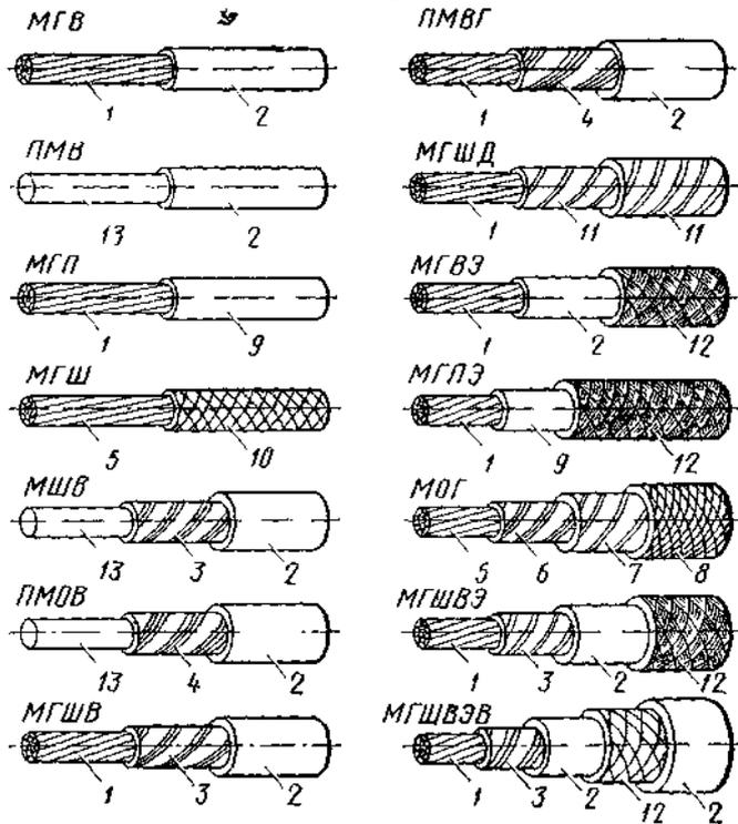
Рис. 2. Конструктивные схемы некоторых видов монтажных проводов:
