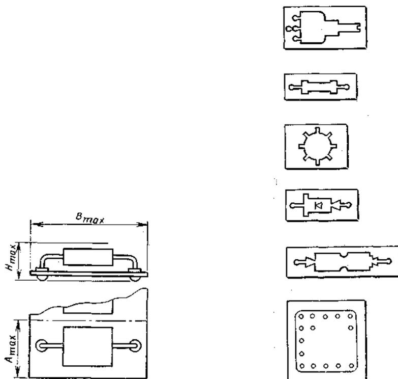
Рис. 36. К определению, установочных параметров элемента (для маломощных элементов, не требующих радиаторов для нормальной работы)
