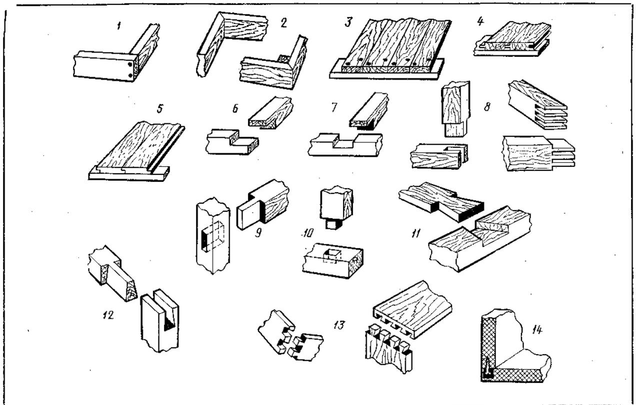
**Рис. 35. Виды соединения деревянных деталей**
