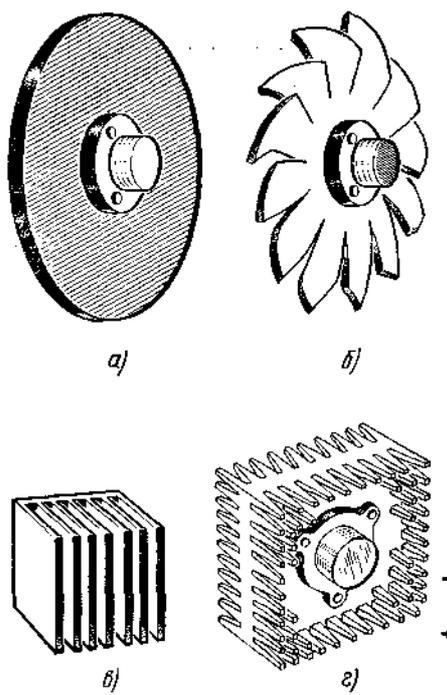
Рис. 46. Радиаторы для мощных полупроводниковых приборов
