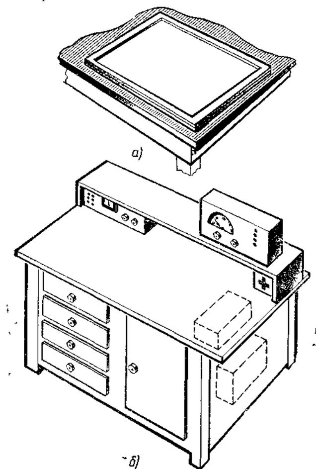
**Рис. 1. Простейшее съемное рабочее место радиолюбителя-конструктора (а) и рабочее место в виде специального стола (б)**
