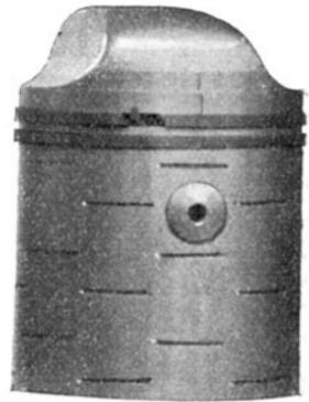
Abb. 129. Zweitaktkolben
