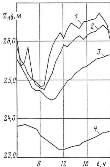
Рис. 6.1. Изменения режима уровней воды по длине нижнего бьефа: 1 — створ ГЭС; 2 — 5 км от ГЭС; 3 — 24 км от ГЭС; 4 — 62 км от ГЭС
