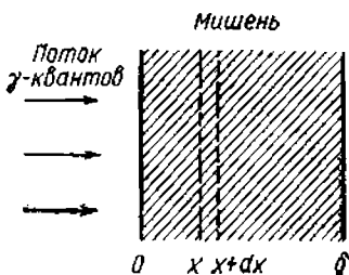
Рис. 5.4. Поток \gamma -квантов, падающих на плоскую мишень
