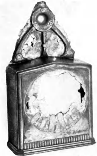
Abb. 239. Uhrengehäuse aus Zamak 5. (Nach Dornauf.)
