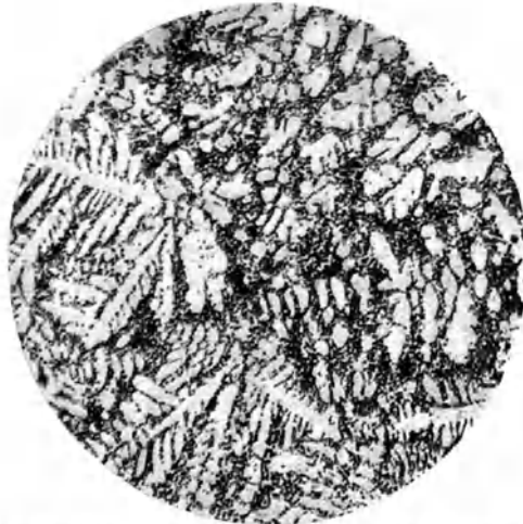
Abb. 169. Gefügebild eines normal gegossenen Sandgußstückes. Vergr. 200.
