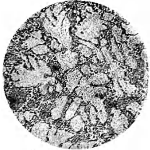
Abb. 9. Zinklegierung mit 4% Al, gealtert. Vergr. 200.
