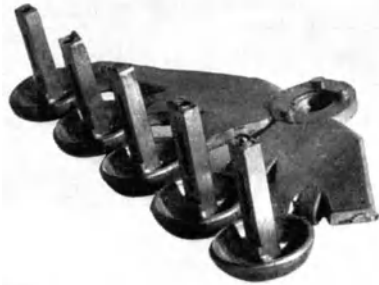
Abb. 240. Heftmaschinenteile aus Zamak 3. (Nach Dornauf.)
