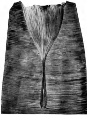
Abb. 284. Trichterbildung beim Pressen.
