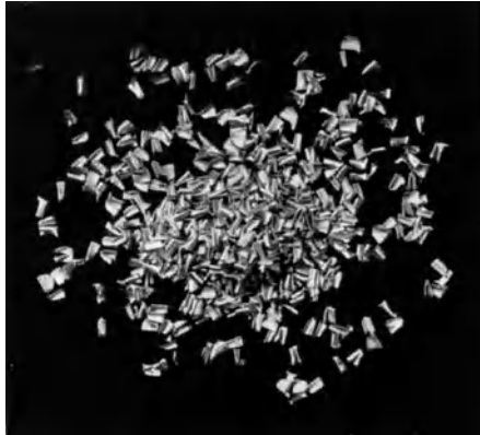
Abb. 369. Span einer Zinklegierung mit 4% Cu + 3% Pb.
