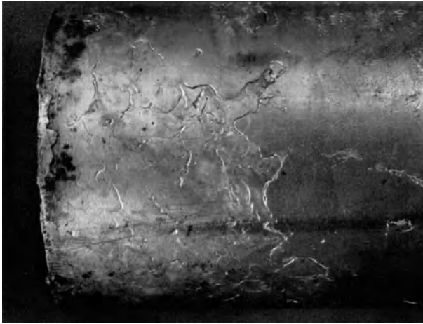
Abb. 146. Preßbolzen mit Oberflächenfehlern (Perlen, Falten). Vergr. \frac{1}{3} .
