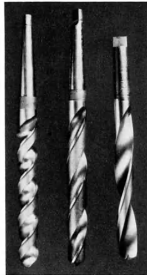
Abb. 394. Verschiedene Spiralbohrer. I Al, II Stahl, III Ms.
