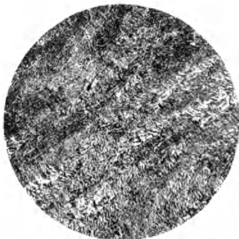
Abb. 51. Zinklegierung mit 7% Al und 4% Cu. Ternäres Eutektikum. Vergr. 200.
