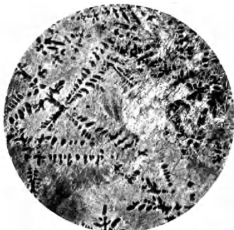
Abb. 53. Zinklegierung mit 7% Al und 1% Cu. \beta + Eutektikum ( \alpha + \beta ). Vergr. 200.
