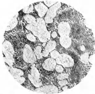
Abb. 137. Gefügebild der Kernzone desselben Preßbolzens. Vergr. 200.
