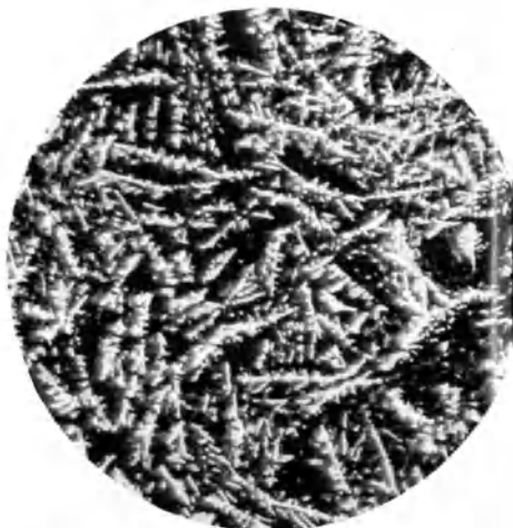
Abb. 54. Zinklegierung mit 1% Al und 6% Cu. \epsilon -Phase, Peritektikum ( \epsilon + \alpha ), ternäres Eutektikum. Vergr. 200.
