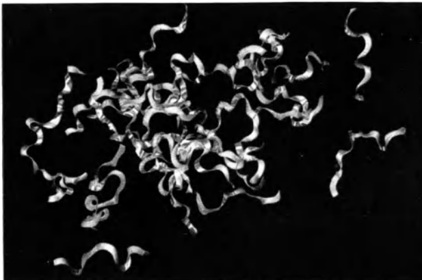
Abb. 359. Span einer Zinklegierung mit 4% Al, 2,7% Cu, 0,02% Mg.
