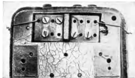
Abb. 18b. Grundplatte mit elektr. Kontakten.
