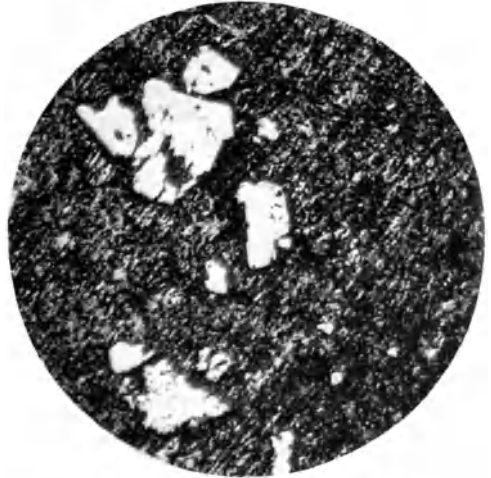
Abb. 203. Gefügebild einer breiig verspritzten Zinklegierung mit 4 % Al, 0,7 % Cu und 0,03 % Mg. Vergr. 200.
