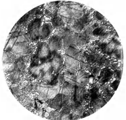
Abb. 180. Badtemperatur 450°, Formtemperatur 400°. Vergr. 200.
