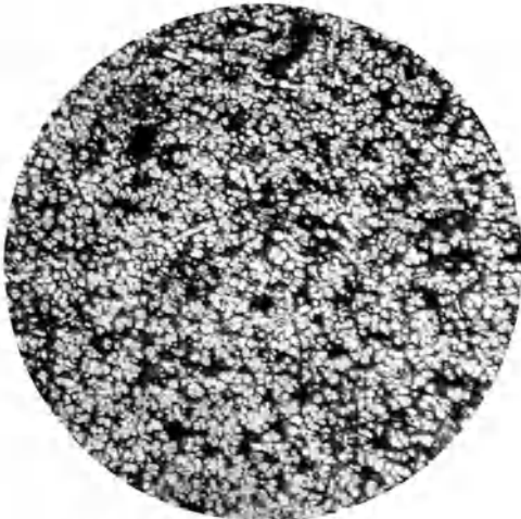
Abb. 202. Gefügebild von normalem Spritzguß einer Zinklegierung mit 4 % Al, 0,7 % Cu und 0,03 % Mg. Vergr. 200.
