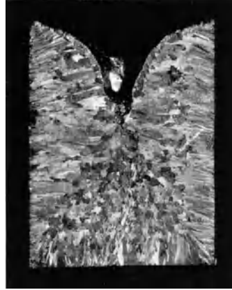
Abb. 135. Drei Erstarrungszonen in einem Block. (Nach Scheil.)
