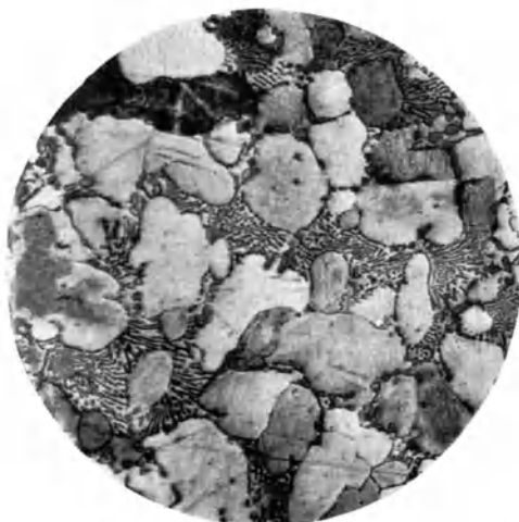
Abb. 181. Badtemperatur 450°, Formtemperatur 300°. Vergr. 200.
