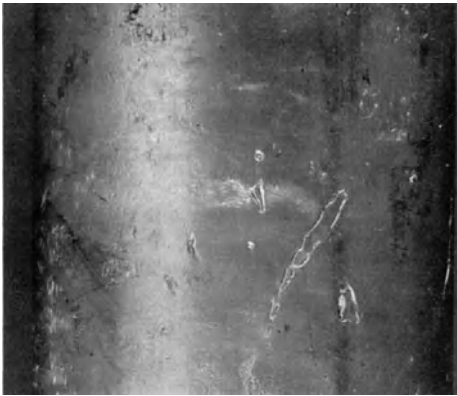
Abb. 143. „Spritzer“ an der Oberfläche eines Preßknüppels. Vergr. \frac{1}{2} .
