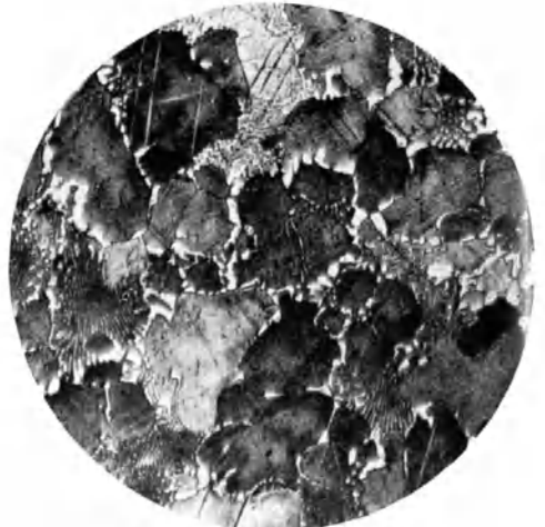
Abb. 178. Badtemperatur 500°, Formtemperatur 300°. Vergr. 200.
