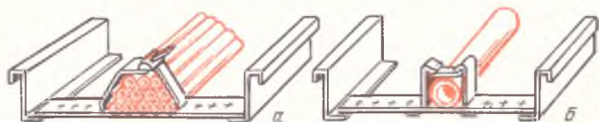
Рис. 95. Крепление кабелей и проводов: а — зубчатой полоской-пружиной У650-У651; б — полоской К403-К405 и пружинкой К70-К72.
