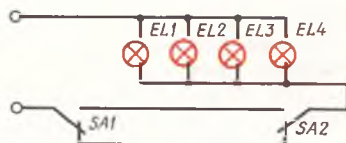
Рис. 7. Схема управления лампами накаливания из двух мест при помощи переключателей.
