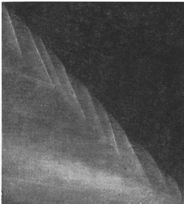
Рис. 51. Поперечная развертка детонации в плоском канале; ширина щели 55 мм.
