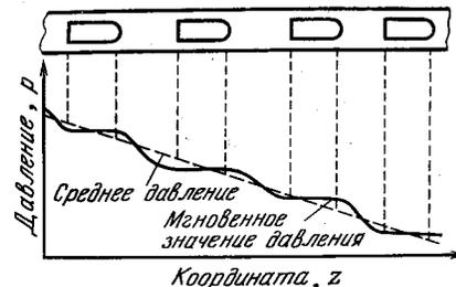
Рис. 5.2. Мгновенное распределение давления вдоль канала при снарядном течении [5]
