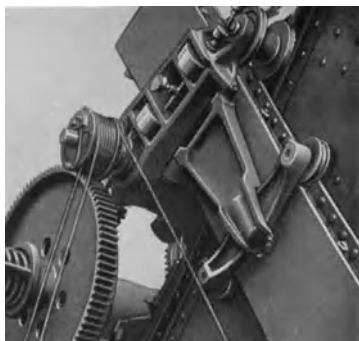
Abb. 193. Führung der Löffelstiele bei den älteren Baggern von Menck & Hambrock.
