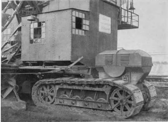
Abb. 327. Eimerketten-Raupenbagger (LMG) mit fest gelagerten Stützrollen.
