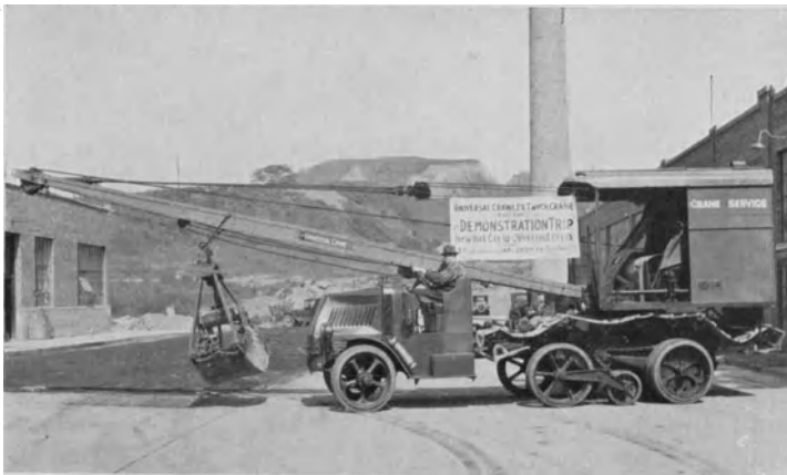
Abb. 597. Auto-Universalbagger auf der Straße fahrend (Raupenketten über den Rädern auf Haltebügeln hängend).
