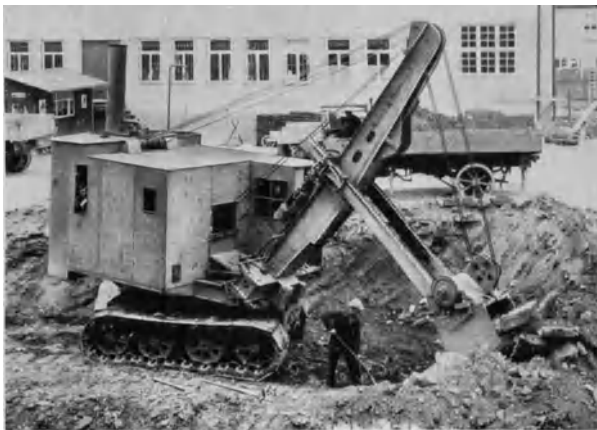
Abb. 80. 1 m 3 -Dampflöffelbagger auf Raupen (Menck & Hambrock).
