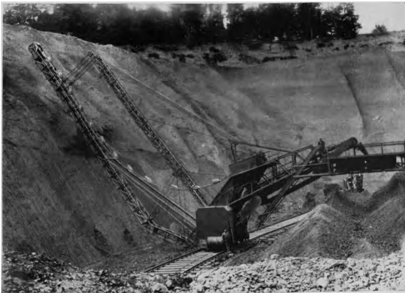
Abb. 390. 1001-Ton- und Kiesbagger, Type E III, mit elektr. Antrieb, eingebauten Blechbrückentransporteur und Tonmischer.
