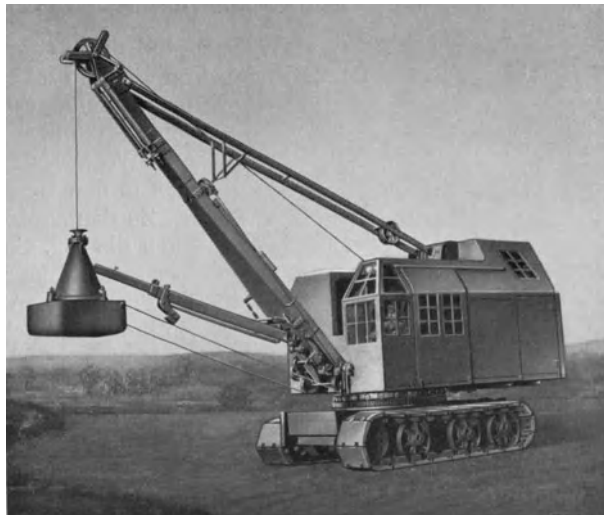
Abb. 672. Stampfer mit automatischer Hub- und Fallbewegung (Weserhütte).
