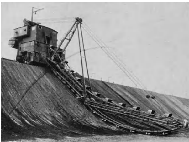
Abb. 270. Doppeltorbagger (Buckau) mit halbgeführter Eimerkette.
