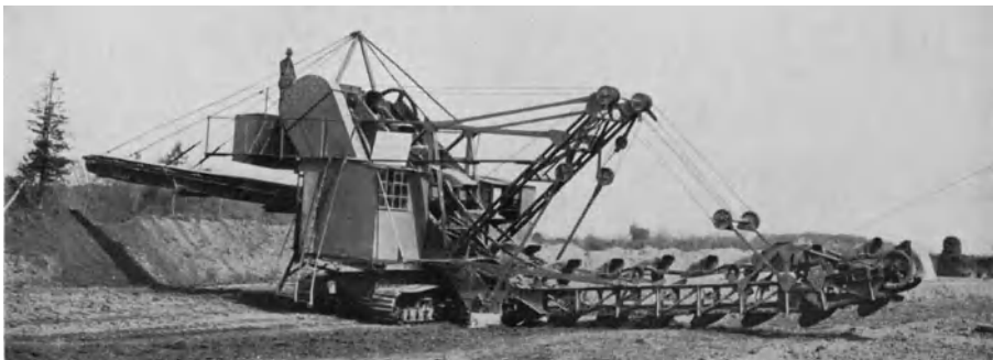
Abb. 879. 70 l-Raupen-Eimerkettenbagger mit Rohölantrieb beim Mutterbodenabhub.
