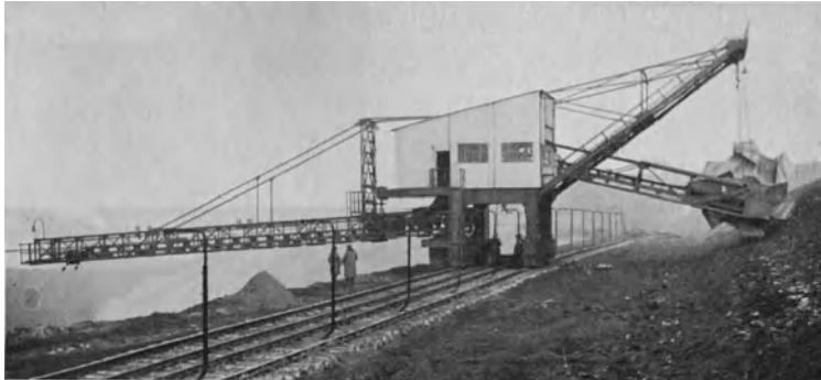
Abb. 727. Schaufelrad-Band-Absetzer auf Grube Kraft II.
