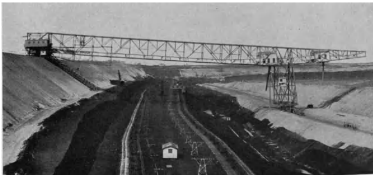
Abb. 787. Haldenseitige Abstützung einer Förderbrücke auf einer besonderen Berme (Mitteldeutsche Stahlwerke A. G.).
