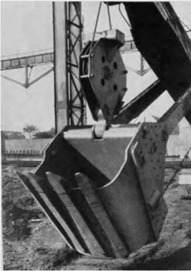
Abb. 197. Völlig geschweißter Löffel ohne Schneidmesser mit langen Zähnen (Demag).
