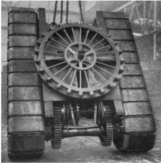
Abb. 127. Älterer Unterwagen mit Rollenkranz für die Auflagerung des Oberwagens (Demag).
