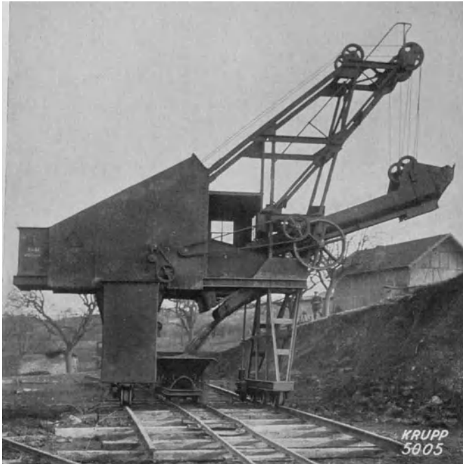
Abb. 536. Schaufelrinnenbagger für elektrischen Antrieb mit einer Stundenleistung von 30 m 3 in einer Tongrube arbeitend. Größte Abtragshöhe 8 m.
