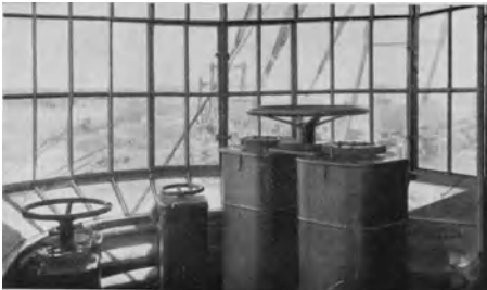
Abb. 368. Innenansicht des Führerstandes mit Aussicht auf die Eimerleiterseite (Buckau).
