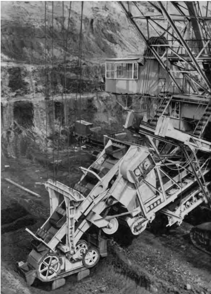
Abb. 439. 2501-Schaufler-Eimerbagger für Kohle und Zwischenmittel (Buckau).
