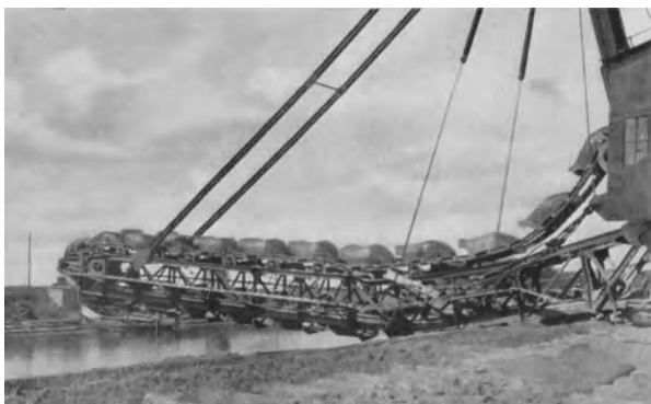
Abb. 834. Eimerleiter des Doppeltorbaggers der Abb. 833. Siehe die Lochung der aus dem Wasser greifenden Eimer.
