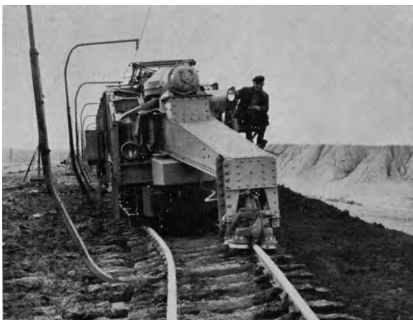
Abb. 663a. Elektrisch angetriebener Lauchhammerpflug mit Gleisrückausleger beim Gleisrücken.
