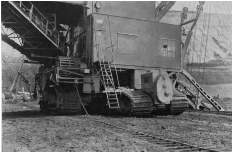
Abb. 356. Raupenbagger, Type R VIII der LMG mit Stromzuführung durch Kabel.
