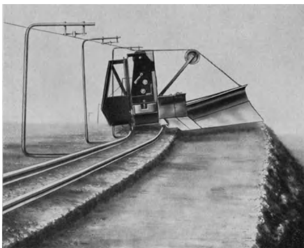
Abb. 659. Arbeitsweise eines Planierpflugs beim Planieren.
