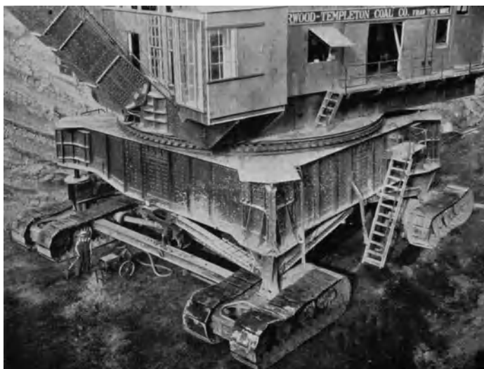
Abb. 640. Unterwagen des Großbaggers: „Bucyrus-Erie 750-B“ mit Dreipunktstützung.
