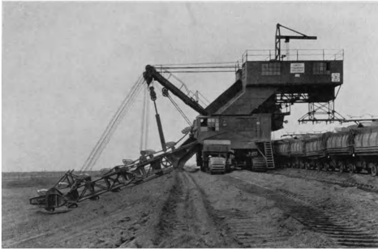
Abb. 395. 300 l-Raupenbagger, Type R IIIs (LMG).
