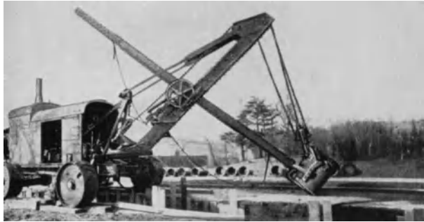
Abb. 504. Amerikanische Eisenbahnlöffelbagger auf Straßenrädern als Grabenbagger. Verlängerte Löffelstiele und absenkbarer Ausleger.
