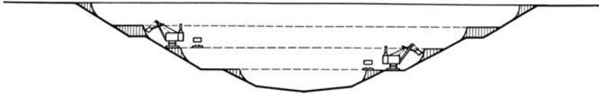
Abb. 447. Kanalbaggerung mit Löffelbaggern.
