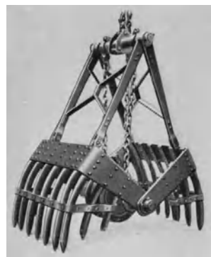
Abb. 28. Greifkorb für Felsboden, ältere Ausführung (Bünger).
