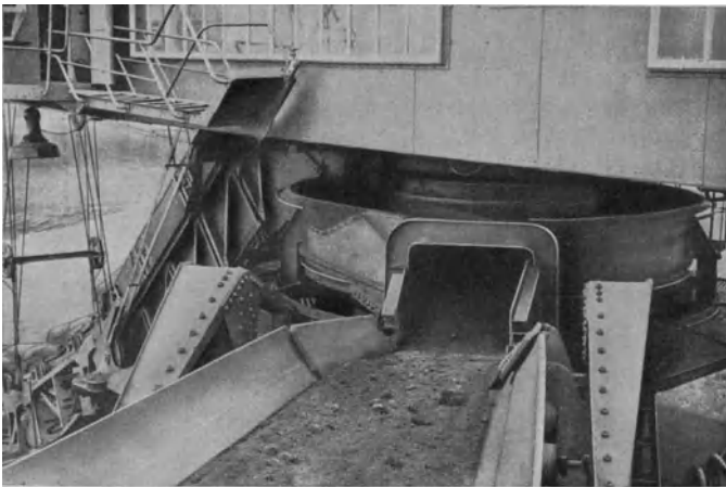
Abb. 419. Übergabestelle vom Drehteller zum Auslegerband (Buckau).
