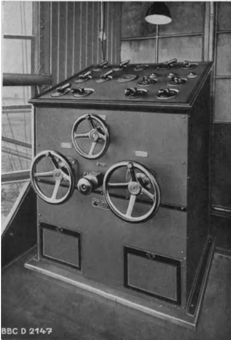
Abb. 376. Linker Führerstand mit Steuerpult des Raupenkettensbaggers, Bau 588 LMG. (Aus Brown-Boveri Nachrichten.)
