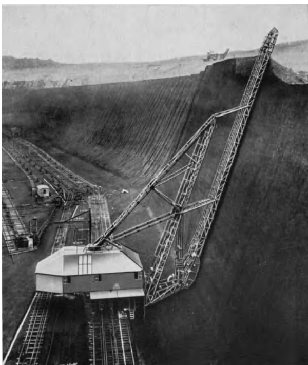
Abb. 586. Kratzbagger für Braunkohlegewinnung.
