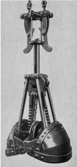
Abb. 36. Einkettengreifer für Brunnenbau-Arbeiten der Maschinen- und Kranbau A. G. (Mukag, Düsseldorf).
