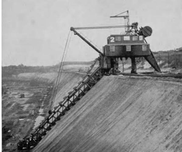
Abb. 401. Eintorbagger, Type E II, mit elektr. Antrieb, als Tiefbagger arbeitend (LMG).
