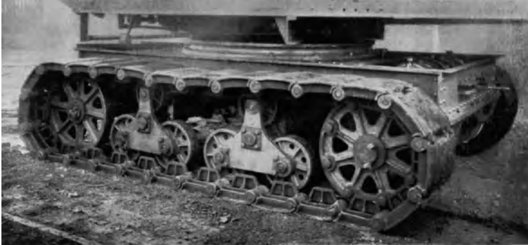
Abb. 102. Abstützung des Raupenbandes auf kleinen, in Schwingen gelagerten Laufrollen (Mukag).
