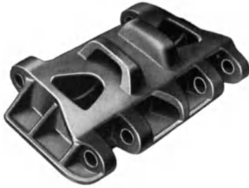
Abb. 104. Kastenraupenglied mit austauschbaren Verschleißbüchsen (Weserhütte)
