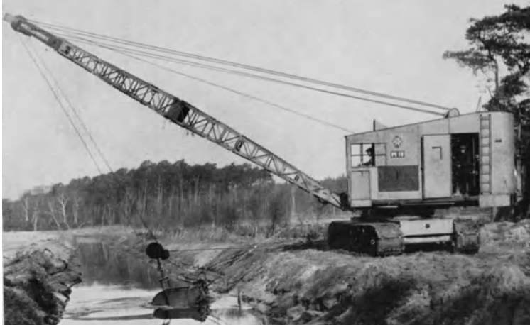
Abb. 512. Eimerseilbagger (Menck & Hambrock).
