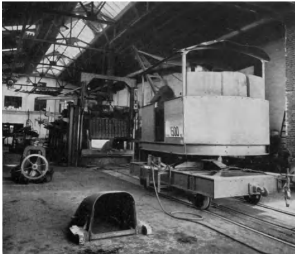
Abb. 286. Anwärmen der Eimer zum Richten im Glühofen. Grube Clara in Welzow.
