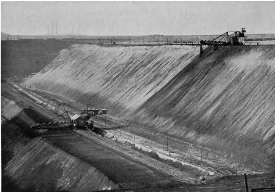
Abb. 705. Zwei Buckauer Absetzer in Strossen übereinander arbeitend.
