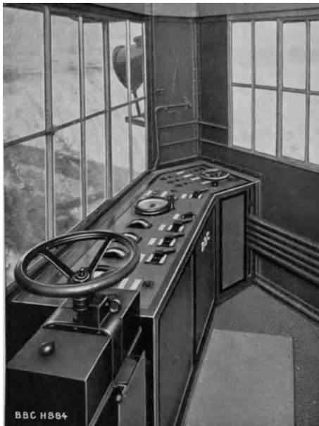
Abb. 818. Führerstand des Hochbaggers nach dem Umbau (Brücke „Roberts Hoffnung“). (BBC-Nachrichten.)
