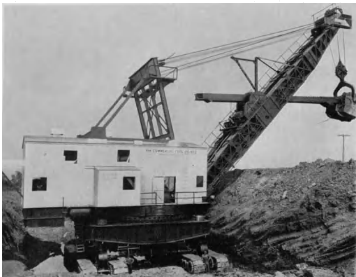
Abb. 639. Großlöffelbagger der Marion Steam Shovel Co im Abraumbetrieb eines Steinkohlentagebaues.
