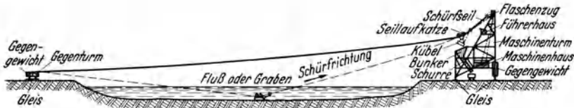
Abb. 779. Parallel verfahrbarer Kabelbagger (Bleichert).
