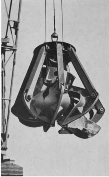
Abb. 34. Demag-Polypgreifer bei der Arbeit (man beachte, daß einzelne Schalen infolge von dazwischen geklemmten Steinen geöffnet sind, die übrigen Schalen sind dagegen geschlossen (Demag-Polypgreifer, G. m. b. H.).
