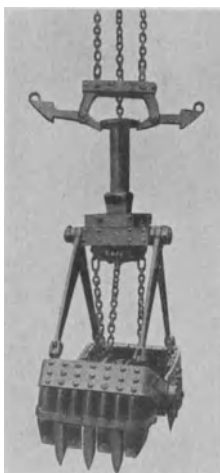
Abb. 19. Einkettengreifer mit Fanghaken. a untere Rast, b obere Rast (Bünger A. G.).
