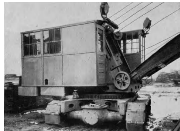
Abb. 619. Raupenlöffelbagger mit Differentialgetriebe zur Kurvenfahrt (Link-Belt Co.).
