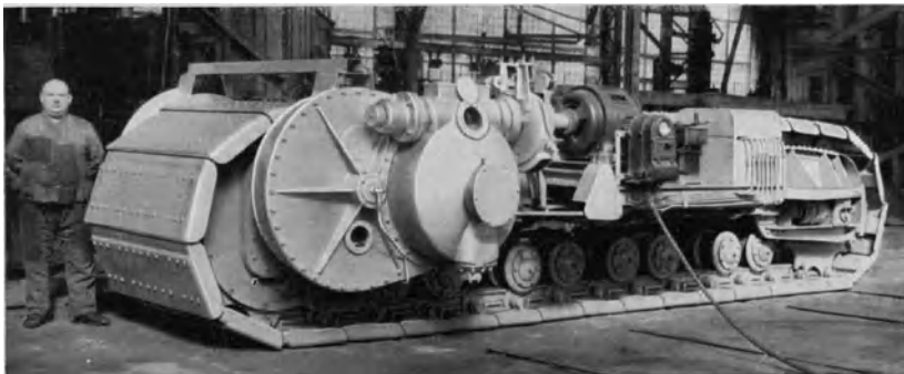
Abb. 328. Eimerketten-Raupenbagger (Buckau). Raupenbandbreite 1600 mm. Ansicht eines Raupendrehgestells (s. auch Abb. 323).
