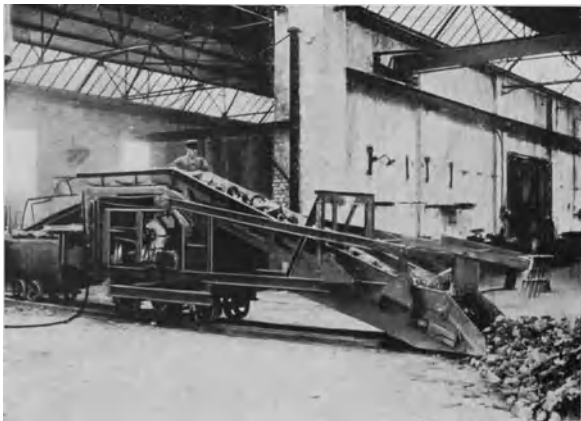
Abb. 565. Stollenlademaschine (Flottmann A. G., Herne).
