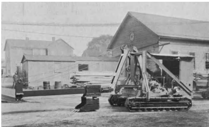
Abb. 600. Amerikanischer Planierbagger („Skimmer“) von Byers. — Maschinenplattform fest, nur Ausleger um etwa 180° schwenkbar.
