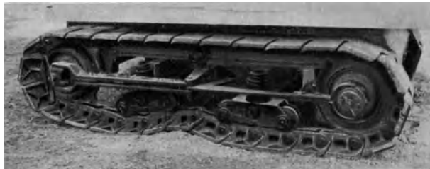
Abb. 103. Raupenfahrwerk mit Abstützung durch kleine, gefedert gelagerte Tragrollen (Orenstein & Koppel).
