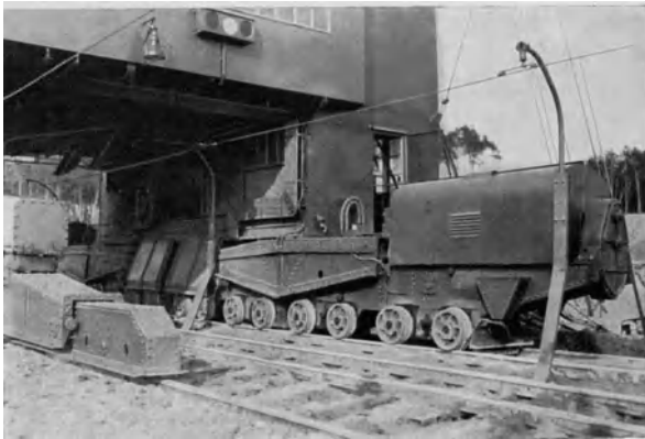
Abb. 307. Achtachsiges Drehgestell (LMG).
