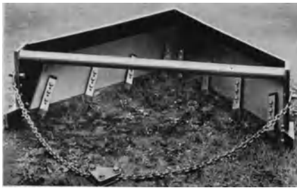
Abb. 547. Schrapperkübel mit Reißzähnen (C. Schenck, Darmstadt).
