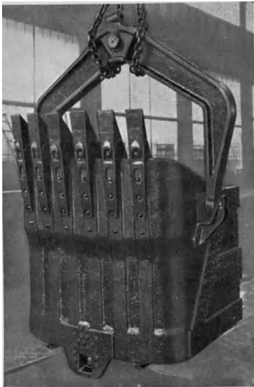
Abb. 643. Löffel (9 m 3 Inhalt) mit Vorderwand und Aufhängebügel aus Manganstahl.
