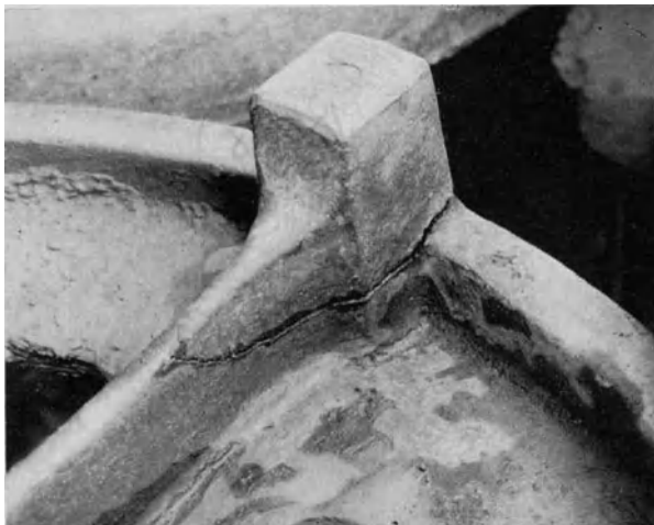
Abb. 99. Risse an dem Nocken einer Turasscheibe.
