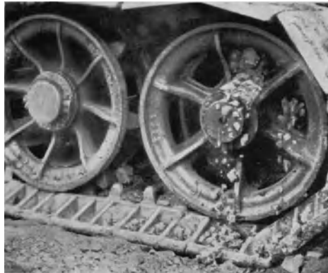
Abb. 612. Antriebsscheibe und Tragrolle mit Durchbrechung der Radkränze zur Selbstreinigung beim Fahren (Thew).
