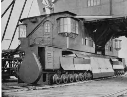
Abb. 369. Führer- und Klappenschlägerstände (Buckauer Doppelschütter) von der Portalseite aus gesehen. Links Führer-, rechts Klappenschlägerstand, im Hintergrund der zweite Klappenschlägerstand (derselbe Bagger wie in Abb. 368).
