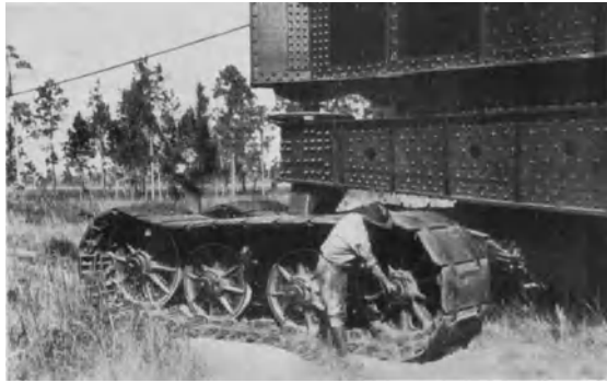
Abb. 635. Doppelraupe eines Bucyrus-Großbaggers mit Schwinghebel für Dreipunktstützung.
