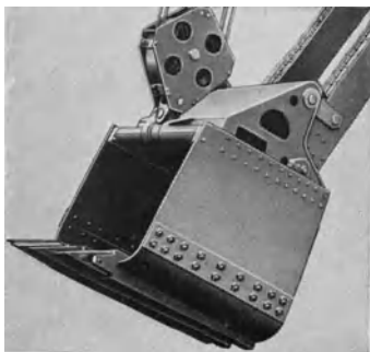
Abb. 196. Genieteter Löffel mit Stahlguß-Vorder- und -Rückwand, langen Zähnen und auswechselbaren selbstschärfenden Spitzen (Menck & Hambrock).
