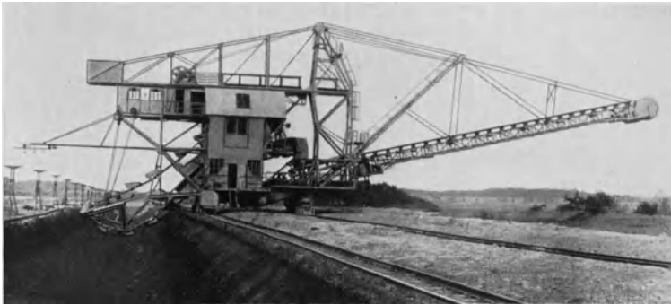
Abb. 739. Schwenk-Absetzer (Krupp) beim Schütten einer Halde am Mittellandkanal.
