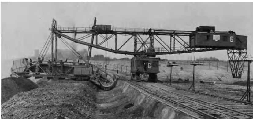
Abb. 715. Absetzapparat mit heb-, senk- und schwenkbarer Leiter (LMG).
