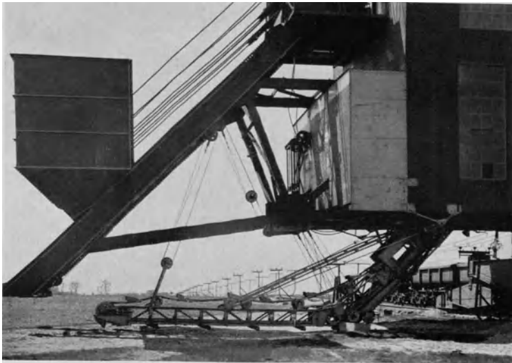
Abb. 404. Großtorbagger der LMG. Rückseite mit Planier-Eimerkette.
