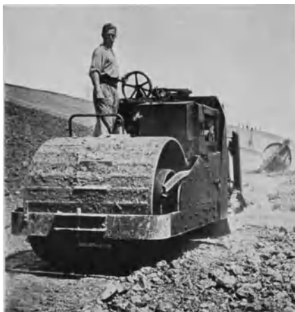
Abb. 678. Tandemwalze mit Querrippen (Orenstein & Koppel).
