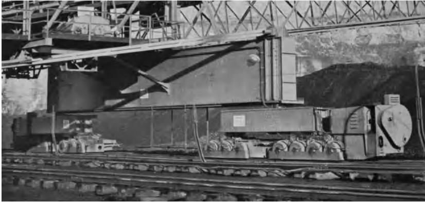
Abb. 803. Das Fahrwerk einer Stütze der Förderbrücke auf Grube „Zukunft“.
