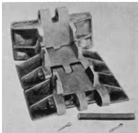
Abb. 610. Stahlguß-Raupenglieder mit Versteifungsrippen (Osgood).
