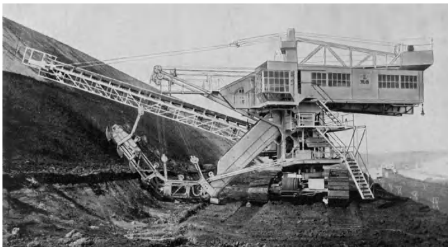
Abb. 416. Raupenschwenkbagger mit schwenkbarem Boden-Transportband (LMG).
