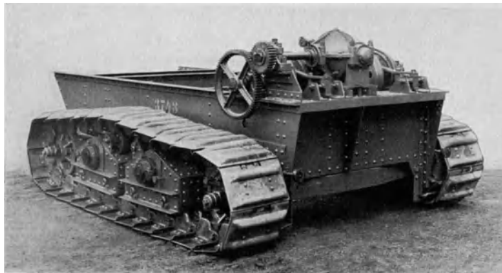
Abb. 324. Unterwagen eines Raupenbaggers (Type R I der LMG).
