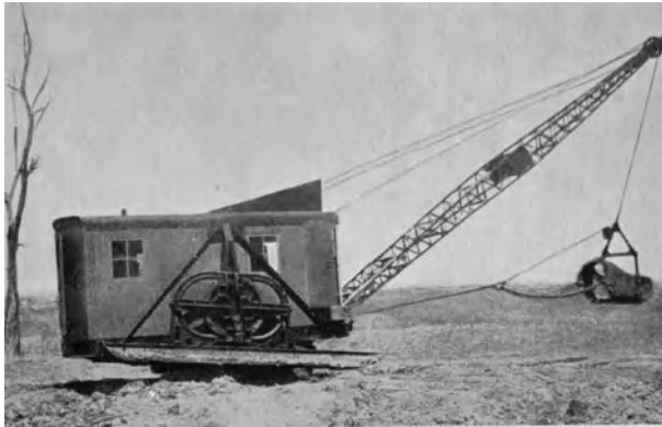
Abb. 648. Schreitbewegung eines Monighan-Eimerseilbaggers.
