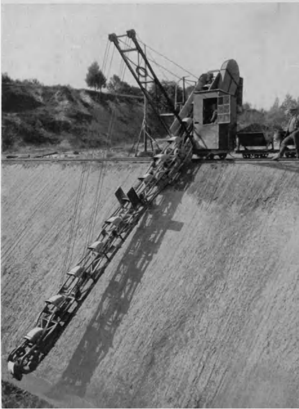
Abb. 382. 141-Seitenschütter, Type O (Orenstein & Koppel).
