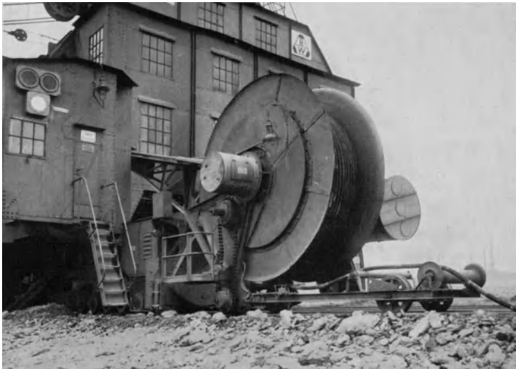
Abb. 477. Buckauer Abraumbagger mit Stromzuführung über ein 1300 m langes Kabel bei 6000 Volt Drehstrom (Bischoff & Hensel, Mannheim).
