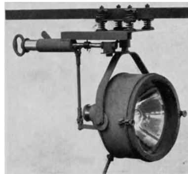
Abb. 151. Beleuchtungskörper mit federnder Aufhängung für Löffelbagger (SSW.).
