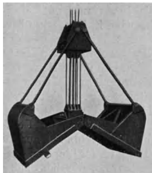
Abb. 25. Greifkorb für gewachsenen Sand und Kies (Bünger).
