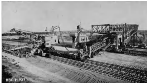
Abb. 816. Abraufförderanlage der Brücke „Roberts Hoffnung“ mit einem Tief- und einem Hochbagger (BBC-Nachrichten).
