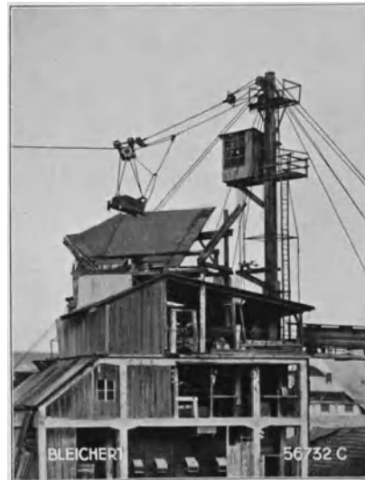
Abb. 748. Kabelbagger für Sand- und Kiesgewinnung. Hauptmast mit Führerhaus, Hubflaschenzug für das Trageil und Entleerungsanschlag auf dem Trageil (A. Bleichert, Leipzig).
