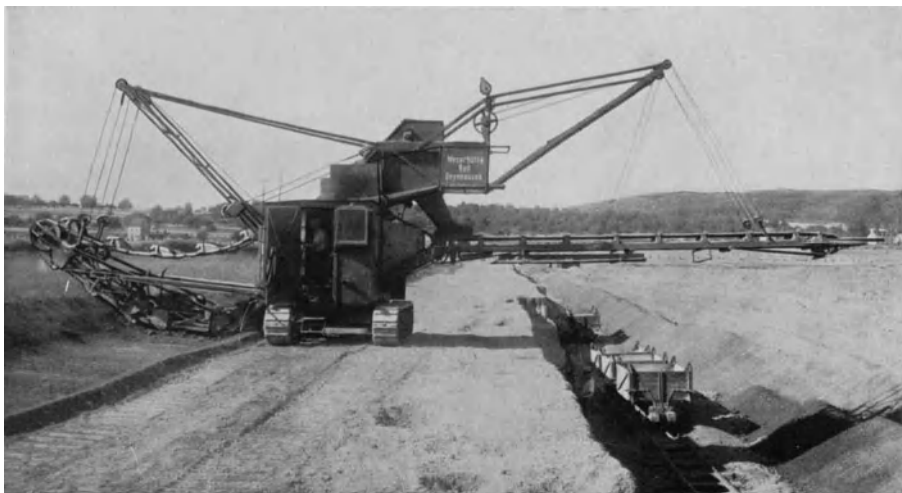
Abb. 399. Raupenbagger, Type ER I, mit Dieselantrieb und angebautem Gurtförderer (Weserhütte).
