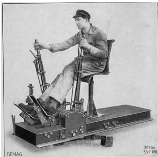
Abb. 139. Steuerbock mit Steuerhebeln und Führersitz (Demag).
