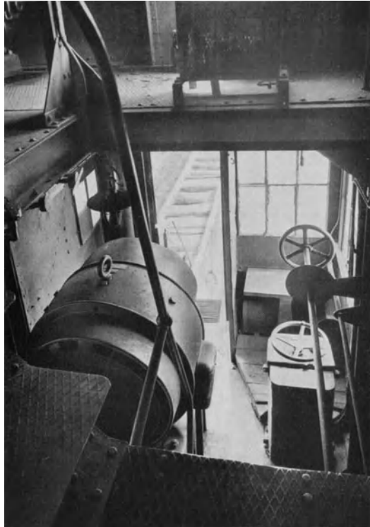
Abb. 363. Hauptantriebsmotor eines älteren mit Drehstrom betriebenen Baggers.
