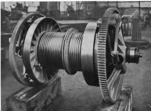
Abb. 507. Einachsiges Trommelwindwerk eines Universalbaggers (Demag).
