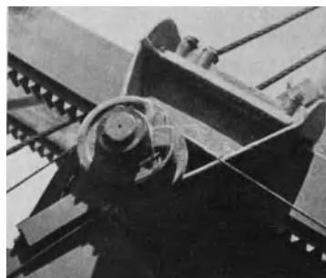
Abb. 194. Führung der Löffelstiele bei den neueren Baggern von Menck & Hambrock.
